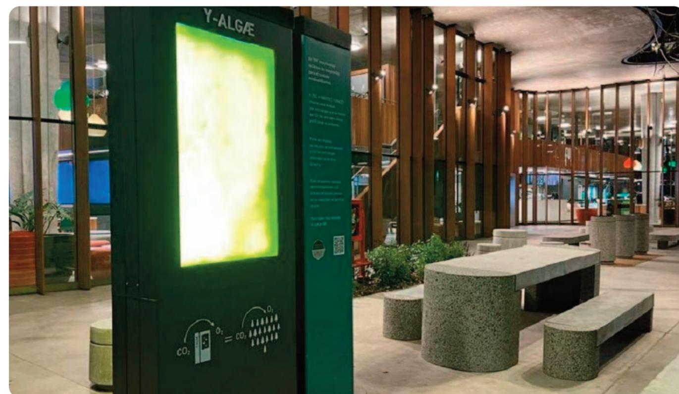
El dispositivo está diseñado para operar utilizando agua de lluvia colectada desde los techos de la estación de servicio. Una vez sembrado con las algas y luego de haber crecido, las células se separan, y la mayor parte del agua puede reutilizarse como agua de riego, o eventualmente, se puede reciclar para comenzar un nuevo ciclo de cultivo.
