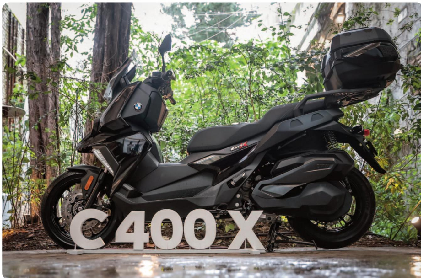
El C 400 X está equipado con un motor monocilíndrico que entrega 34 hp y 35 Nm de torque. La transmisión CVT y un brazo basculante de alta rigidez permiten una entrega de potencia eficiente y un manejo fluido. Incluye el sistema FlexCase, que permite ampliar el espacio de almacenamiento bajo el asiento.
