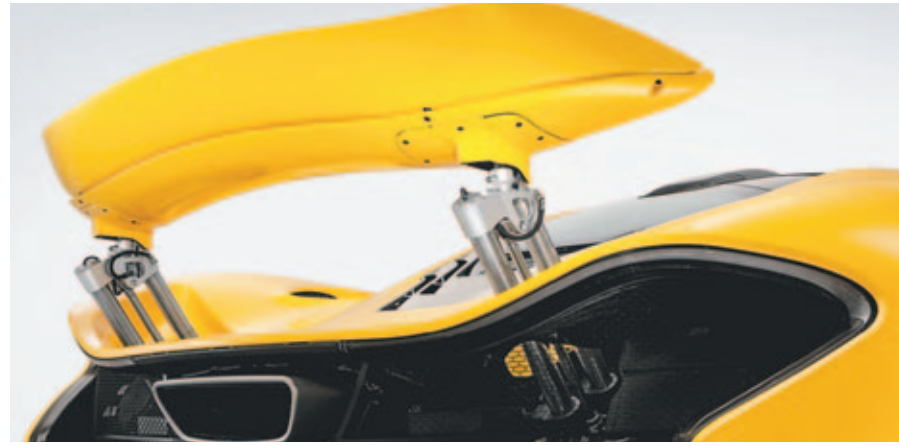
El alerón trasero activo, representan una gran ventaja para lograr el equilibrio aerodinámico, delantero y trasero- McLaren.
