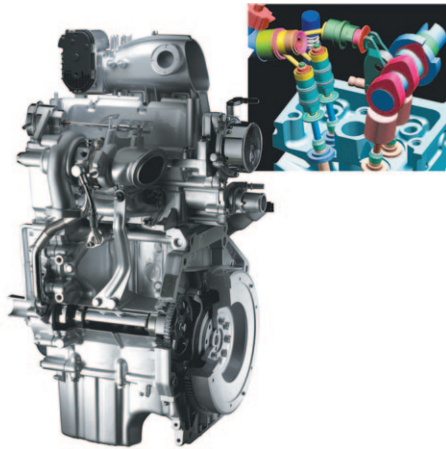
Motor TwinAir desarrollado por FIAT Powertrain Technologies que permite controlar el ingreso de mezcla a los cilindros sin usar la mariposa de aceleración.
