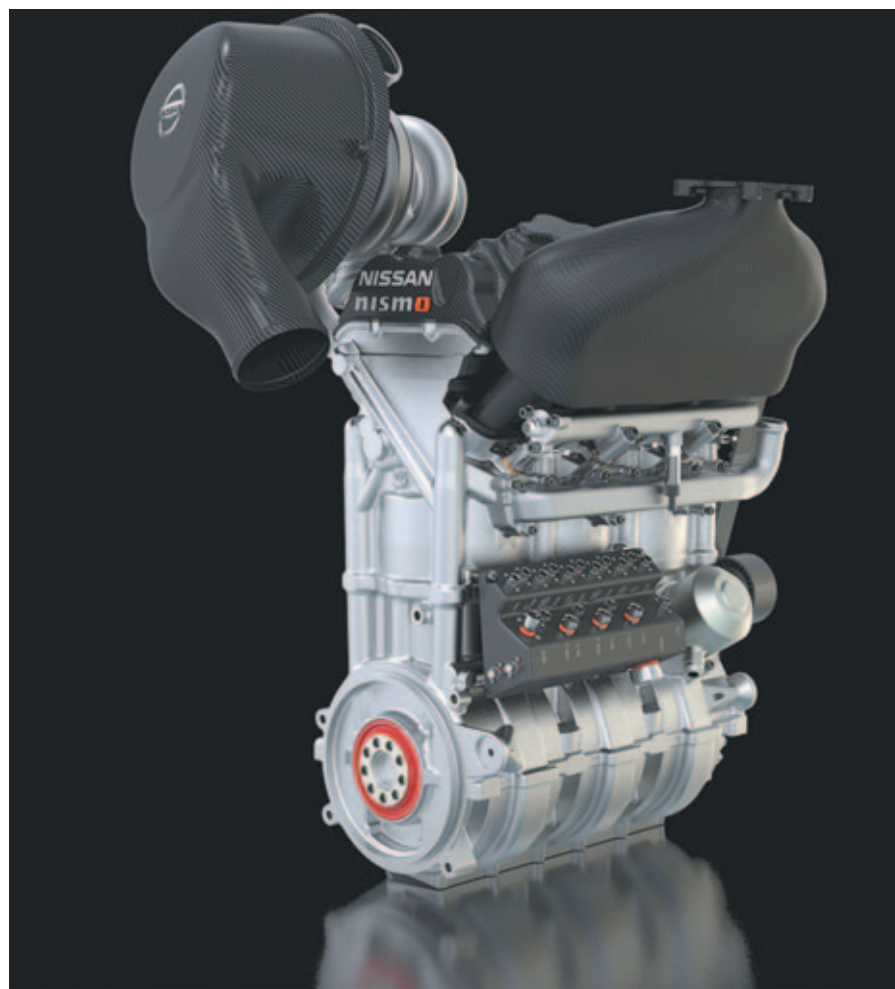
Motor de 3 cilindros de ciclo Otto, de buenas prestaciones, bajo consumo y reducidas emisiones contaminantes. - Nissan.
