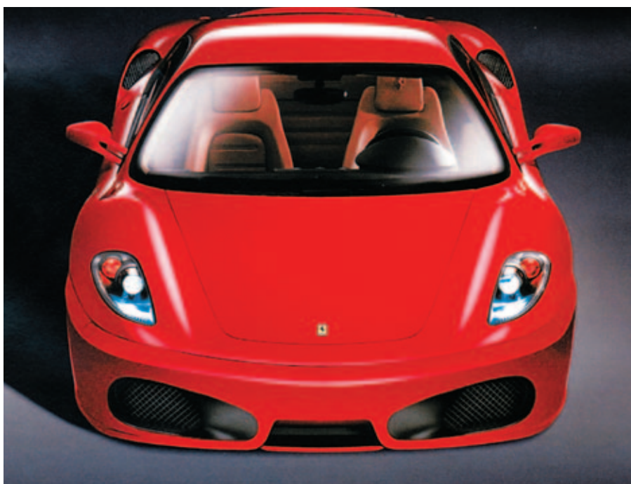
La Ferrari F430 nace como una evolución seria de la F360 Módena, con un motor V8 a 90 grados, de 4,3 litros de cilindrada y una potencia de 490 CV a 8.500 rpm.
