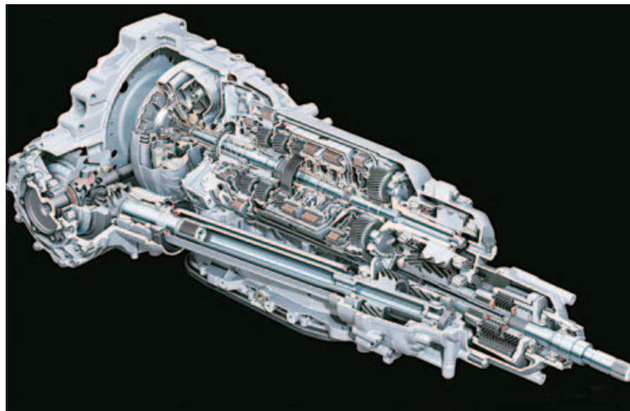
Caja automática en corte del Mercedes Benz S400 Hybrid
