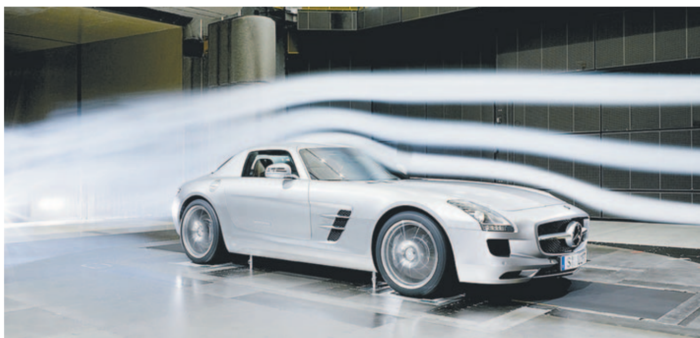
Ensayos aerodinámicos en túnel de viento del reciente modelo SLS AMG – Mercedes Benz.
