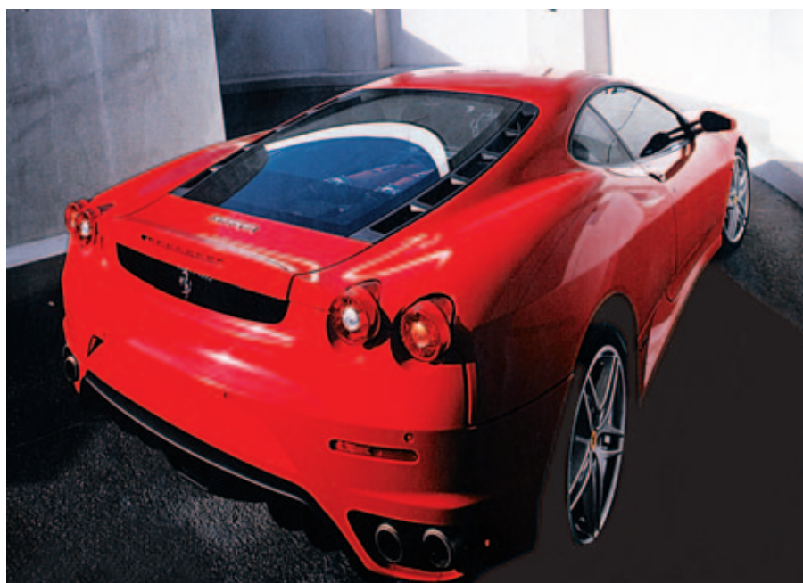
Respecto a la tecnología de la F430, su transmisión es a las ruedas traseras motrices, con caja mecánica de 6 velocidades desrobotizadas. Las suspensiones son por triángulos superpuestos con barra anti-rolido. El peso es de 1450 kg y la velocidad máxima es de 315 km/h.
