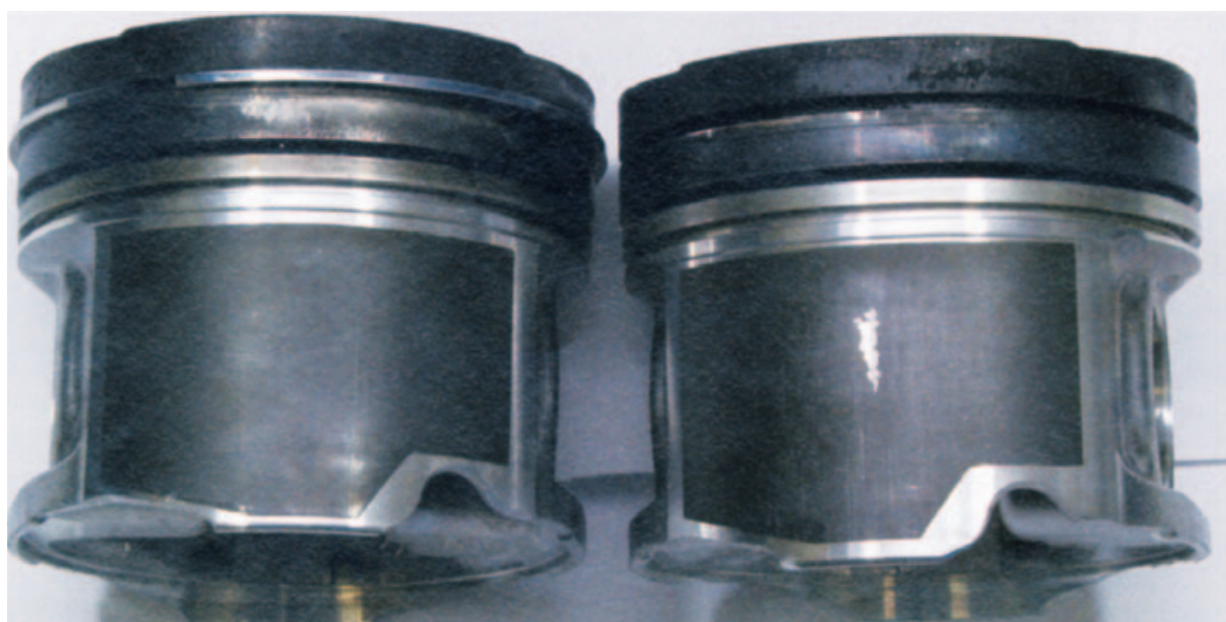
Ambos pistones muestran un desgaste diferente, por ejemplo en la falda o pollera: el de la izquierda está íntegro, incluyendo las ranuras de los aros de pistón que presentan pocos depósitos. Esto significa que la película lubricante permaneció estable.
