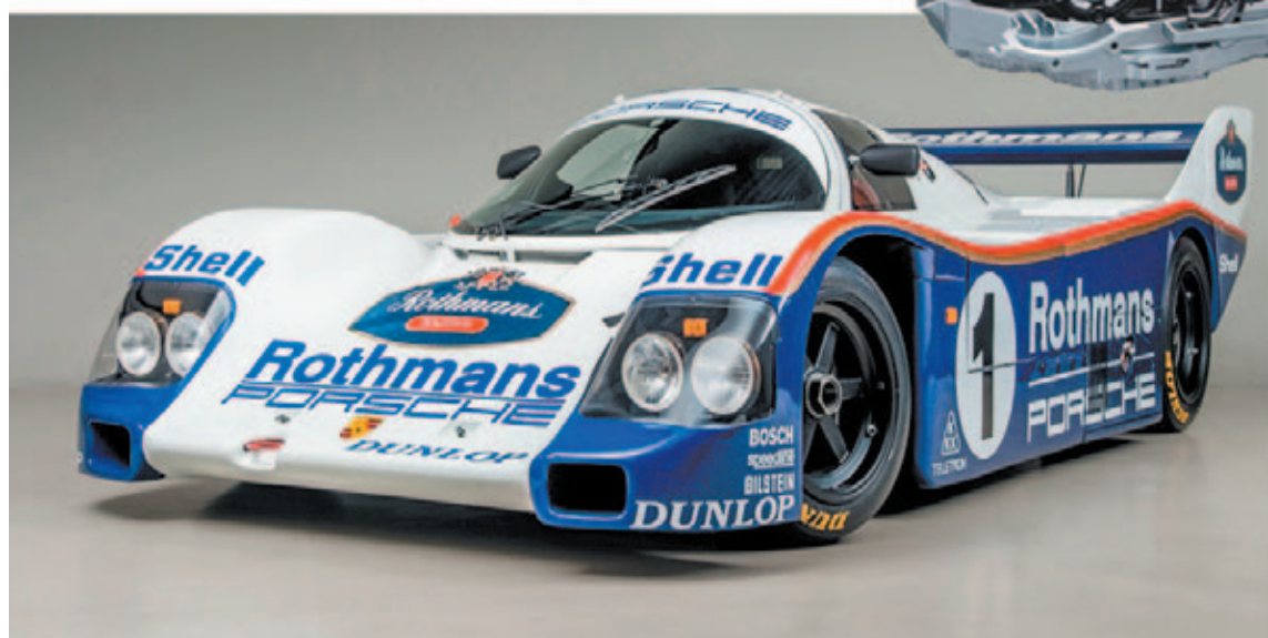
El Porsche 962 C. fue equipado a fines de la década del '90, con una transmisión PDK.de doble embrague robotizada.
