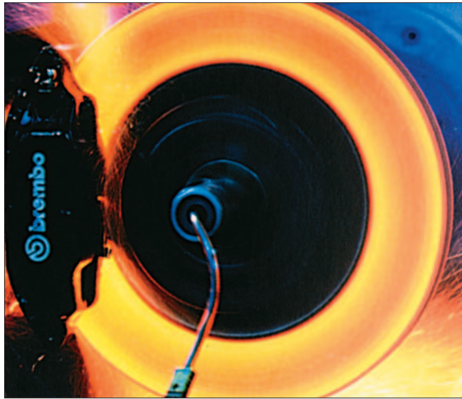
Ensayo de choque térmico en banco dinamométrico – Brembo.
