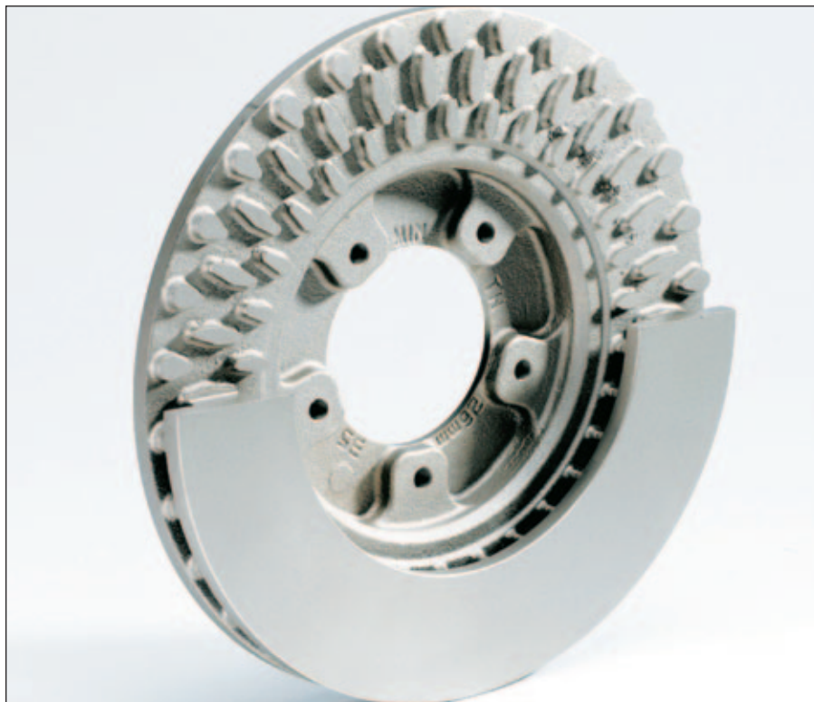
Cuando el calor disperso al frenar aumenta, las superficies de un disco sólido no alcanzan; debido a ello se usan los discos ventilados.
