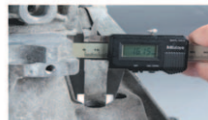
Fig. 2: Si el diámetro es menor de 21 mm, se deben ampliar los orificios con un taladro hasta que alcancen un mínimo de 21 mm y un máximo de 24 mm.
