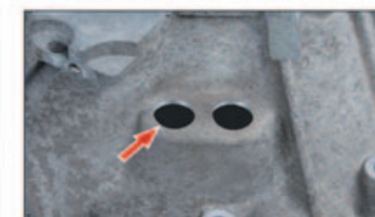
Fig. 6: Desbarbado y limpieza
