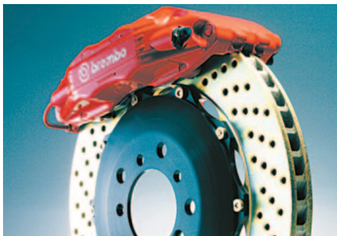
Los vehículos deportivos y de competición utilizan, desde hace un tiempo, discos de freno ventilados y perforados – Brembo.
