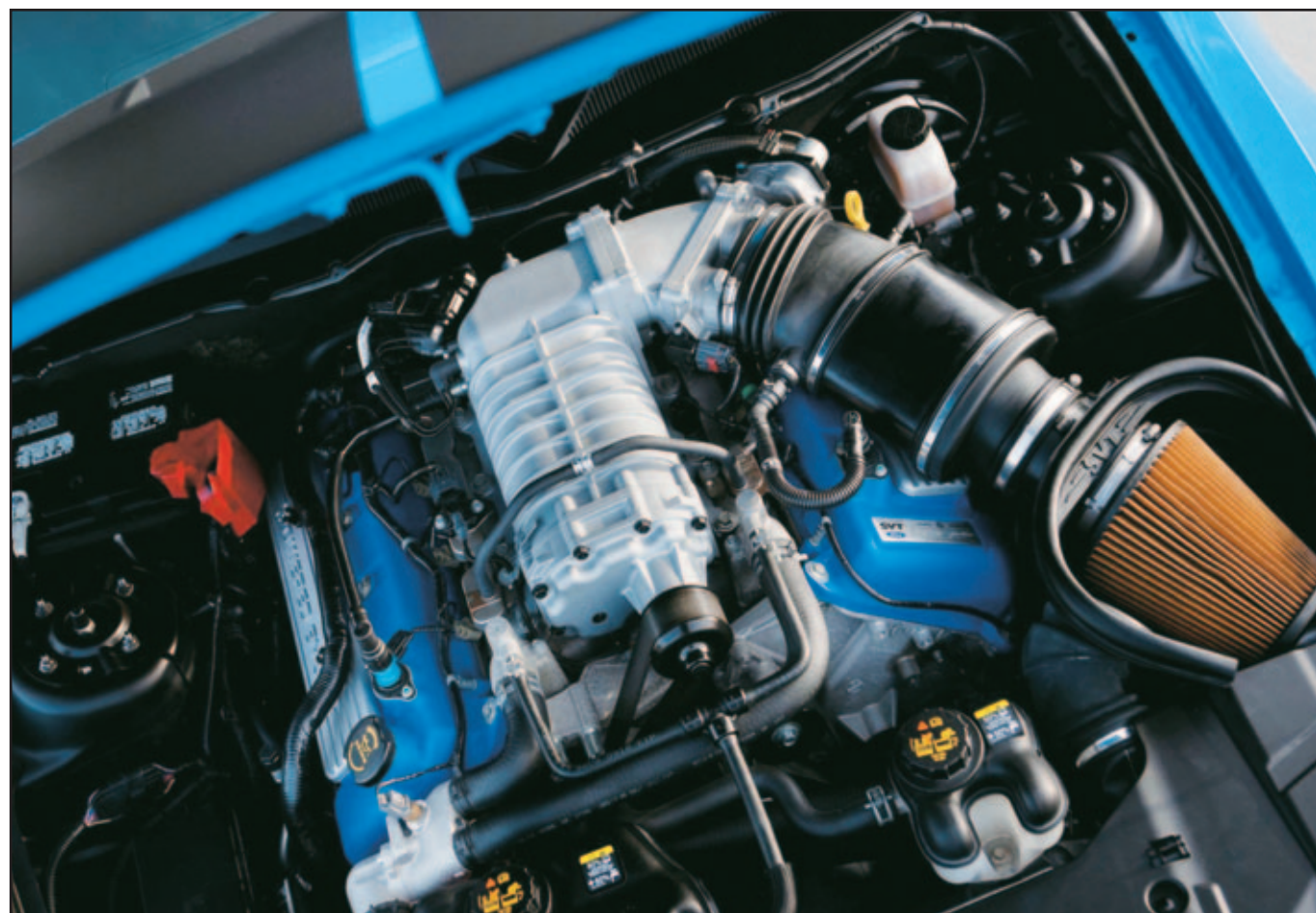
Motor en cofre V8 SVT con compresor volumétrico, del Ford Mustang Shelby GT 500.
