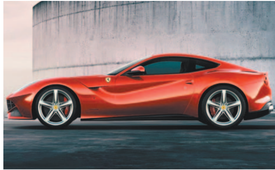
Lateral derecho de la F12, con 4,62m. de largo, 1,94m. de ancho y 1,27m. de altura. Este modelo posee un coeficiente aerodinámico de 0.30.
