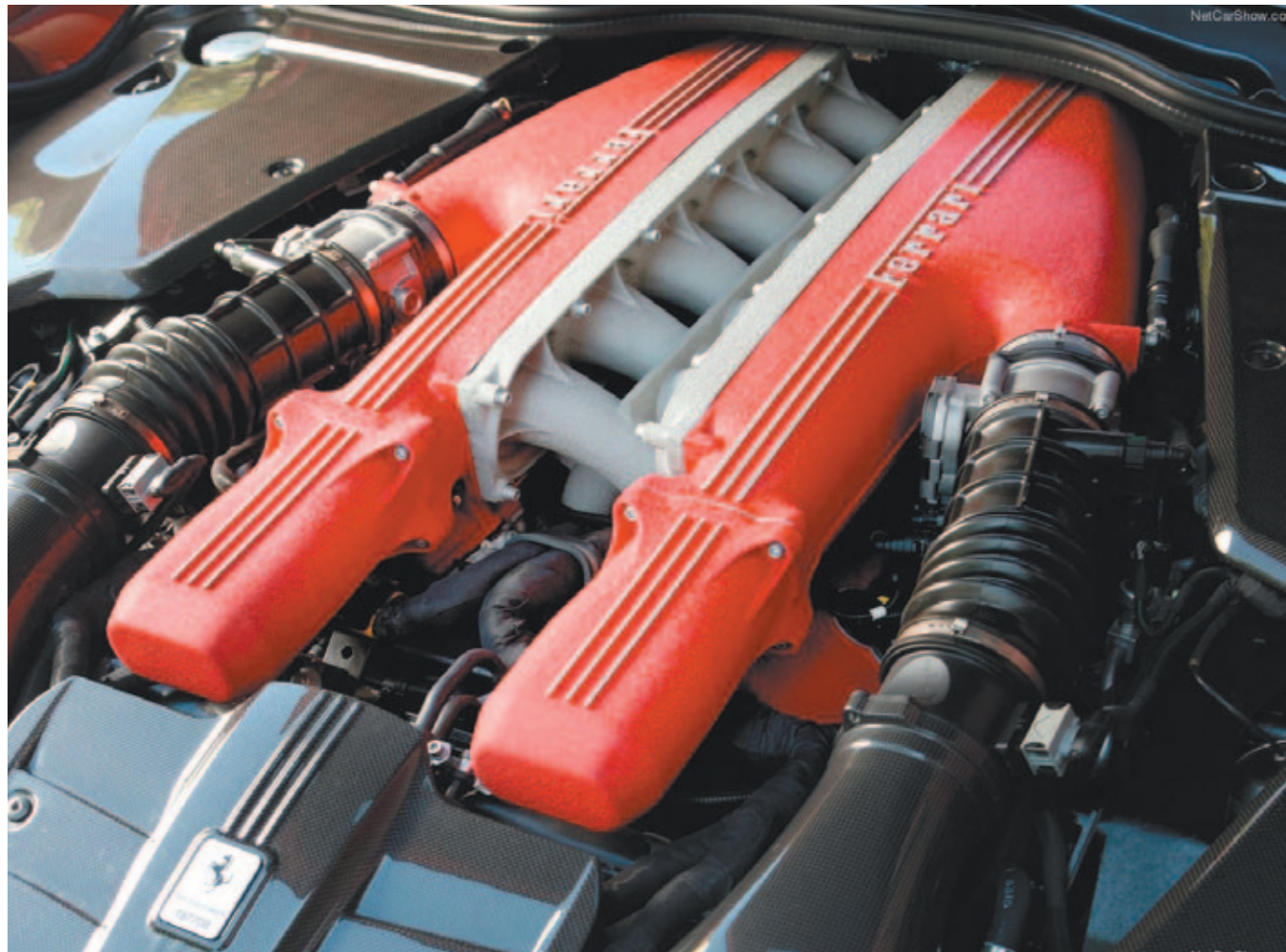
Motor de 12 cilindros en V a 65 grados, de 6262 cm3. de cilindrada, 760 CV. de potencia y 690 Nm. de par motor.
