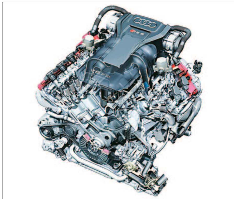
Motor en corte V8 FSI con inyección directa de nafta/gasolina, de 4,2 litros - Audi.
