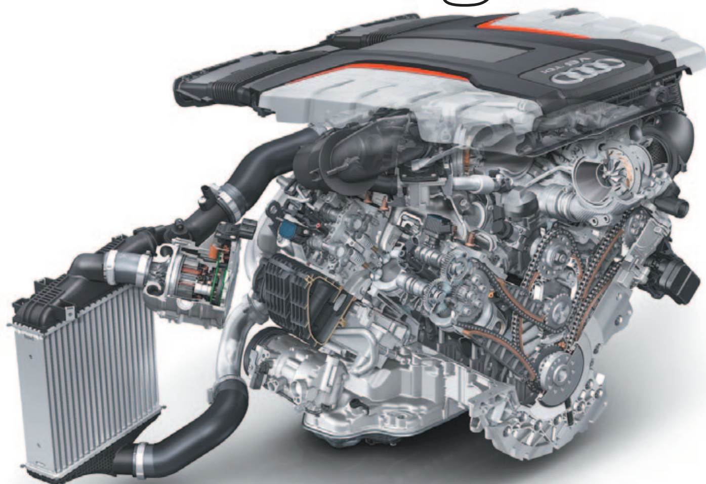
Motor Diesel en corte TDI V8 biturbo con compresor eléctrico (EPC) equipado para reducir los NO x y las partículas microscópicas. – Audi.
