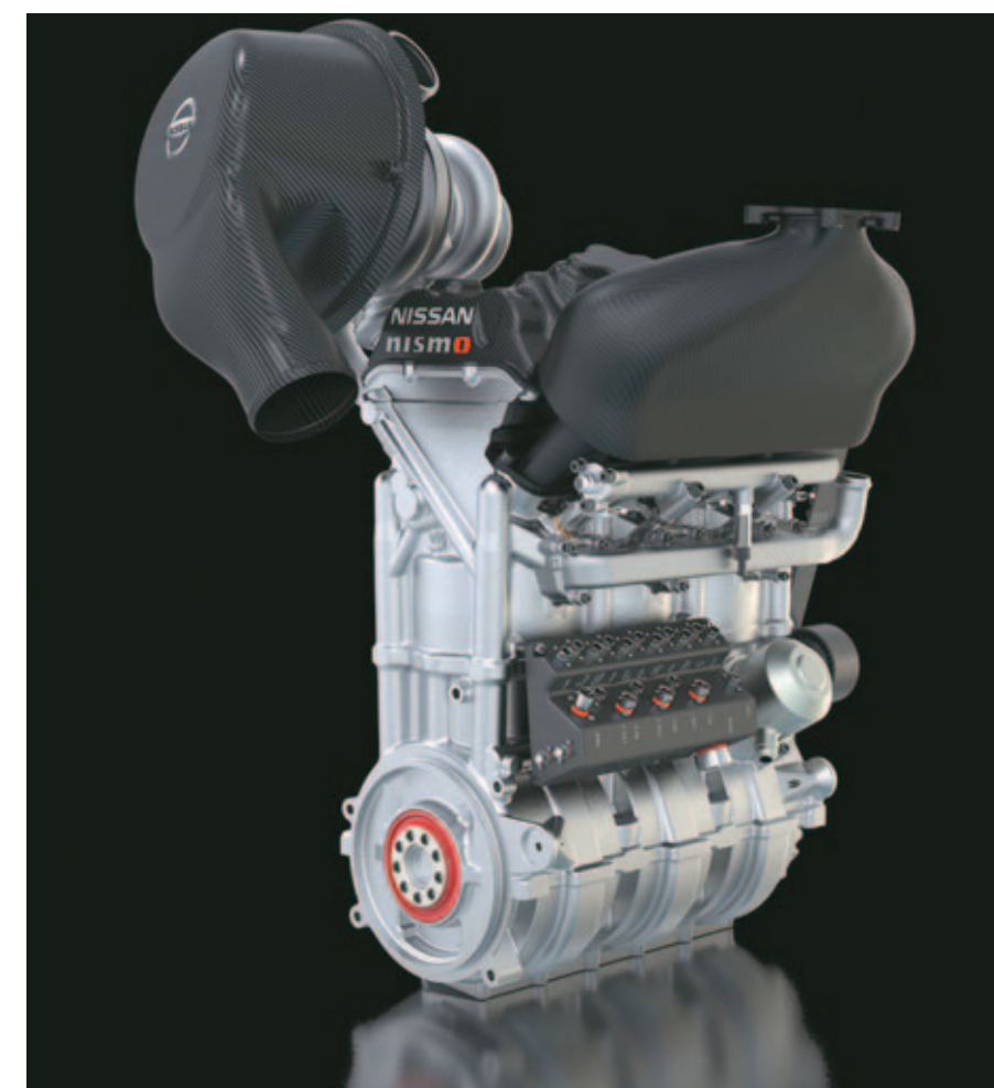
Motor de 3 cilindros “downsizing” para mejorar el rendimiento, disminuyendo las pérdidas mecánicas.-Nissan.
