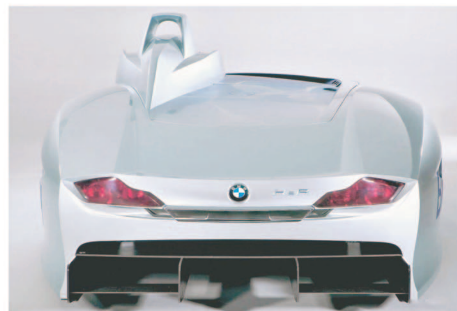
BMW H 2R, con carrocería de fibra de carbono.
