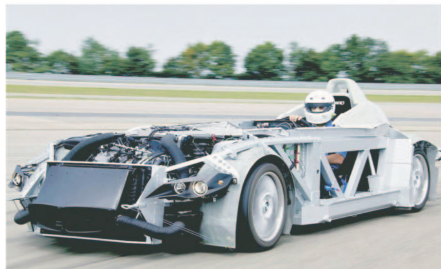
BMW H2R, con la estructura del chasis en aluminio.
