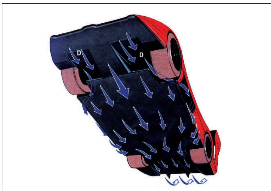
Vista del flujo en el fondo del auto, que posee una gran Superficie, y detalle de dos difusores delanteros D. todo para mejorar la "tenida en pista" con el "efecto suelo"
