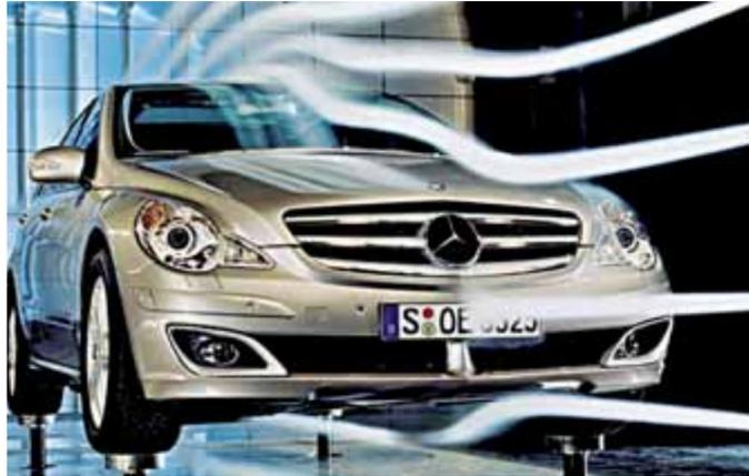
Detalle de los chorros de humo, utilizado por las terminales automotrices como método clásico para el estudio de la aerodinámica – Mercedes Benz.
