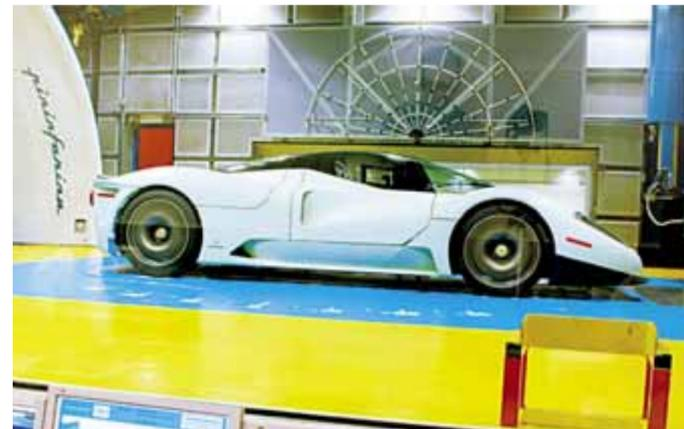
Túnel aerodinámico para la Ferrari y determinación del flujo de aire con columna de humo químico - Pininfarina.
