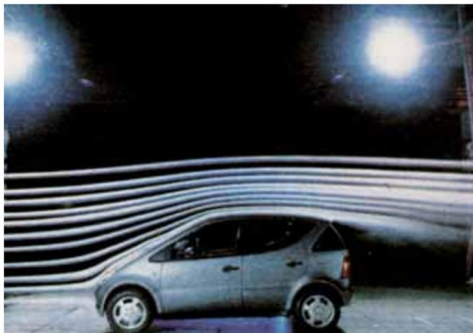
Ensayos en el túnel aerodinámico del Mercedes Benz Clase A, con humo químico. El coeficiente de penetración Cx del Clase A es similar a los excelentes valores aerodinámicos restantes.
