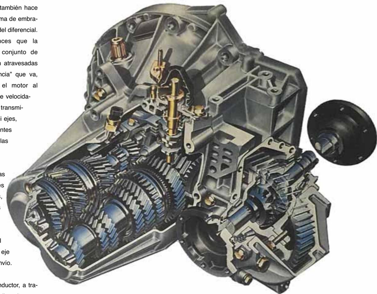
**Caja de velocidades mecánica manual —formando parte de un grupo motopropulsor— de moderno diseño. —Fiat.**
