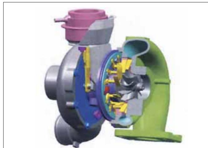
Diseño por Auto-CAD, de un moderno turbo TGV o VNT, de una nueva generación, para cumplir con las exigencias de los motores del futuro
