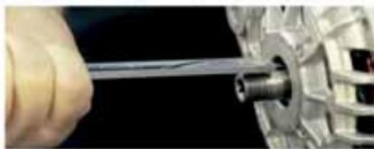
Medir el largo del rebaje del eje, esta medida corresponderá aproximadamente al largo del rebaje del eje de la polea, por lo tanto, del alternador. Esta medida será menor en aproximadamente 4 milímetros en relación a la medida del rebaje del eje de la polea; y también medir el diámetro de la rosca del rotor, esta medida corresponderá aproximadamente al diámetro de la rosca de la polea.
