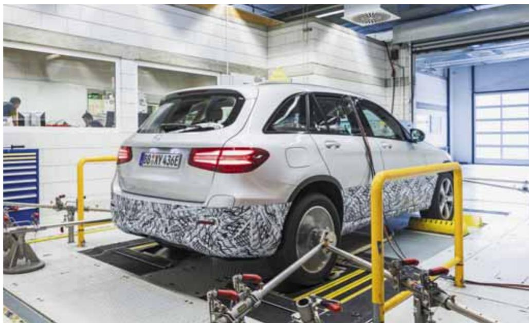
Actualmente estos valores están en El modelo Mercedes Benz a Hidrogeno Híbrido Plug-in en banco de rodillos (Sala de ensayos). GLC F-Cell.
