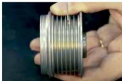
Sentido de rotación. Asegúrese de la rotación de funcionamiento del alternador aplicada en el vehículo, generalmente indicado por una flecha. En el caso que no exista esta marca, con el uso de la herramienta de montar y desmontar poleas, sujete la parte externa de la polea de rueda libre impidiendo el giro de esta parte de la misma forma que está siendo aplicada en el vehículo; gire la herramienta encajada y los estriados del eje de la polea.
