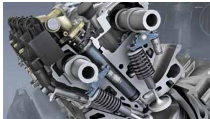
Tapa de cilindros y detalle de la cámara de combustión, de un motor V8.
