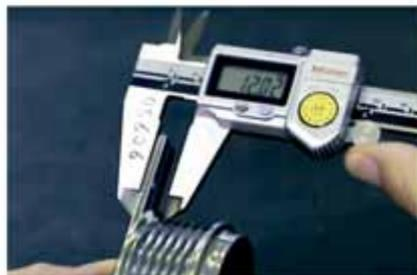
Diámetro de los filetes. Medir el diámetro de los filetes, atención! esta medida debe ser en la parte superior de los filetes, no en los canales.
