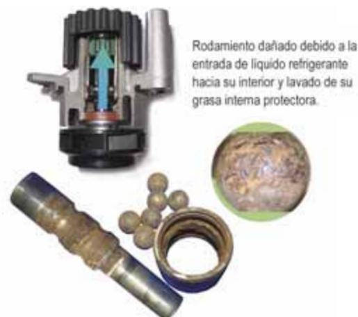
Rodamiento dañado debido a la entrada de líquido refrigerante hacia su interior y lavado de su grasa interna protectora.
