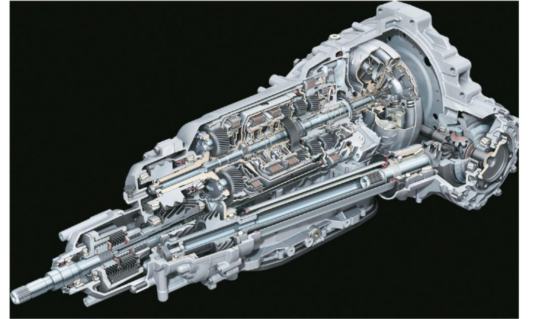
**Caja automática del tipo Tiptronic de 8 velocidades, con sistema Quattro para transmisión 4x4 permanente, de desarrollo nuevo.- Audi A8.**
