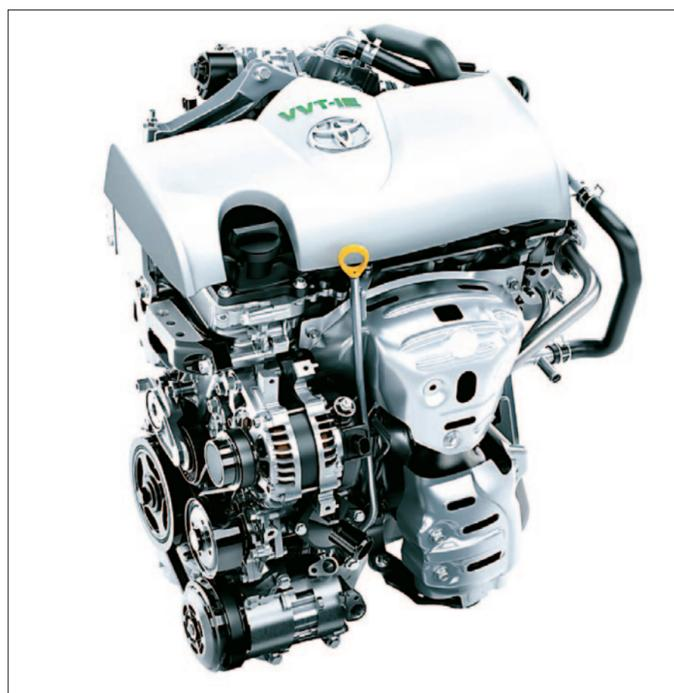
**Motor de ciclo Atkinson de gran rendimiento pero de baja potencia y par motor turbo - Sobrealimentado - Toyota VVT-iE.**
