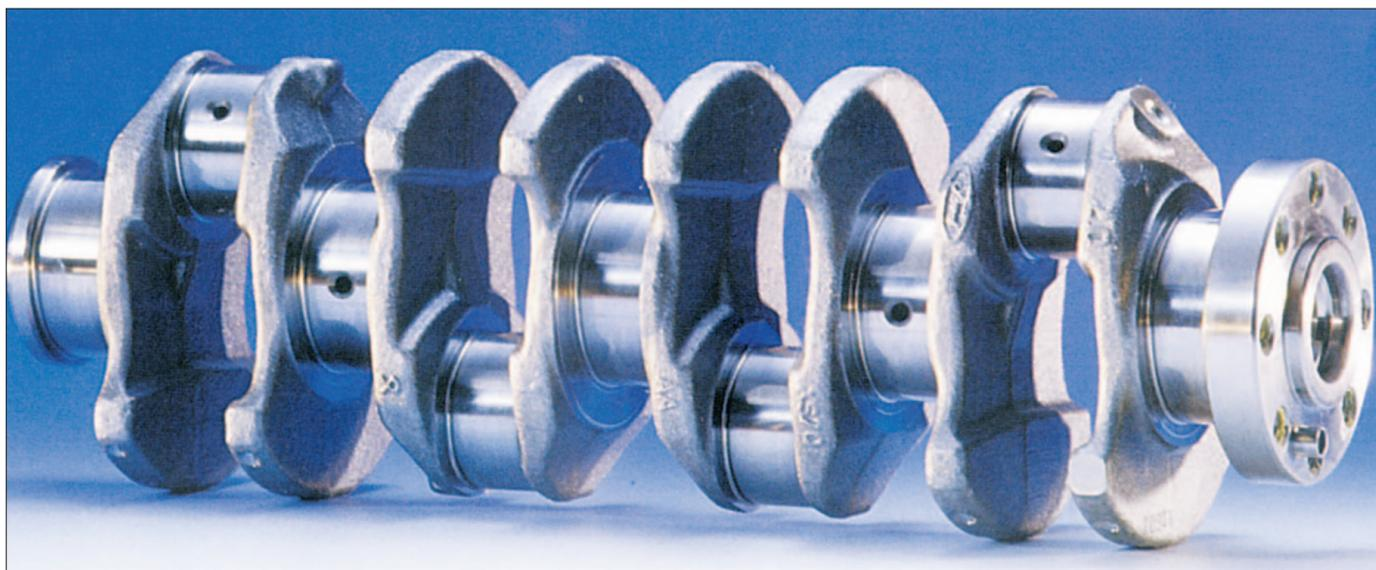
Cigüeñal de un motor Diesel Duratorq DI, de 4 cilindros y 5 bancadas con contrapesos integrados – Ford.
