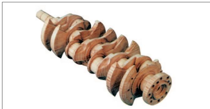
Con los componentes diseñados con el sistema CATIA, los ingenieros pueden fácilmente realizar simulaciones computadas. Prototipo de cigüeñal, construido en pocos días, en papel laminado.
