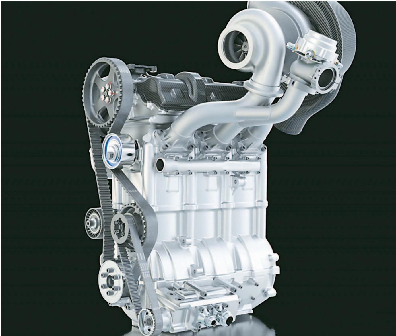
Motor de 3 cilindros de alto rendimiento, montado sobre el Nissan Nismo de competición - serie Le Mans P1.
