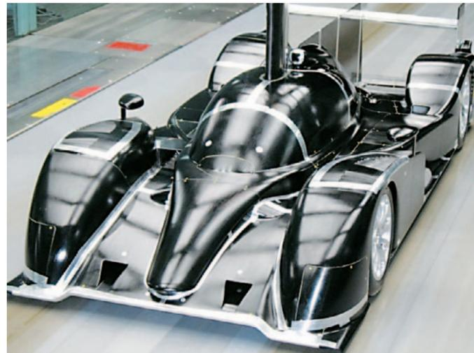
Las maquetas para estudio en el túnel de viento, se construyen normalmente en madera, yeso o arcilla especial.
