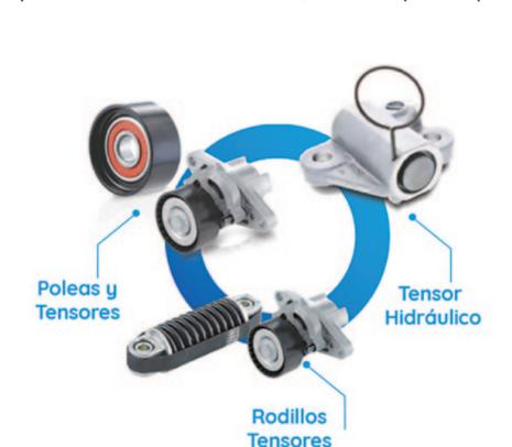
Los tensores, mecánicos, automáticos o hidráulicos mantienen la tensión óptima de la correa, evitando deslizamientos, ruidos y desgastes prematuros. Los modelos hidráulicos absorben variaciones de tensión y resisten cambios extremos de temperatura, prolongando la vida útil del sistema.
