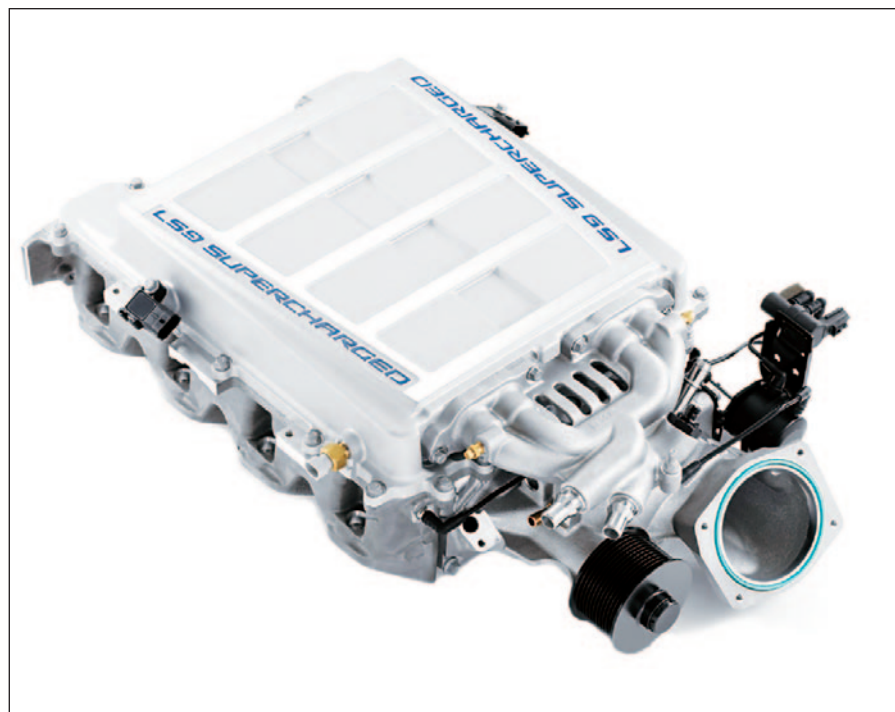
Compresor volumétrico Roots de 2 rotores lobulados, de sexta generación, fabricado por Eaton- Chevrolet Corvette ZR1.
