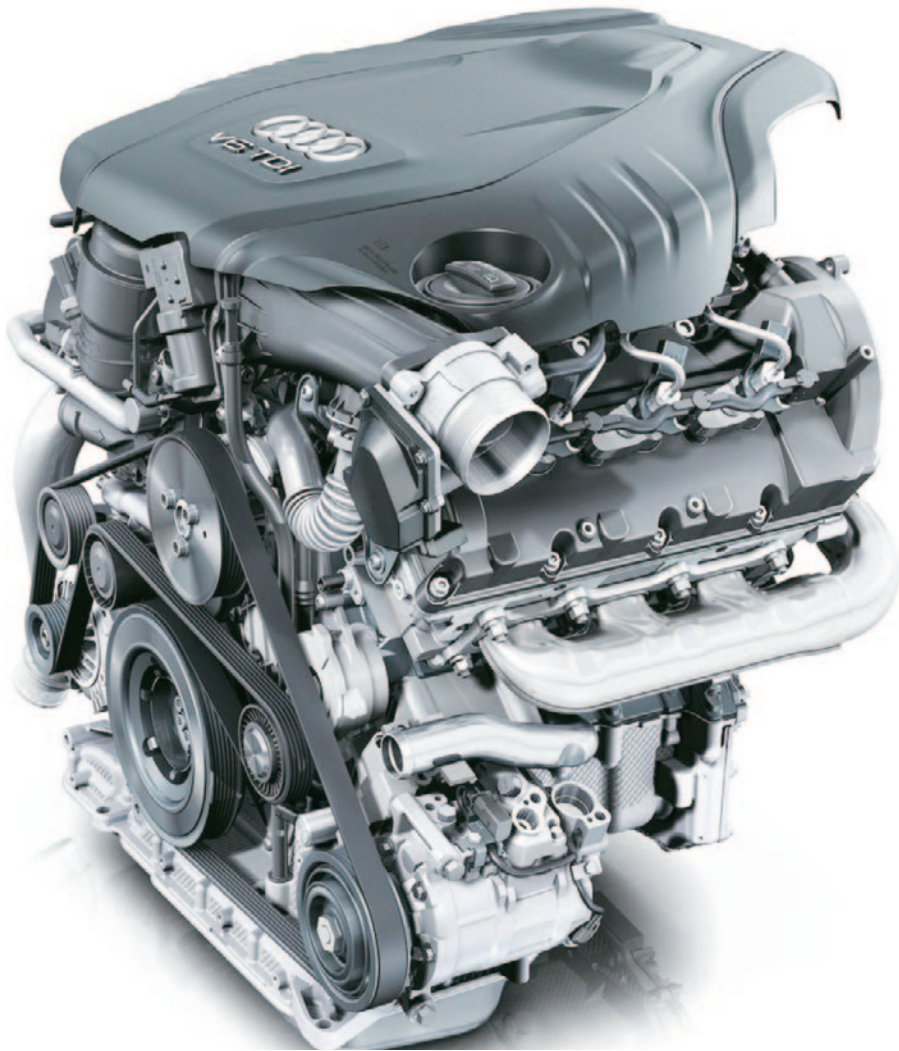
Motor gasolero de 3.0 litros 6 cilindros en V, 4 válvulas por cilindro, con inyección directa “Common rail” de alta presión, con inyectores pieza eléctricos y turbo TGV, controlado por el sistema EDC.
