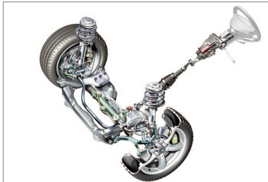
Tren delantero completo, con sistema de dirección incluida, del tipo con asistencia - MBenz.
