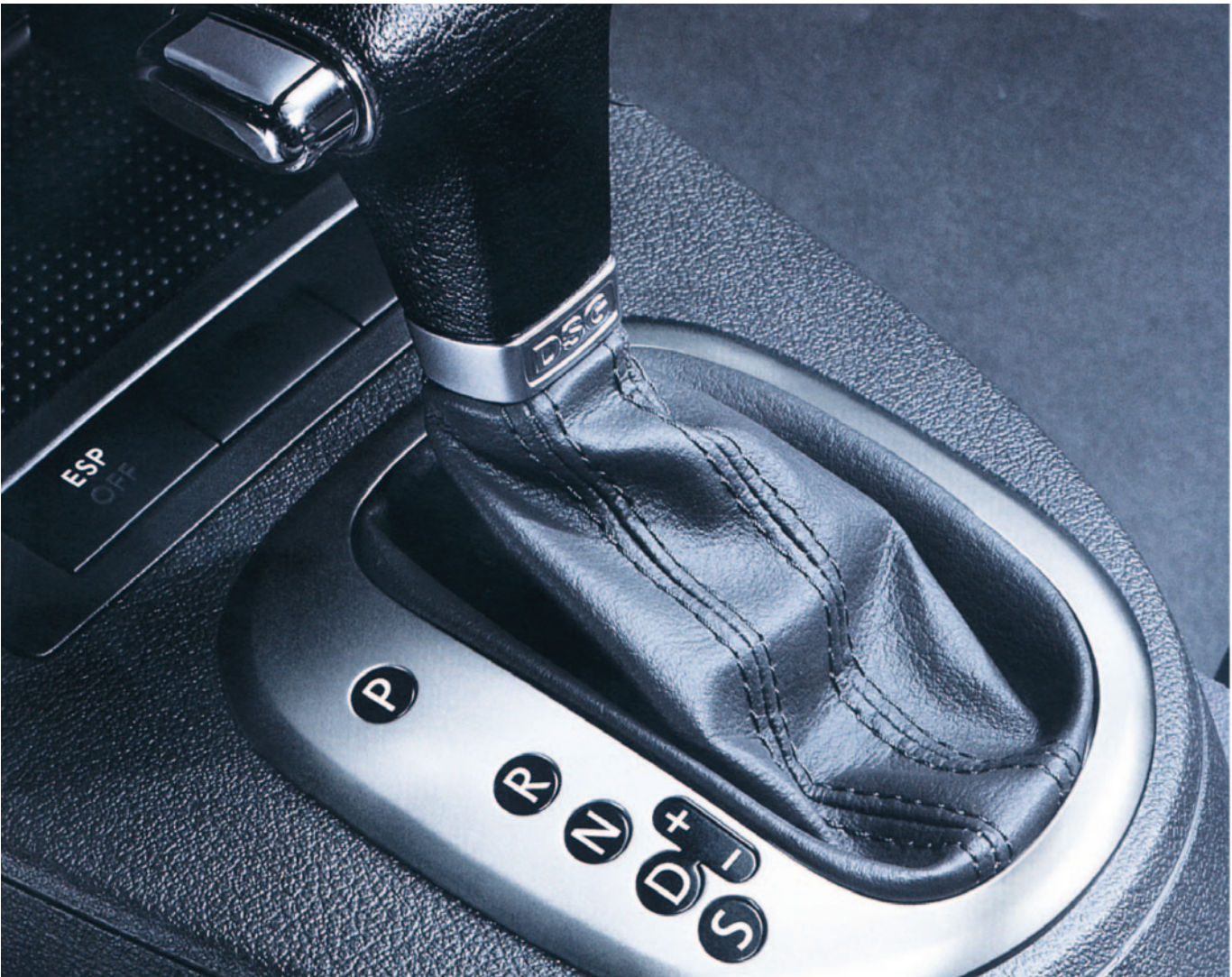
Palanca selectora de la transmisión DSG de 7 marchas con doble embrague, de funcionamiento similar al de una caja automática, con tecla de desbloqueo – VW.
