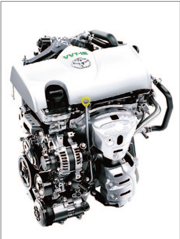
Motor de ciclo Atkinson de gran rendimiento pero de baja potencia y par motor turbo - Sobrealimentado - Toyota VVT-iE
