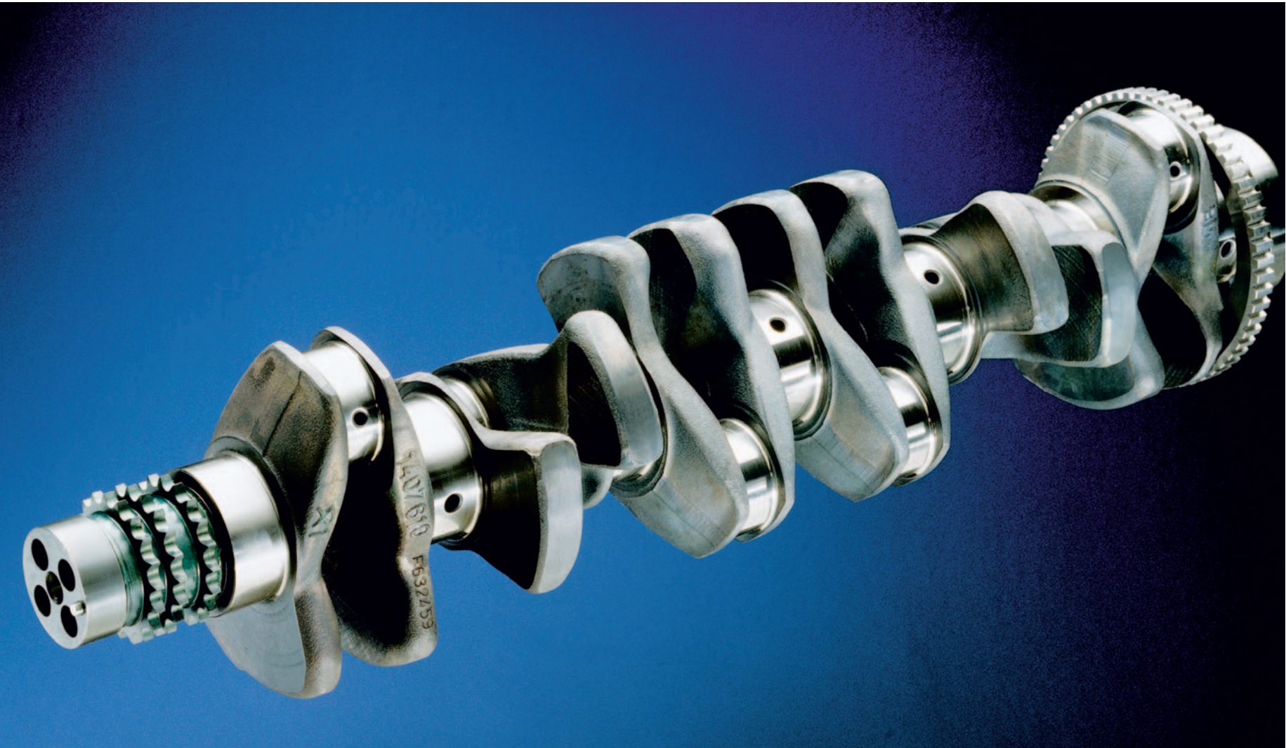
Cigüeñal de un motor de 6 cilindros en línea, con 7 bancadas, correspondiente al modelo M3 de BMW.
