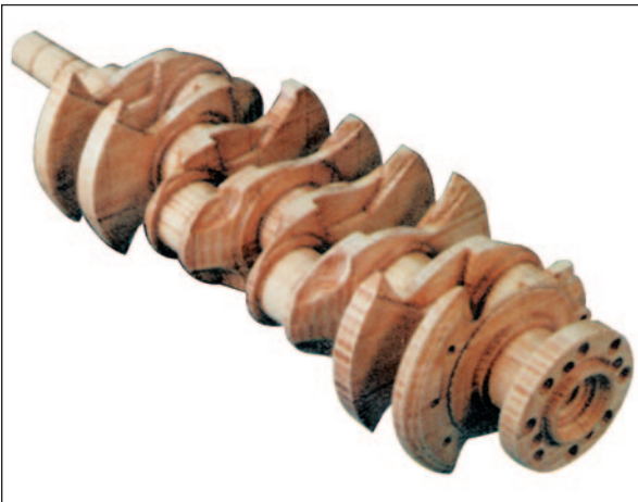
Con los componentes diseñados con el sistema CATIA, los ingenieros pueden fácilmente realizar simulaciones computadas. Prototipo de cigüeñal, construido en pocos días, en papel laminado.
