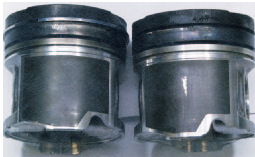
Ambos pistones muestran un desgaste diferente, por ejemplo en la falda o pollera: el de la izquierda está íntegro, incluyendo las ranuras de los aros de pistón que presentan pocos depósitos. Esto significa que la película lubricante permaneció estable.
