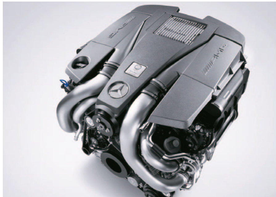
Vista exterior de un motor deportivo V8 con inyección directa y sobrealimentación- AMG.
