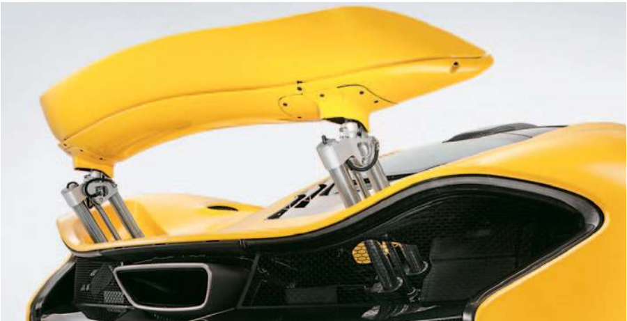
El alerón trasero activo, representan una gran ventaja para lograr el equilibrio aerodinámico, delantero y trasero- McLaren.
