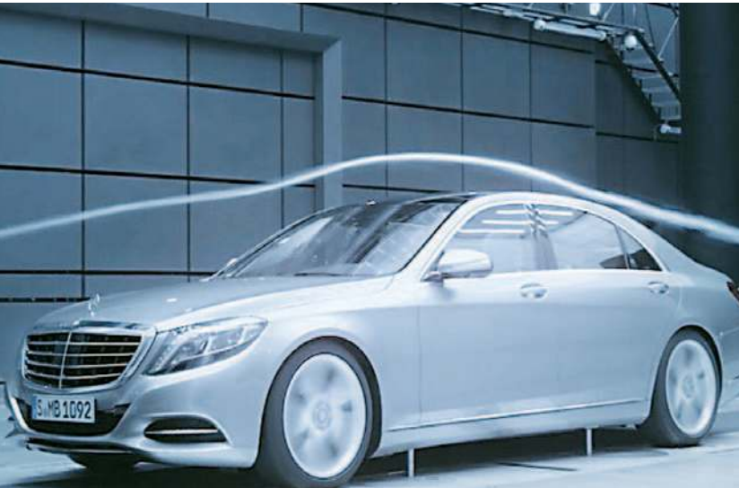
Los resultados del túnel, determinan el comportamiento del automóvil, y los aspectos a mejorar - M. Benz.
