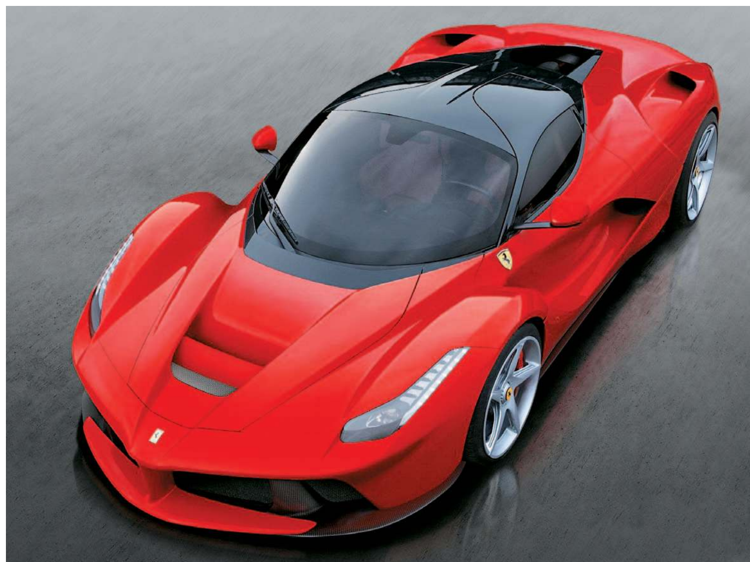
Ferrari: LaFerrari desarrolla 963 CV de potencia y un par máximo de 900 Nm. Los obtiene de un motor V12 que entrega 800 CV y de uno eléctrico de 163 CV. Ferrari llama al sistema híbrido «HY-KERS».
