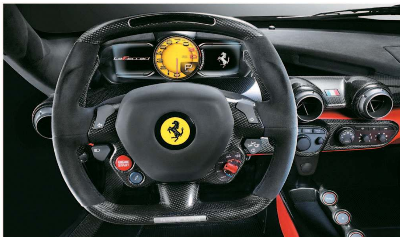
El cuadro de instrumentos del Ferrari LaFerrari es una pantalla que puede configurarse para ver la información de distintas maneras. El asiento del conductor se ajusta a medida y se fija en esa posición, sin regulación posible. Si la hay para el volante y los pedales.
