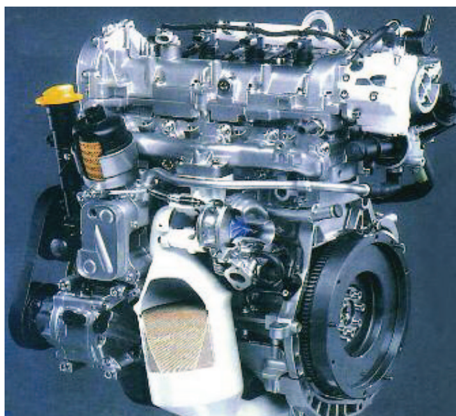
Motor Diesel “downsizing” de baja cilindrada, diseñado para reducir los tenores contaminantes - Fiat 1.3 Multijet.
