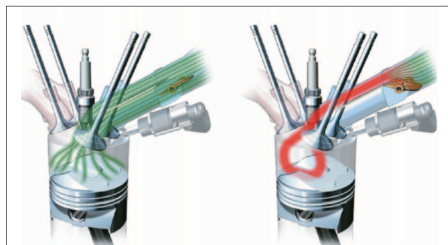
La inyección directa de nafta/gasolina de alta presión (200 bares) logra en sus diferentes versiones, una combustión completa.
