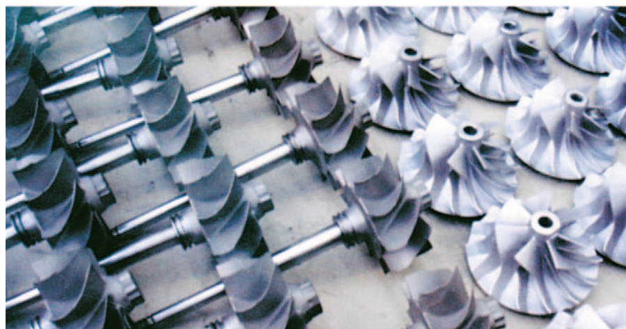
Para la soldadura del eje con los rotores, se usa un método por bombardeo electrónico (haz de electrones).
