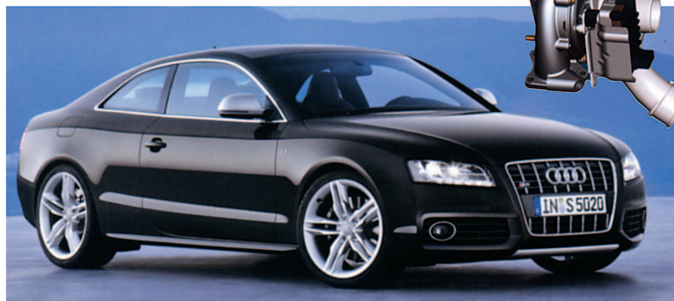
Audi A5 con motor Diesel de inyección directa –inyector/bomba– de 3.0 litros y 240 HP a 4000 rpm de potencia, turbosobrealimentado con un modelo GT22 VNT (variable) de tercera generación, controlado por un actuador electrónico (SREA) – Garrett.
