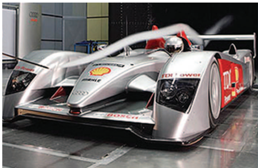
Estudio aerodinámico con humo químico, en el nuevo túnel, de los automóviles de serie, y de los prototipos de competición TDI (American Le Mans Series) - Audi.
