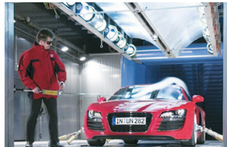
Estudio aerodinámico con humo químico, en el nuevo túnel, de los automóviles de serie, y de los prototipos de competición TDI (American Le Mans Series) - Audi.
