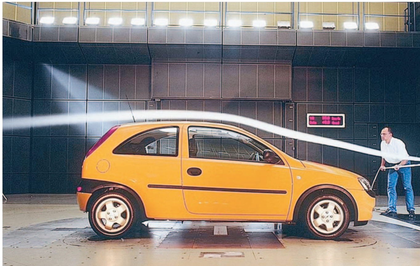
Trabajo aerodinámico en túnel de viento, en donde el coeficiente CX, es el parámetro principal de la fórmula que determina la resistencia al avance - Opel/GM.
