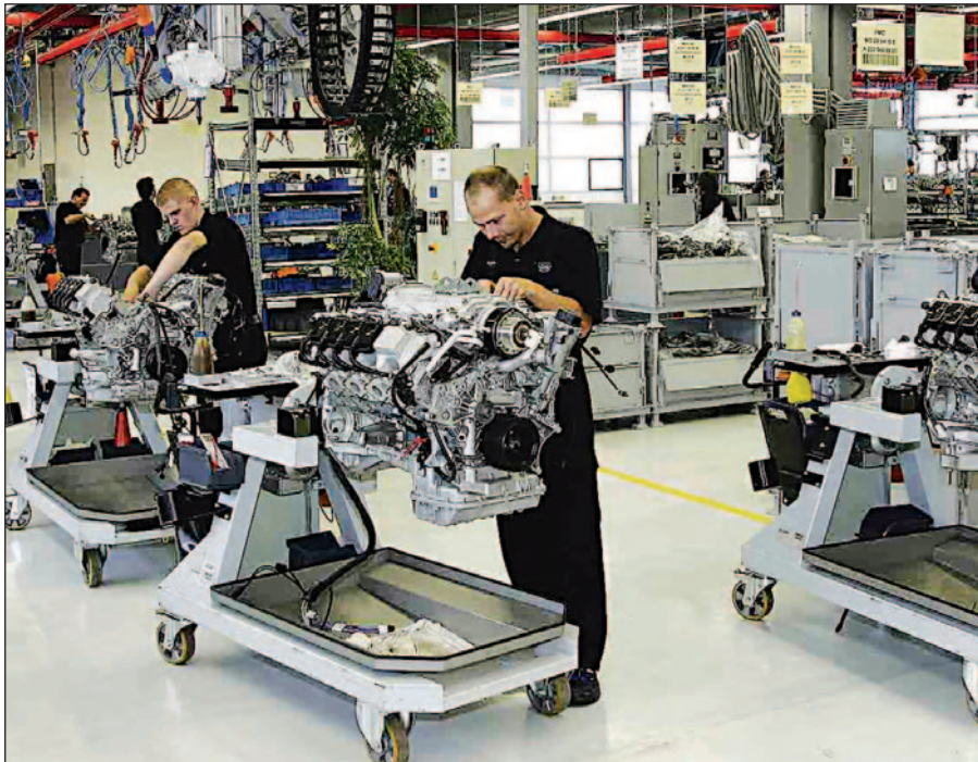
Un hombre un motor: con un pequeño carro sofisticado en mecánico o técnico especializado, arma él solo un motor todo a mano - AMG.
