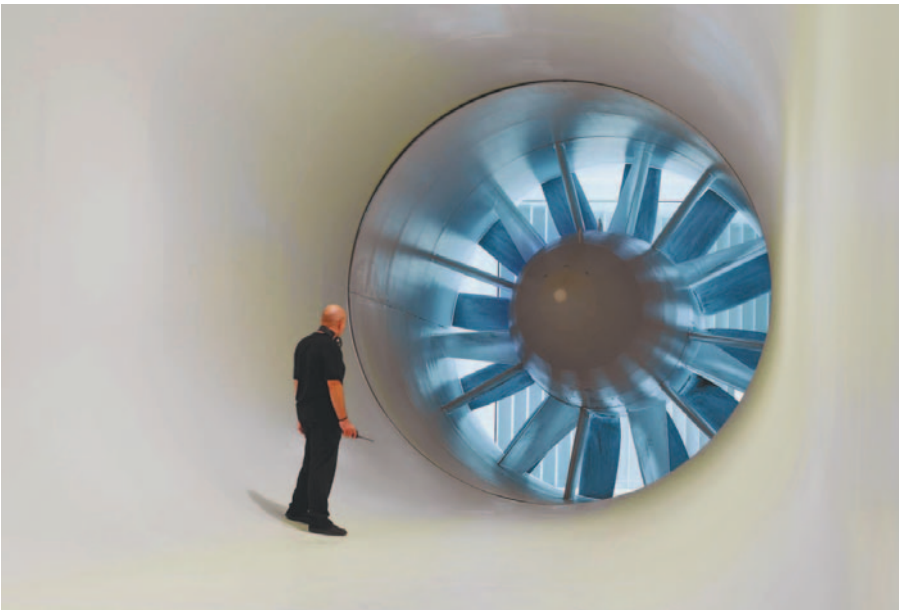
Ventilador tamaño gigante de alta potencia de túnel aerodinámico.
