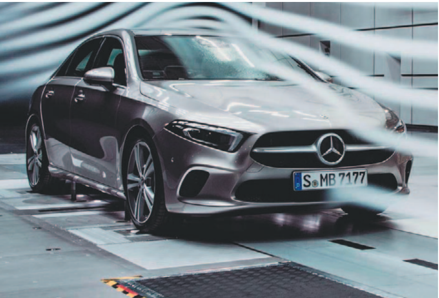
Túnel aerodinámico para escala natural. Mercedes Benz.
