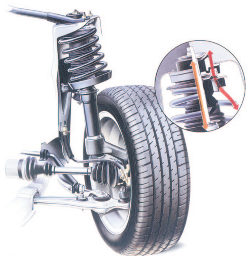
El sistema McPherson incorpora amortiguadores de gas de acción directa, y resorte de largo recorrido. Detalle del apoyo del resorte/amortiguador superior, de diseño exclusivo – Saab.
