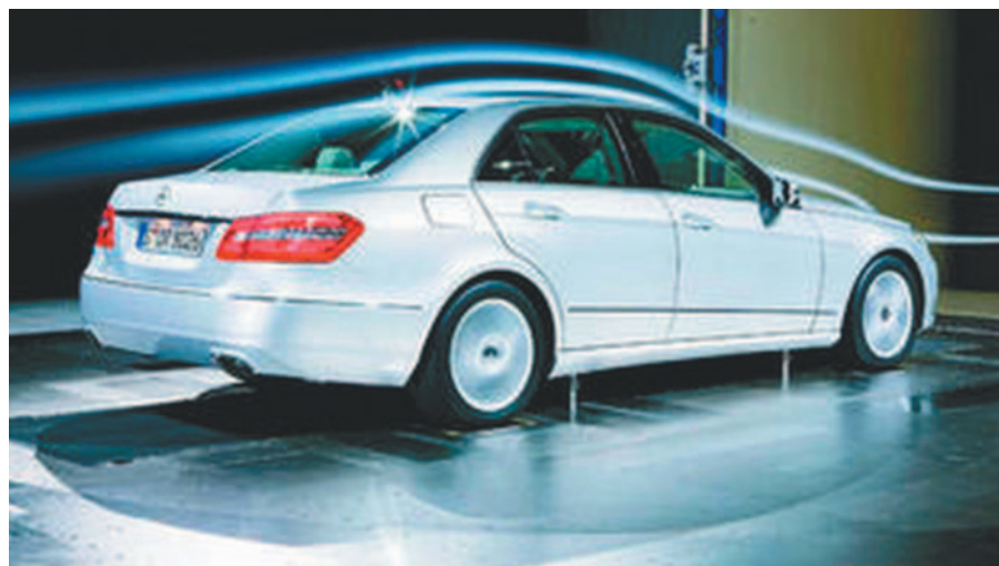
Experiencias en el túnel de viento con modelos a escala 1:1 – Mercedes Benz
