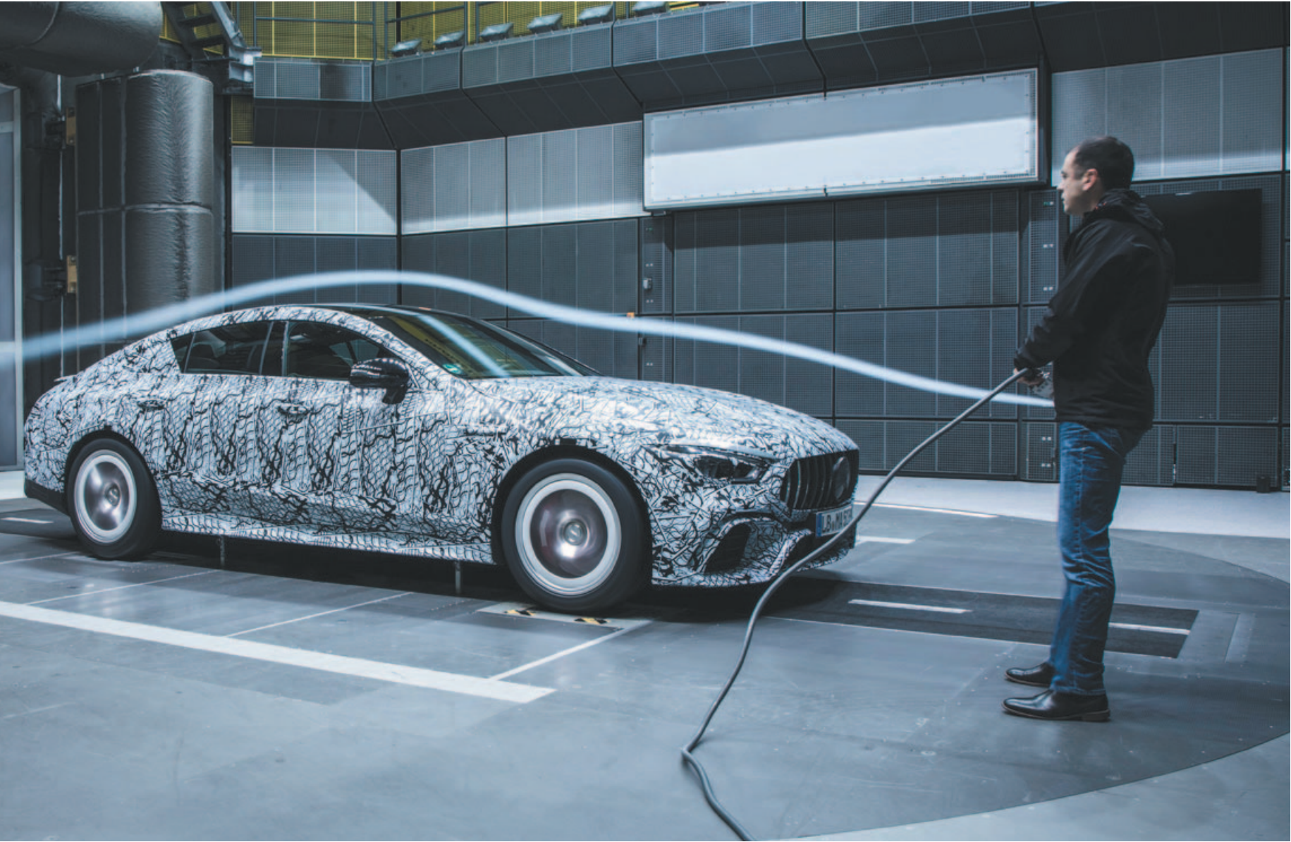
Método de los “filetes de humo” parafínico; en el túnel aerodinámico de Mercedes Benz.
