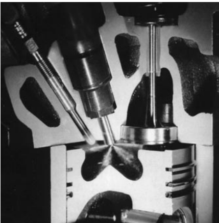
Bujías de precalentamiento e incandescente. Arriba: Detalle de una cámara de alta turbulencia de un motor con inyección indirecta. Abajo: Bujia incandescente para una inyección directa, detalle de la inyección de gasoil dentro de la cámara de combustión practicada en la cabeza del pistón.
