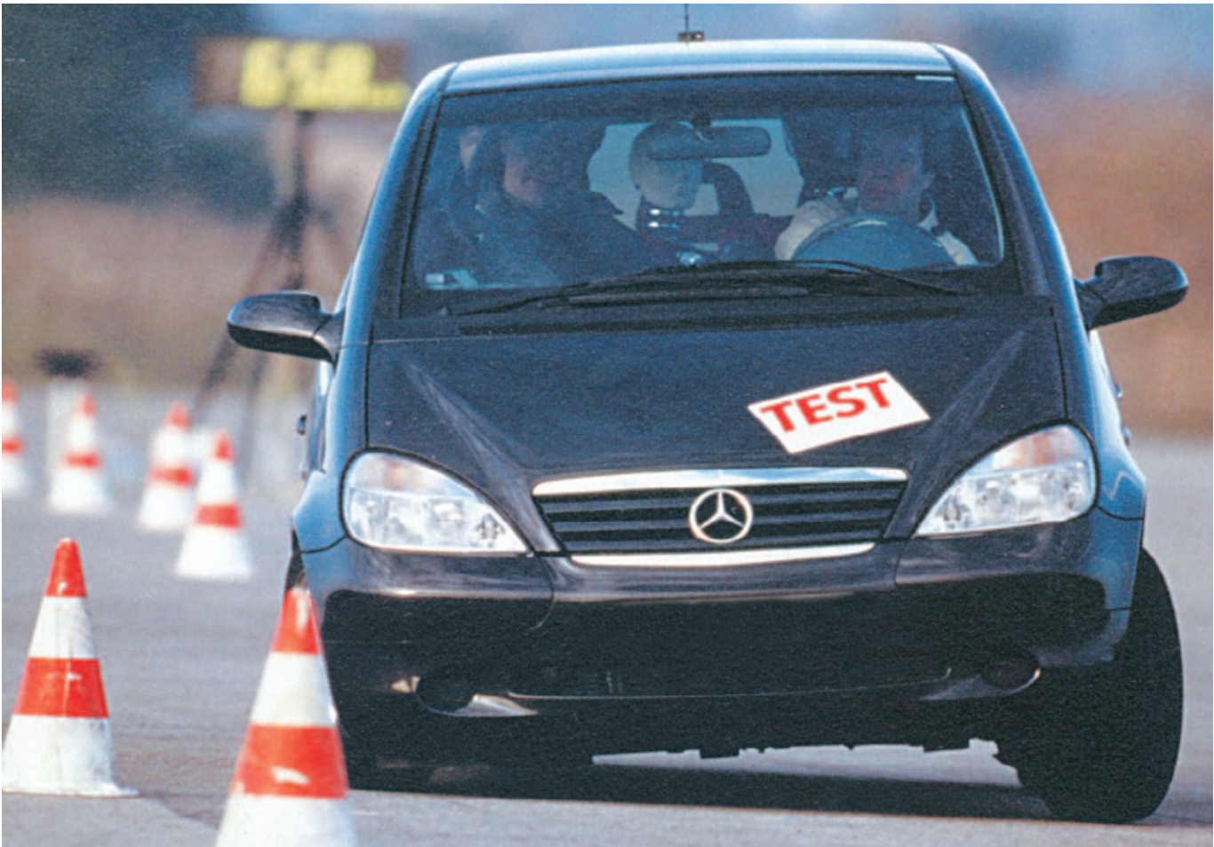
Ensayos efectuados en simulador y en pista de pruebas "como en este caso", del comportamiento del programa electrónico de control de estabilidad. Mercedes Benz.
