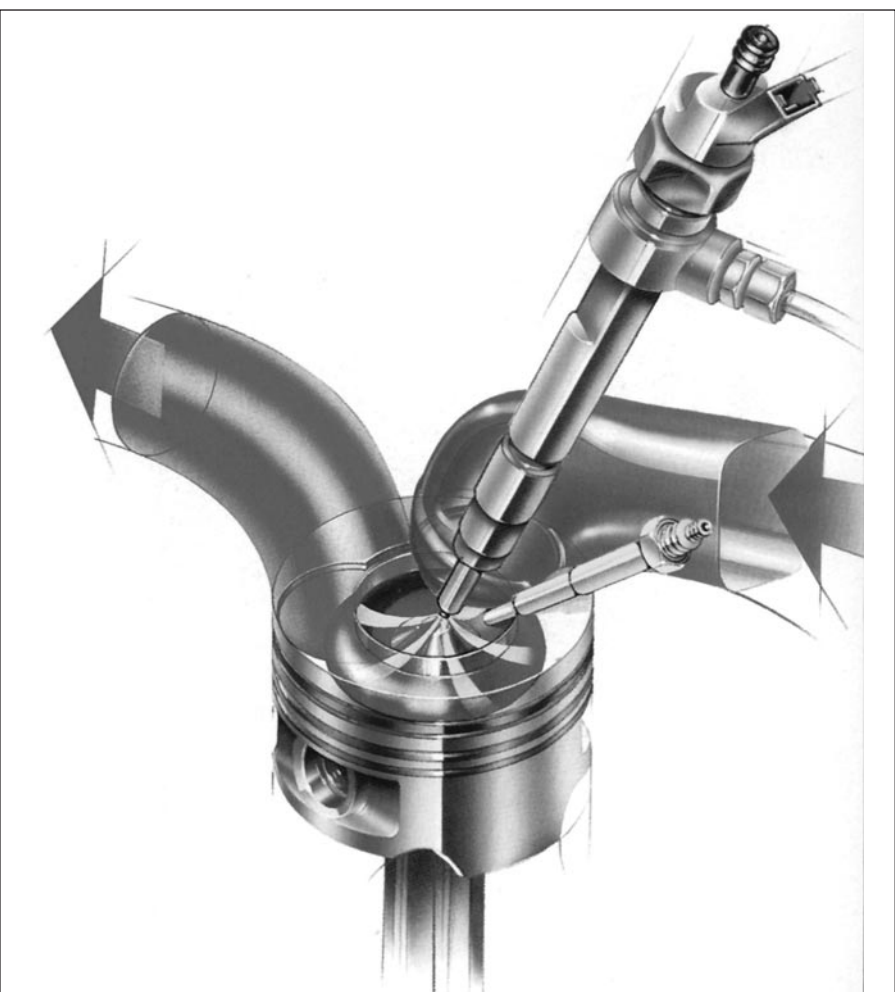
Ejemplo de inyección directa Unijet de un motor Diesel JTD y posicionamiento del electroinyector del sistema “common rail” que pulveriza el gasoil a través de 5 orificios. Detalle de la bujía incandescente para la puesta en marcha - Tecnología Fiat.
