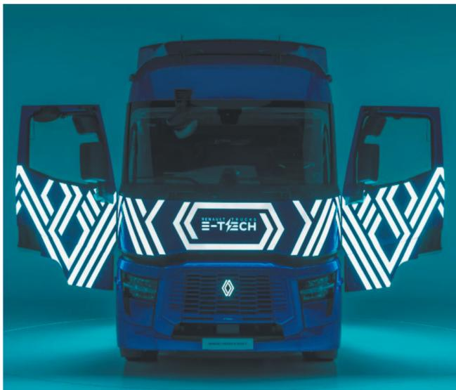
Fruto de la colaboración con conductores y especialistas en diseño y pintura, este camión excepcional se descubre en la oscuridad. Basada en la tecnología Lumilor, la pintura, aplicada por Demon Paint, brilla cuando se somete a un estímulo eléctrico.
