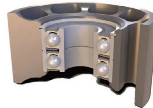
Una polea tensora utiliza un brazo activado por un resorte o un actuador hidráulico para aplicar la presión adecuada y ayudar a mantener la tensión y la alineación de la correa. En un sistema de transmisión por bandas, la polea tensora es accionada por un resorte para mantener la tensión y la alineación adecuadas de la banda serpentina. La polea tensora está atornillada al motor y sirve de guía para enrollar la correa en la dirección correcta.
