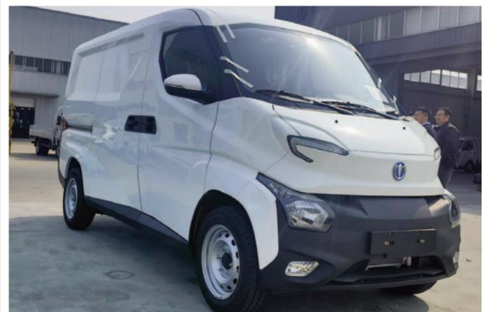
Equipado con una batería de litio LFP de 41,86 kWh, el Keyton Q2 tiene una vida útil garantizada de 5 años o 120.000 km. Además, gracias a los cargadores ultra rápidos de UTE en Montevideo y en todo el país, puede cargar del 0 al 80% en solo 45 minutos, maximizando su operatividad diaria. ■
