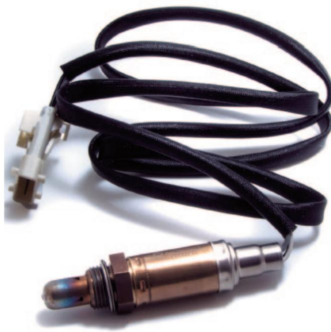
Para evitar esto, algunas sondas poseen intercalado con el sensor de oxígeno una resistencia calefactora que disminuye el tiempo entre el arranque y el correcto funcionamiento del sensor.
