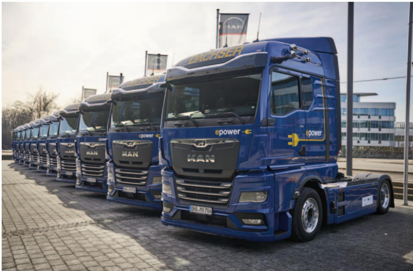
**M**AN Truck & Bus ha puesto en servicio doce camiones eTGX totalmente eléctricos con megaremolques Ultra Low Liner. Estas unidades están diseñadas para el transporte de gran volumen, con un espacio de carga optimizado gracias a 20 centímetros más de altura interior. Esto permite aumentar el volumen de carga en ocho metros cúbicos sin exceder el límite de altura de cuatro metros permitido en Alemania.
