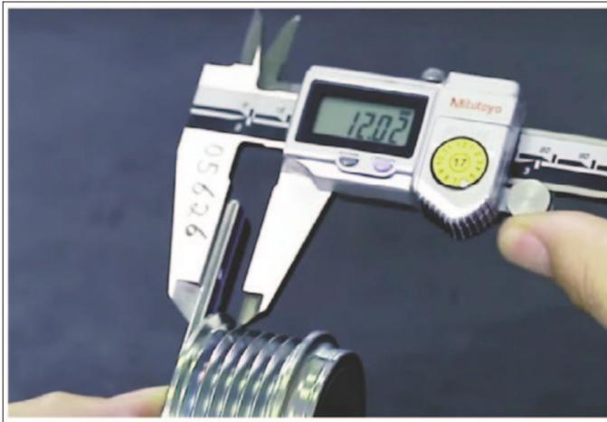
**Diámetro de los filetes.** Medir el diámetro de los filetes, atención! esta medida debe ser en la parte superior de los filetes, no en los canales.
