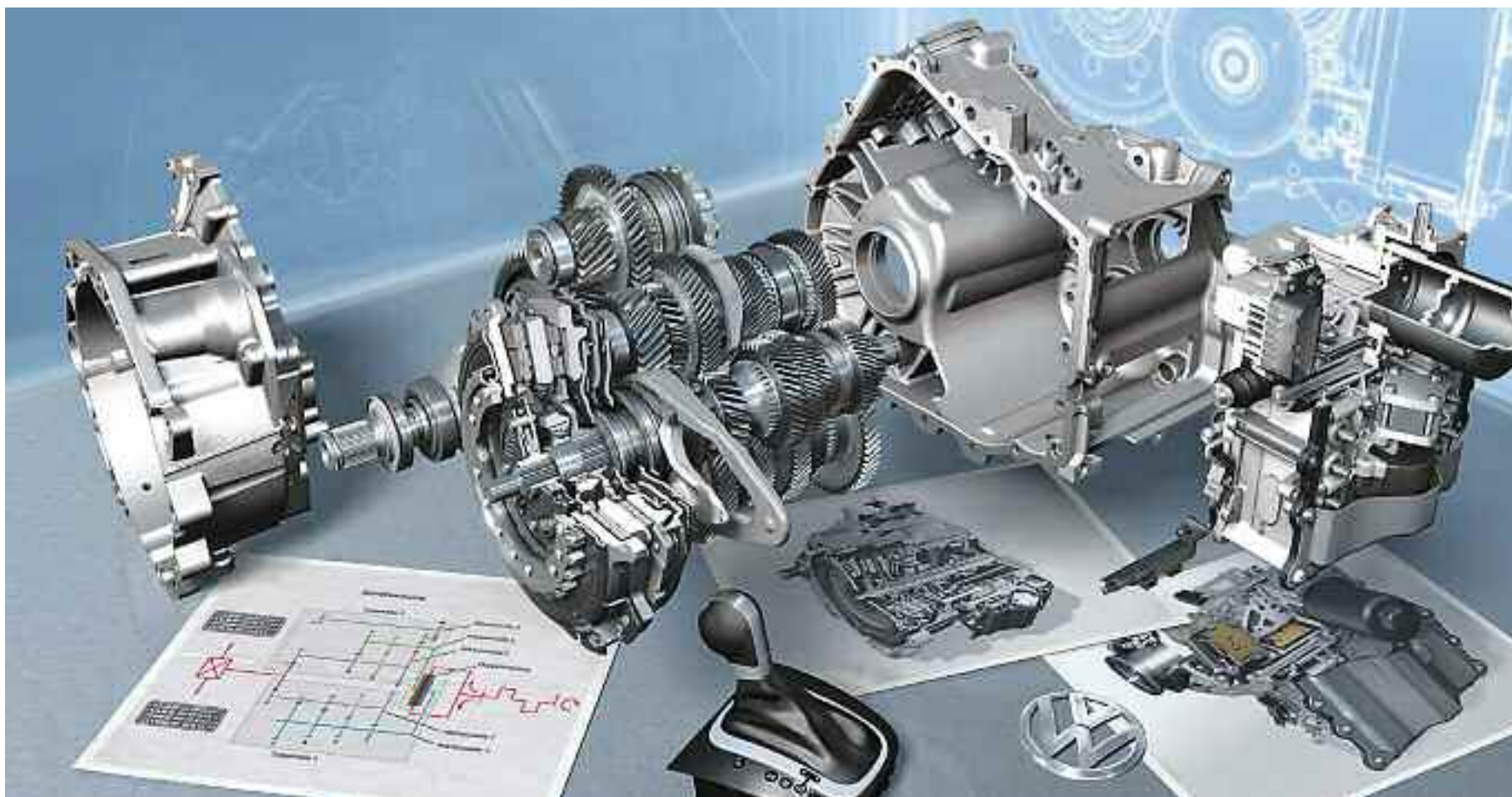
Conjunto de elementos mecánicos de la caja de marchas DSG 7 velocidades.
