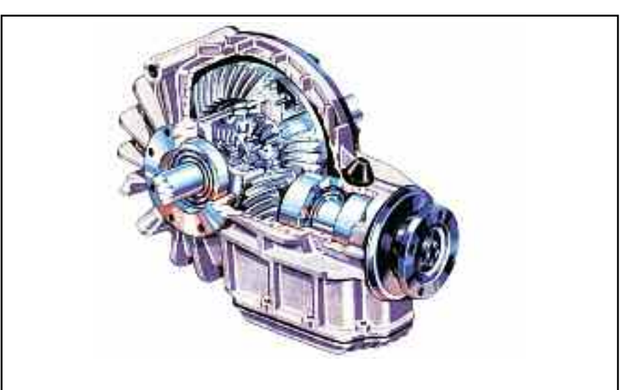
Dispositivo mecánico que recibe el movimiento de un eje, y lo reparte en otros dos.- Diferencial autobloqueante.
