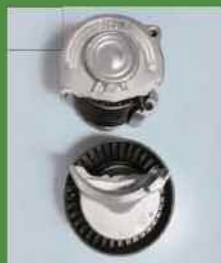
SOMETIDO A SOBRE ESFUERZO ROTURA POR FATIGA DE MATERIA
