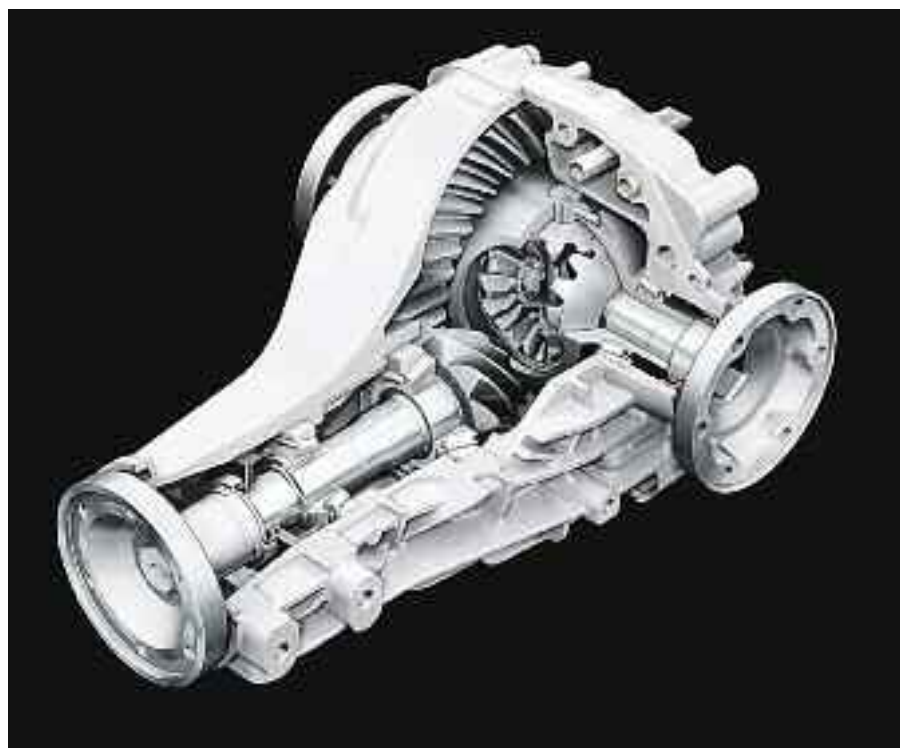
Corte parcial de un diferencial clásico, compuesto por el conjunto reductor “piñón-corona” y por el mecanismo diferencial propiamente dicho. - Audi.
