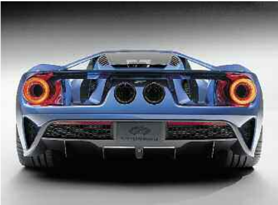
El alerón trasero del Ford GT puede variar su altura e inclinación con el fin de incrementar el agarre en curva o disminuir la resistencia al avance. La suspensión es de tipo pushrod, lo que supone, entre otras cosas, que el conjunto resorte -amortiguador vaya colocado en posición casi horizontal, en vez de vertical.
