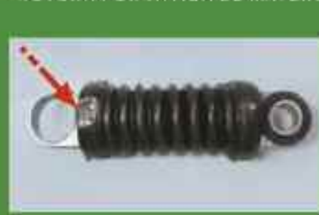
PERDIDA DE BUJE POR VIBRACIÓN
