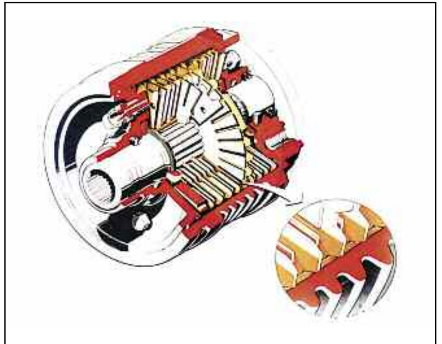
El diferencial viscoso, también denominado embrague viscoso o conjunto viscoacoplador, se basa en un funcionamiento simple por medio de discos que se mueven, dentro de un baño de aceite siliconado.
