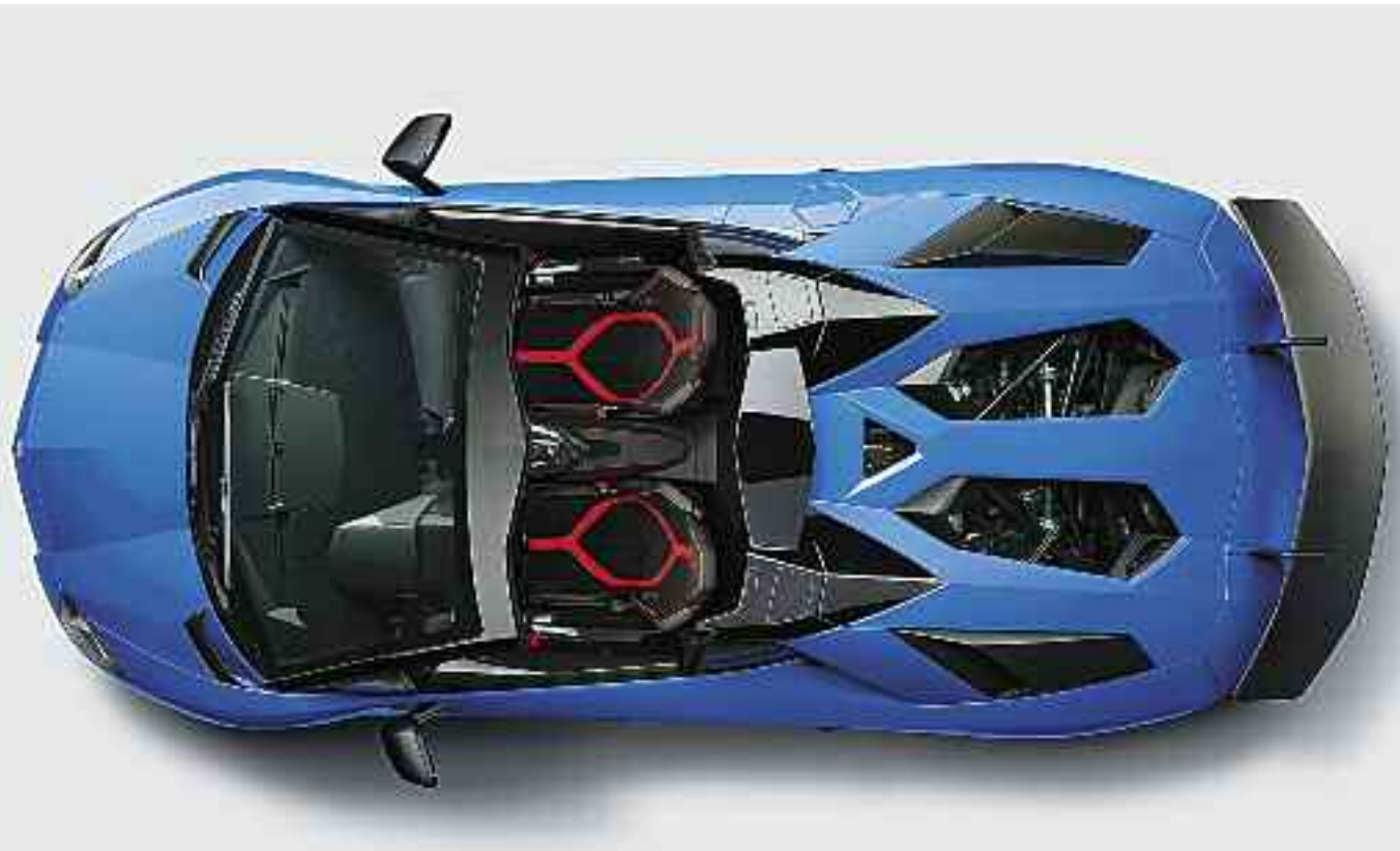
La aerodinámica del Aventador LP 750-4 SV ha incrementado el apoyo aerodinámico sin aumentar la resistencia al avance. Para ello, ha revisado muchas piezas; por ejemplo el alerón posterior regulable es nuevo, la parte frontal de la carrocería tiene un nuevo diseño (que en gran medida viene determinado porque las tomas de aire son de mayor tamaño) y en la parte posterior hay un difusor aerodinámico diferente.
