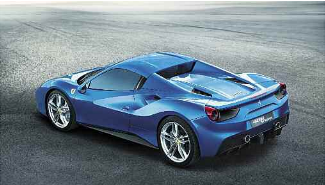
El aluminio es el principal material de la Ferrari 488 Spider, pero no es el único porque también hay magnesio y metales nobles. Ferrari afirma que la rigidez torsional y flexional de la 488 Spider es la misma que del 488 GTB y un 23% más alta que la 458 Spider. La 488 Spider es 50 kg más pesada que la 488 GTB (1.525 y 1.475 kg respectivamente) y 10 más liviano que la 458 Spider.
