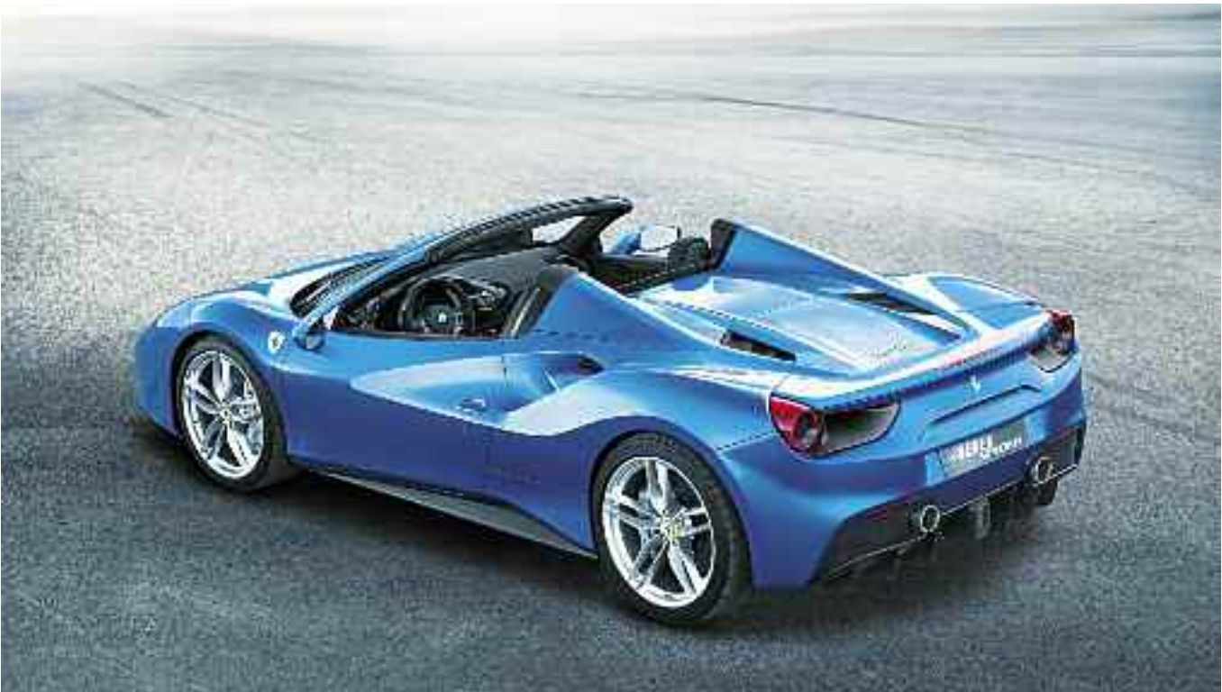
En la Ferrari 488 Spider los niveles de rendimiento son nada menos que extraordinarios: una potencia máxima de 670 CV combinado con un par máximo de 760 Nm a 3.000 rpm. Es un motor excepcionalmente eficiente ya que no es más que 100 CV más potente que el anterior V8 de aspiración natural, pero también tiene menos emisiones de CO2
