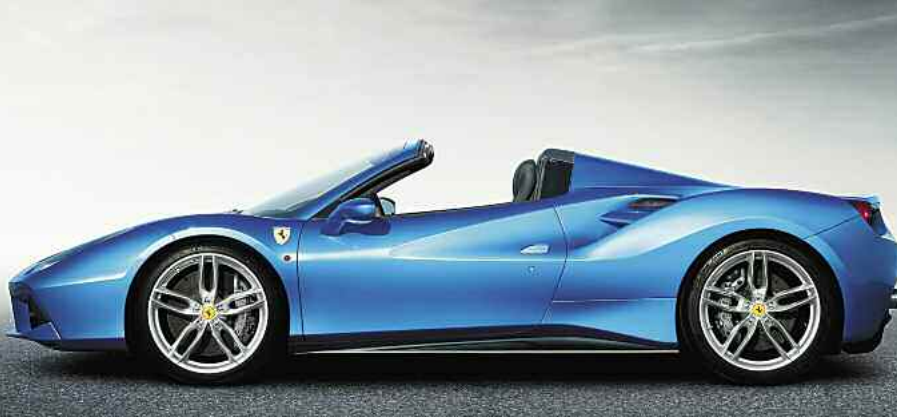
La Ferrari 488 Spider es la versión descapotable del Ferrari 488 GTB y el sustituto del Ferrari 458 Spider. Tiene un techo de aluminio, compuesto por dos piezas móviles, que tarda 14 segundos tanto en plegarse sobre el compartimento del motor, como en desplegarse sobre el habitáculo. Ferrari asegura que es 25 kg más liviano (y da mayor aislamiento acústico) que uno equivalente de techo de lona.
