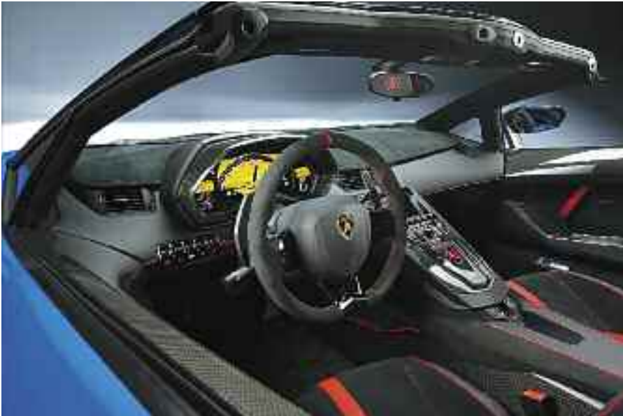
Una de las novedades que distinguen al interior de este Aventador es que la pantalla de la instrumentación es de color amarillo. Algunas piezas, como el techo y otras partes del interior, están recubiertas de un material denominado Carbón Skin (que lo estrenó el Aventador J), que es un material que Lamborghini define como liviano, robusto y flexible.
