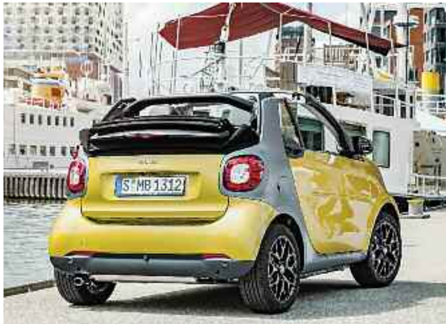
El nuevo Smart fortwo configura, una superficie de 1,8 m2 del “TRITOP” capota de tela es de aproximadamente 4 % más grande que su predecesor. La cubierta exterior está hecha de un tejido de poliacrílico particularmente resistente a la luz y el interior cuenta con una mezcla de poliéster / algodón. Hay una capa de caucho en el medio. La capota tiene un espesor total de 20 mm. La luneta trasera se calienta y es de vidrio.
