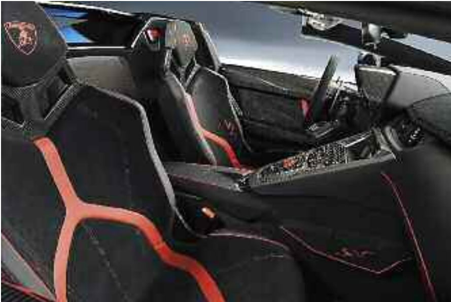
En el interior del Aventador LP 750-4 SV ha disminuido el peso. Así, la estructura de los asientos y el recubrimiento de las puertas también son de fibra de carbono. Lamborghini ha eliminado el sistema de información y entretenimiento (aunque se puede montar como opción sin costo).
