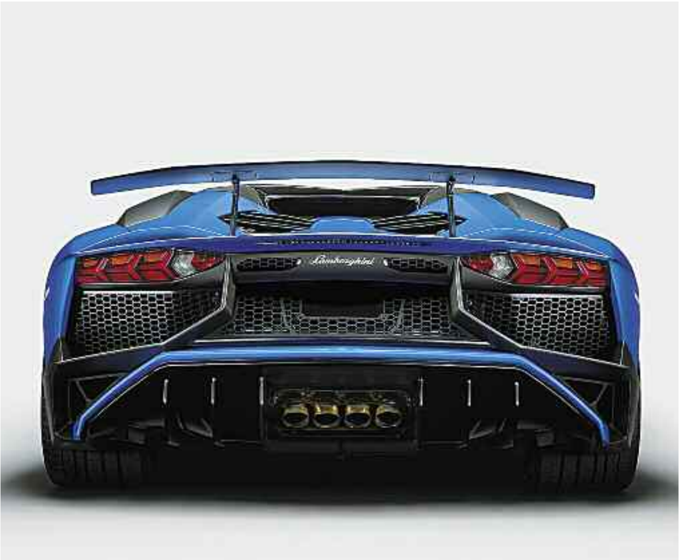
El Aventador LP 750-4 SV es 50 kg mas liviano, esta reducción de peso se ha conseguido gracias al uso de piezas de fibra de carbono. Este material, además de formar parte de la estructura del habitáculo, también está presente en paneles de las puertas, en el alerón posterior y en las entradas de aire.
