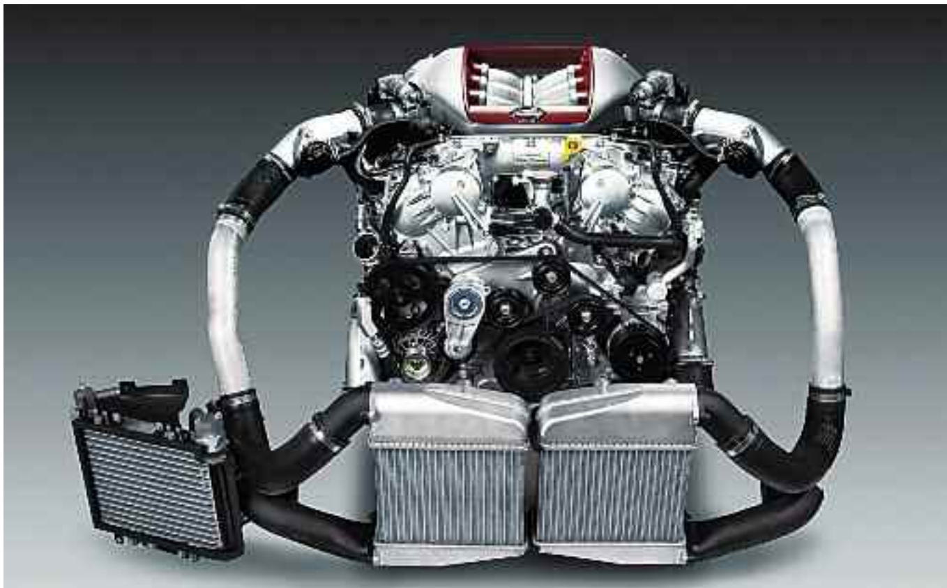
Motor de nafta/gasolina V6, de inyección directa Turbo-intercooler de última generación que en la actualidad suministra altos valores de potencia y par motor, y requiere un sistema de lubricación y un aceite lubricante de avanzada todo para mantener un bajo consumo de combustible y una contaminación contenida - Nissan.
