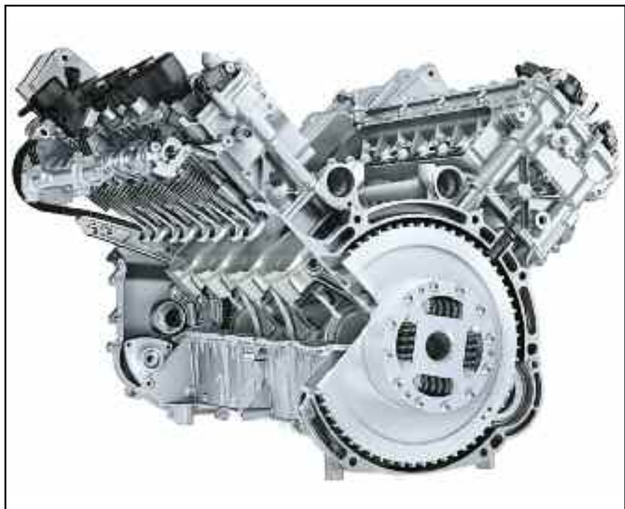
Motor térmico V8 de nafta/gasolina, del tipo atmosférico de 4,6 litros y 608 CV. de potencia efectiva.
