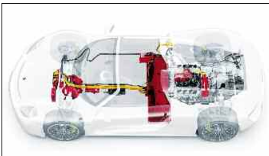
La parte híbrida está compuesta por tres motores; uno de combustión interna de 608 CV., y dos eléctricos, el delantero de 129 CV., y el trasero de 156 CV. La potencia acumulada es de 887 CV., y las baterías son de Ion-litio.
