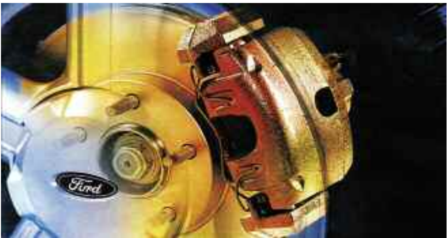
Las pinzas de serie deben ser compactas, y de bajo costo, y debido a ello, casi siempre son del tipo flotante – Ford.
