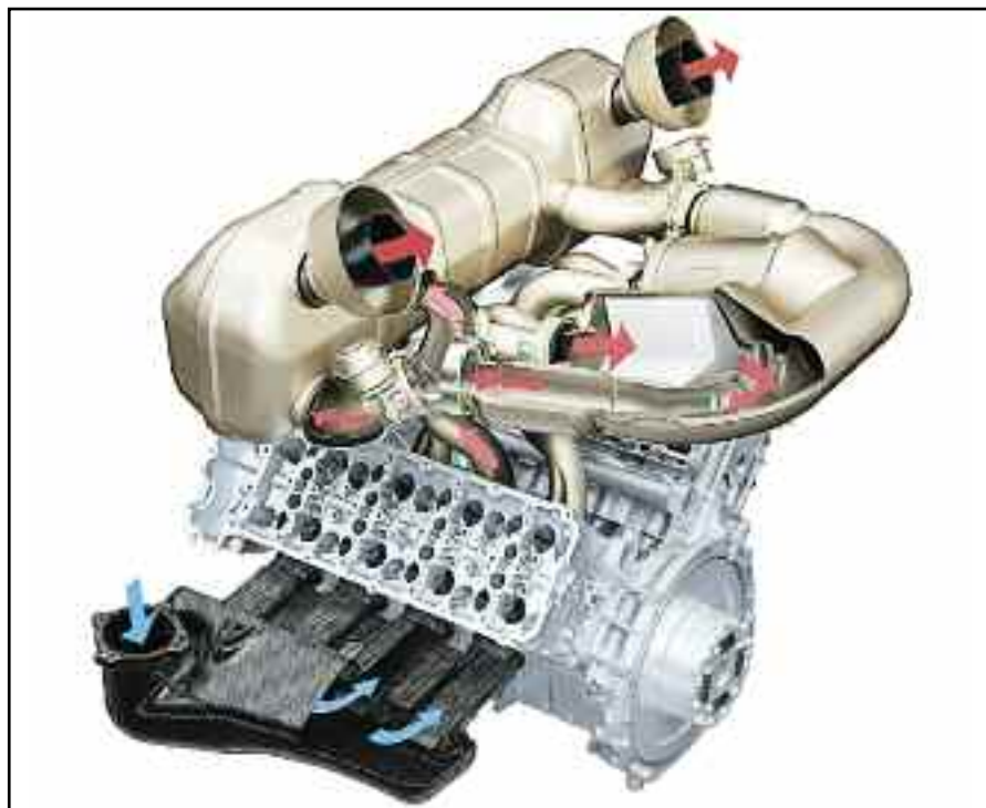
Sistema corto de escape, del motor naftero de 8 cilindros con salidas orientadas hacia arriba, para alejar los gases calientes de las baterías.
