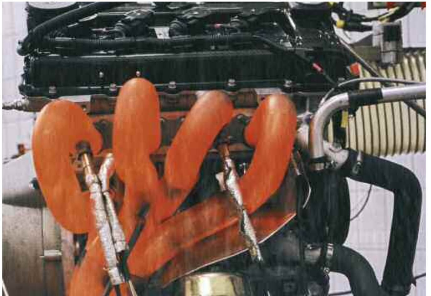
Motor sobre banco de pruebas dinamométrico, con el sistema de escape en color rojo cereza, debido a las exigencias.
