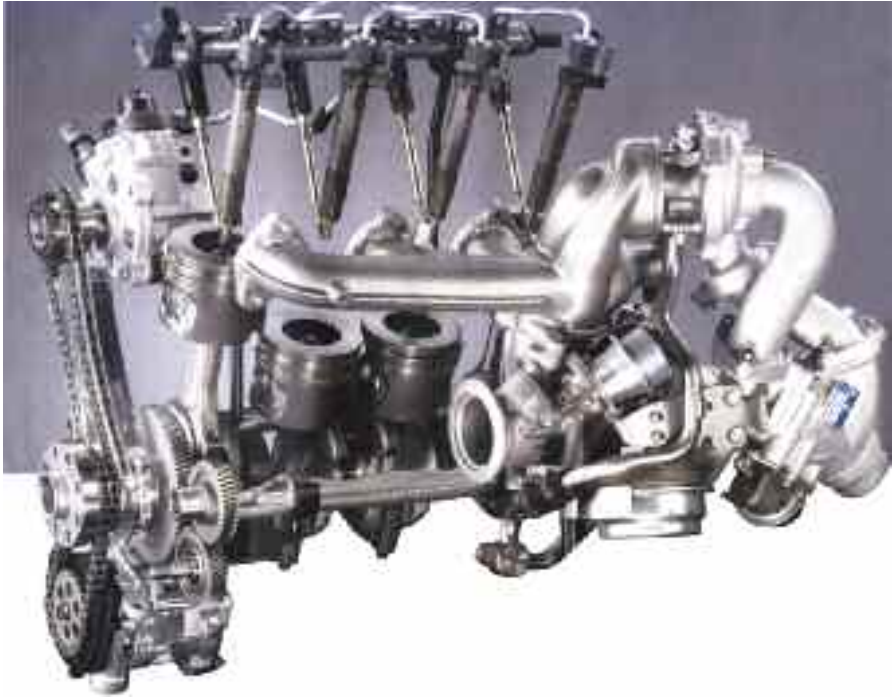
En la actualidad, se construyen motores Diesel, con sobrealimentación múltiple, es decir doble o triple turbo con inyección de gasoil “Common rail”, e inyectores piezo-eléctricos- BMW.
