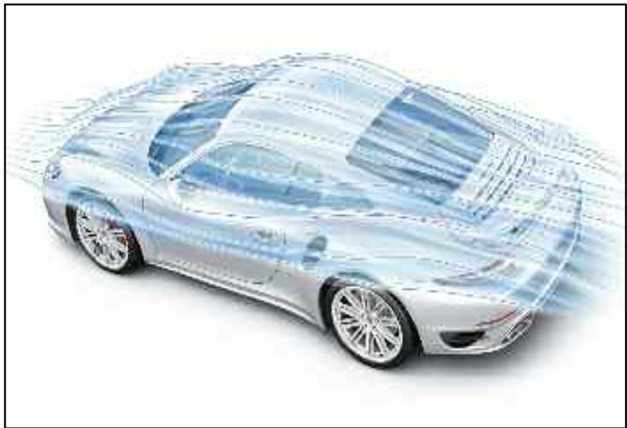
La aerodinámica toma real importancia, con el aumento de la velocidad, ya que la resistencia del aire depende del cuadrado de la velocidad.
