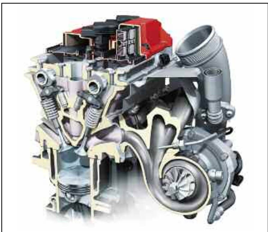
Detalle del turbo conectado al conducto de escape - Audi.
