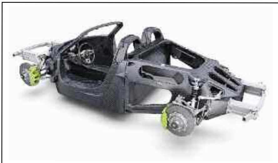
La estructura portante en su núcleo, está construída en fibra de carbono, completada por dos falsos chasis de aluminio.
