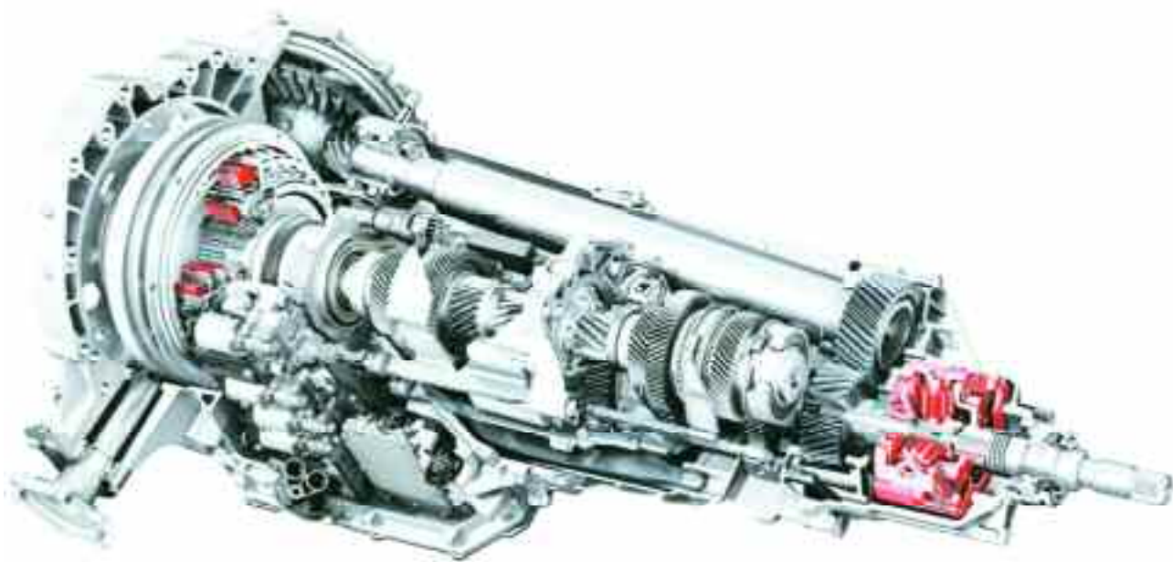
Caja automática S. tronic con doble embrague y diferencial, del modelo A6-Audi.
