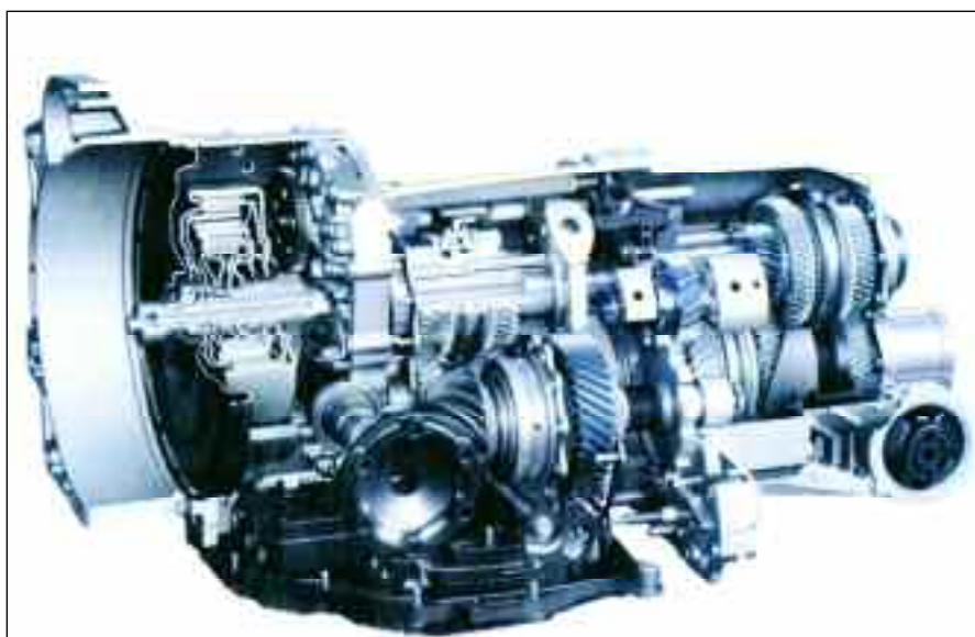
La caja de velocidades denominada PDK, posee un sistema de doble embrague, en donde los cambios son instantaneos, es decir que se concretan a gran velocidad – Porsche Carrera.
