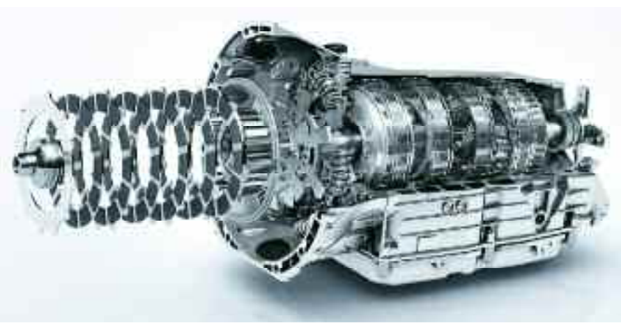
Caja de velocidades automática con embrague de discos múltiples, del tipo MCT (Multi Clutch Technology) – M. Benz.
