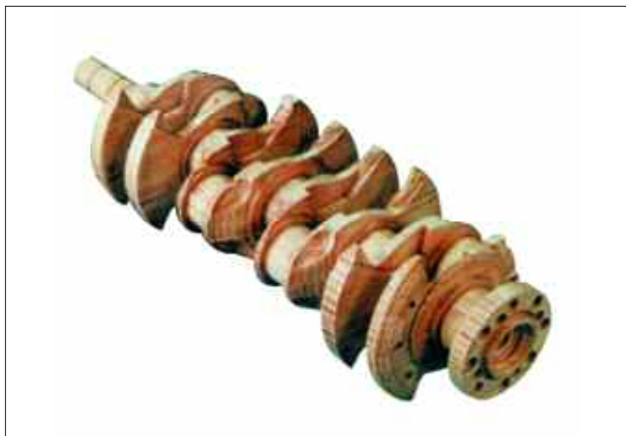
Con los componentes diseñados con el sistema CATIA, los ingenieros pueden fácilmente realizar simulaciones computadas. Prototipo de cigüeñal, construido en pocos días, en papel laminado.
