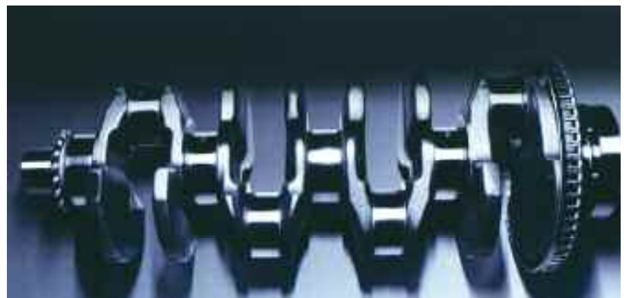
Los amortiguadores o anti-vibradores son montados sobre el cigüeñal, para absorber la energía del momento de excitación – Audi.
