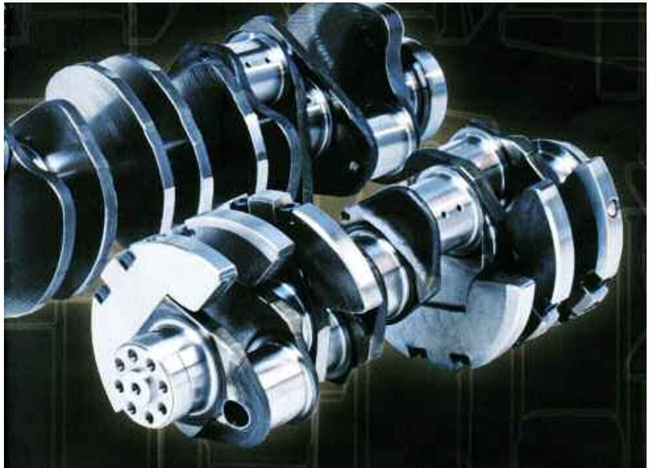
El cigüeñal gira a gran velocidad, y por eso deberá estar bien equilibrado, con respecto a las fuerzas rotativas y al “par motor” producido por esas fuerzas – AMF/Sanz.
