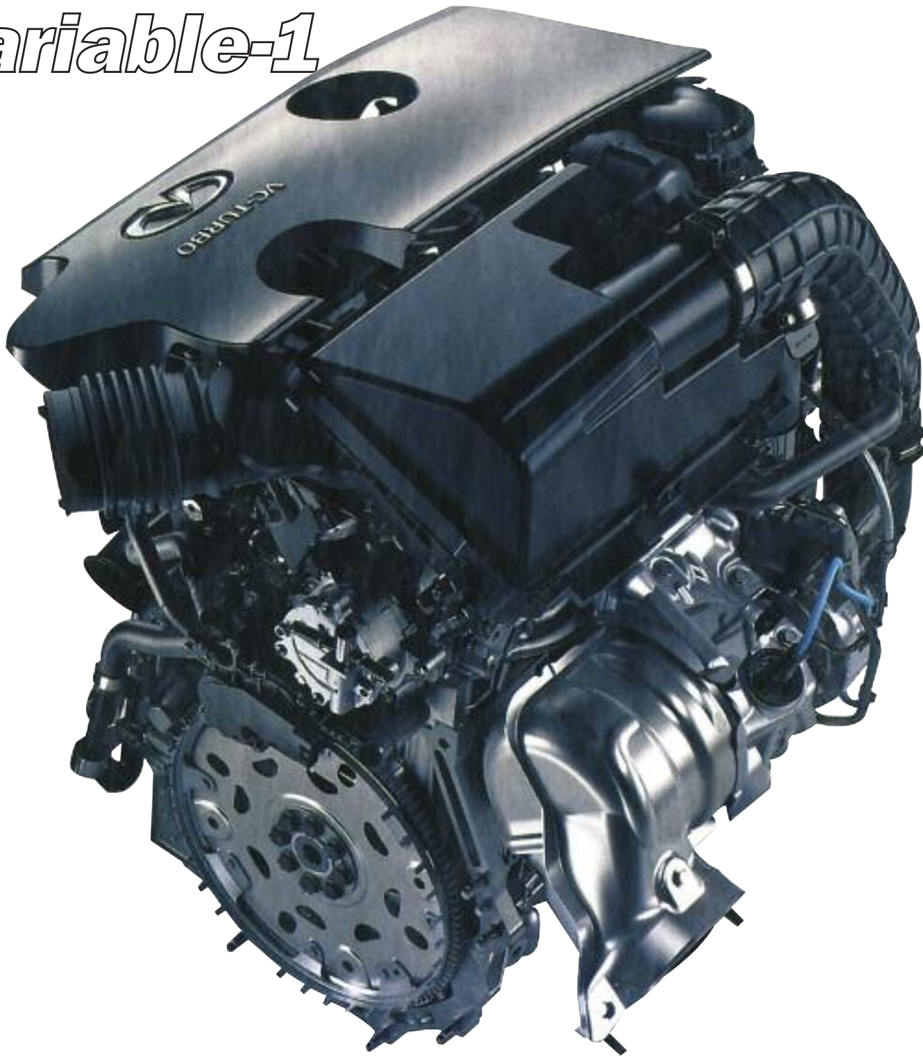
Motor V6 con mecanismo de Relación de Compresión Variable que varía entre 8:1 y 14:1, de 3,5 litros, desarrollado por Infiniti. - Nissan.
