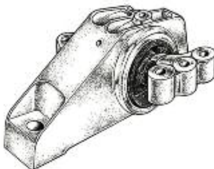
2381 (51921213) Soporte de motor (lado derecho) Strada, Grand Siena 1.6 16 V motor E-Torq
