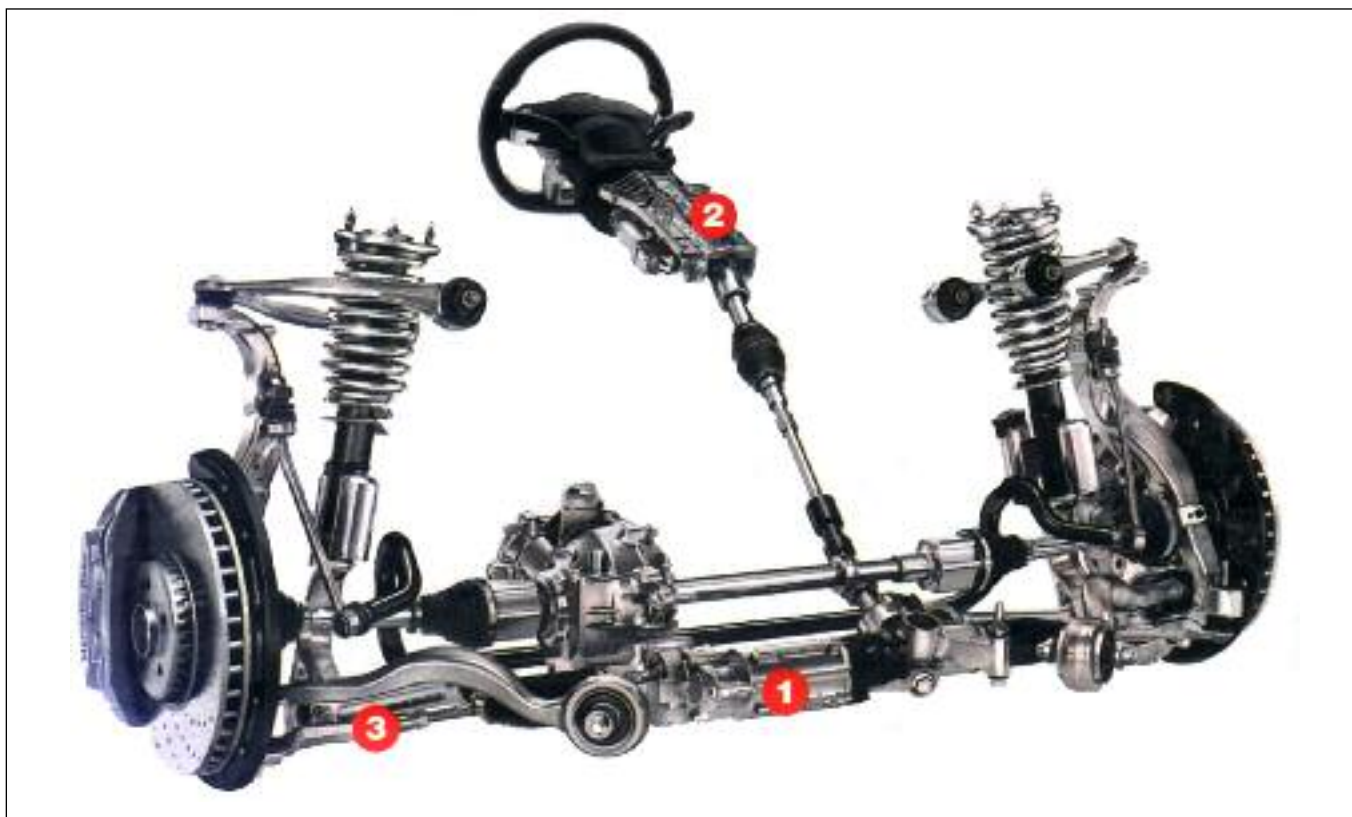
Conjunto de dirección eléctrica de la M. Benz Clase C.: 1- Caja de dirección con electromotor. 2- Columna de dirección eléctrica. 3- Extremos de dirección.
