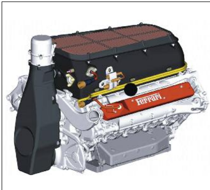
Motor de 10 cilindros en V a 90 grados, Ferrari es un equipo que siempre produjo sus propios propulsores.
