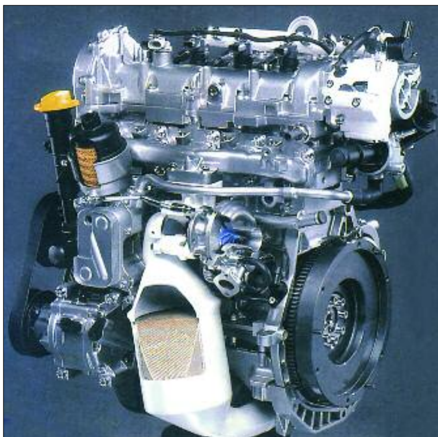
Motor Diesel “downsizing” de baja cilindrada, diseñado para reducir los tenores contaminantes - Fiat 1.3 Multijet.
