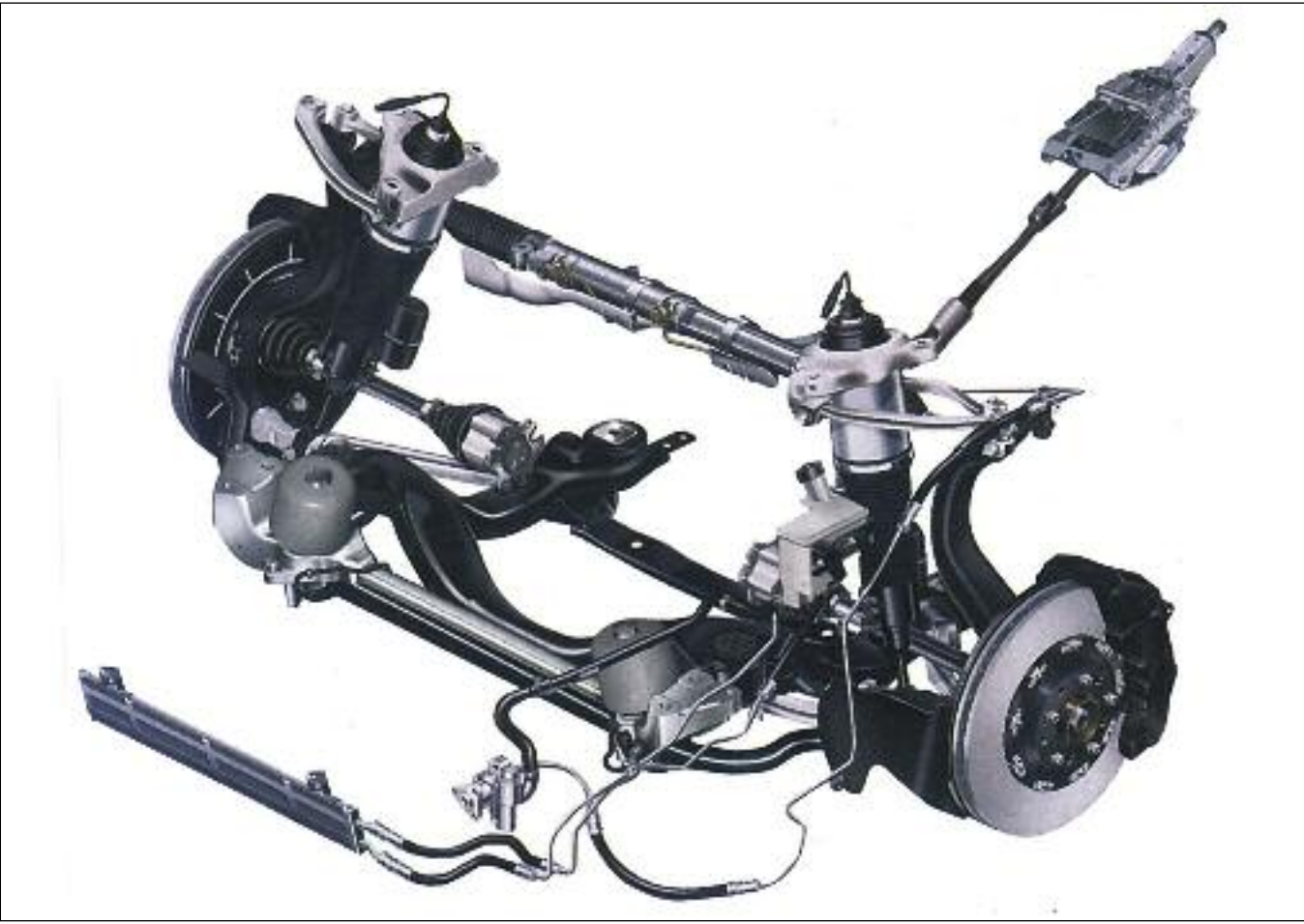
La relación de transmisión entre el piñón y la cremallera, es pensado para lograr una multiplicación de la fuerza que aplica el conductor.
