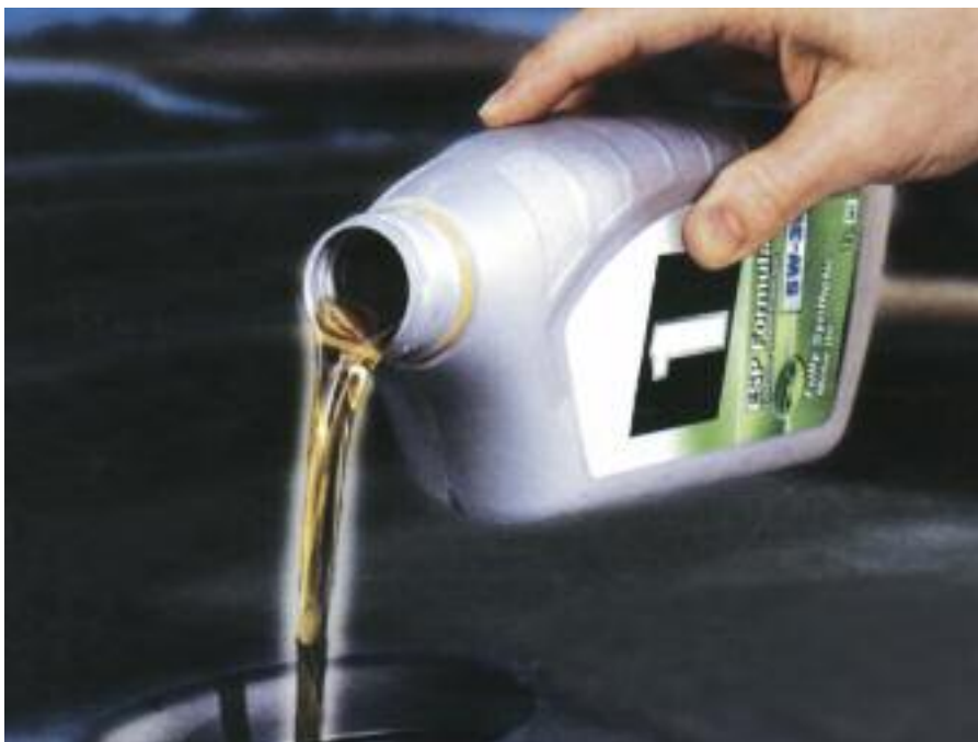
Los aceites tienen además la función de enfriar a los componentes o piezas en movimiento, mantener limpios los mecanismos, proteger contra la corrosión, y mejorar la estanquidad.
