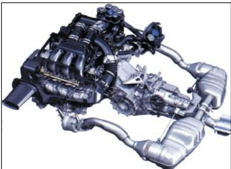
Motor central de aluminio tipo boxer, con 4 árboles de levas a la cabeza, 4 válvulas por cilindro, y distribución del tipo variable VarioCam Plus, inyección electrónica MPI, con 3.386 cm 3 de cilindrada (96 mm x 78 mm) y 295 CV de potencia, con 340 Nm de par motor máximo.
