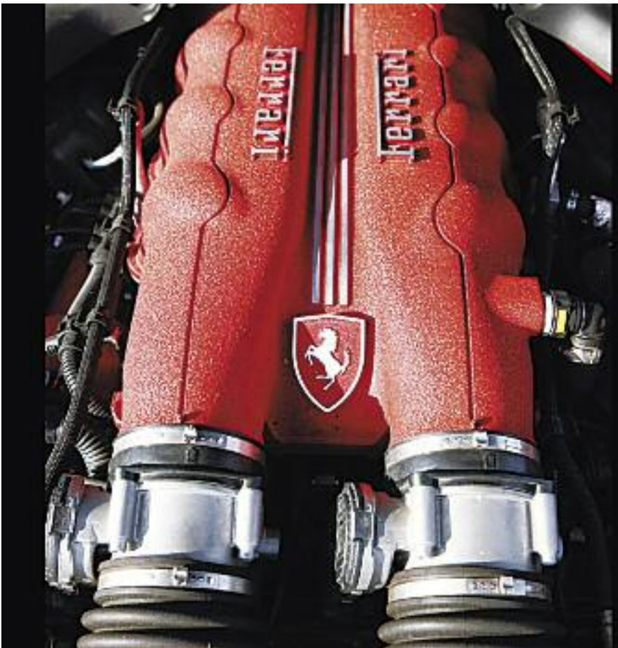
El V8 de 4,3 litros, se ubica en la posición longitudinal delantera, y es la primera vez que la casa del Cavallino monta un 8 cilindros en V de inyección directa adelante.
