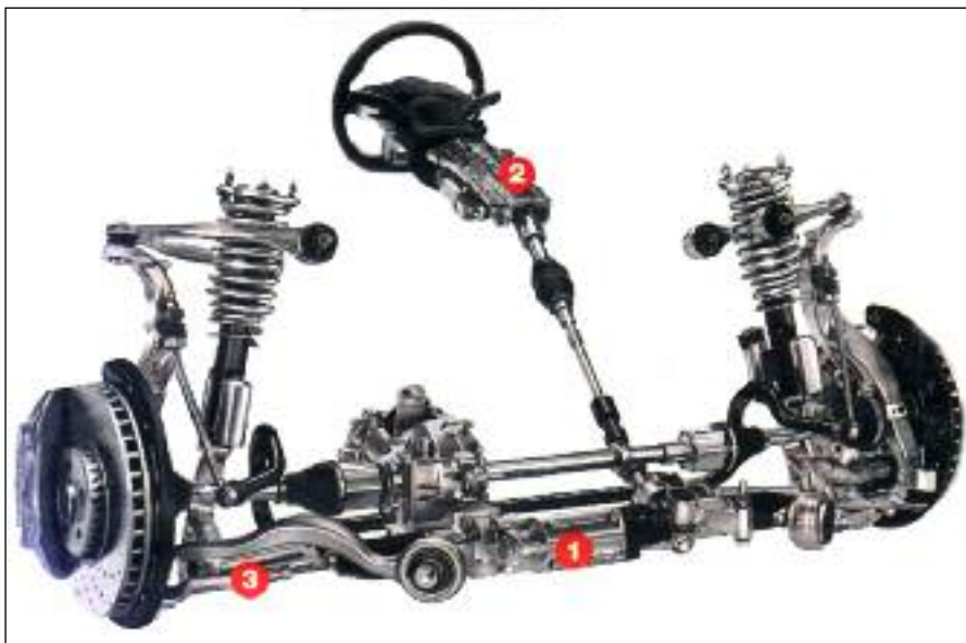
Conjunto de dirección eléctrica de la M. Benz Clase C.: 1- Caja de dirección con electromotor. 2- Columna de dirección eléctrica. 3- Extremos de dirección.
