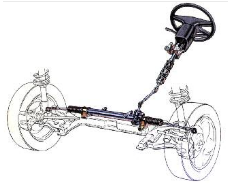
La caja de dirección transforma el movimiento rotativo en lineal.
