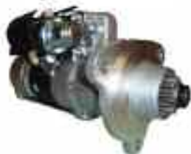
Motor M93R - 24v - 5 kw Enganche suave
