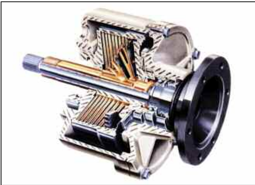
Diferencial autobloqueante viscoso tipo Ferguson - Alfa Romeo.
