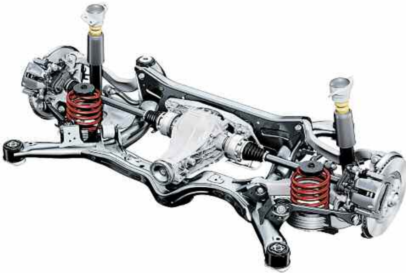
Suspensión trasera moderna trapezoidal "multilink", es decir de brazos múltiples con amortiguadores telescópicos y resortes helicoidales - Audi.
