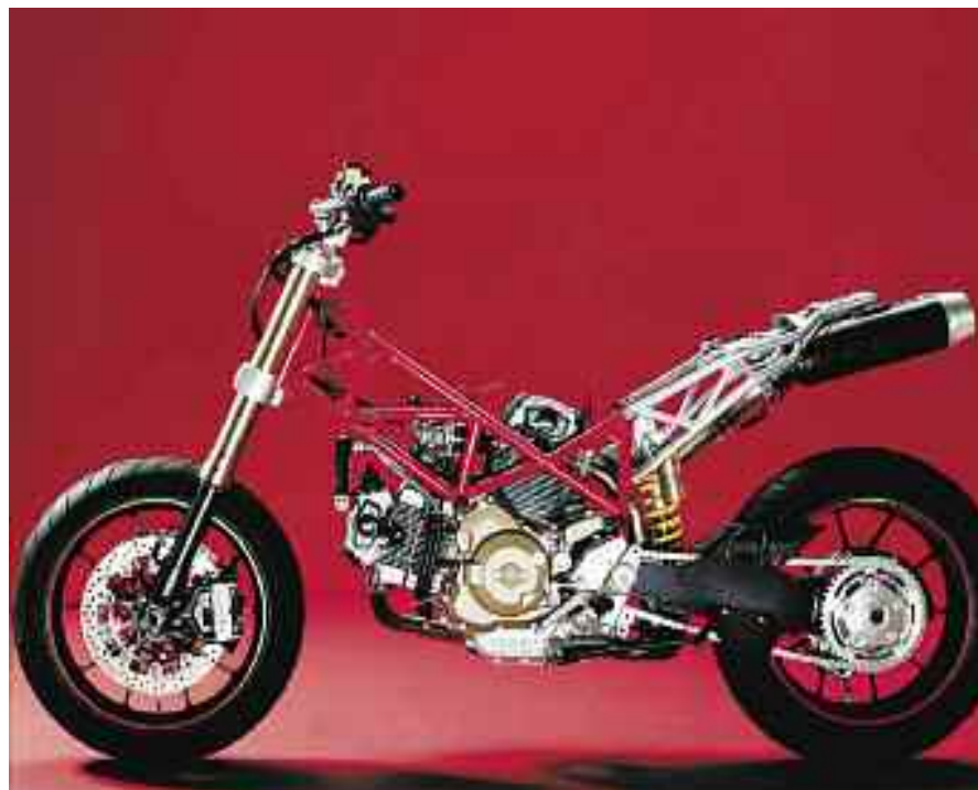
En el chasis se han ahorrado peso al eliminar piezas y refuerzo de chapa estampada.
