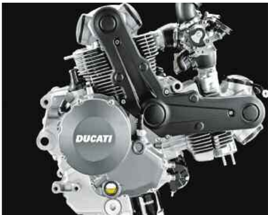
El motor de la Ducati 796 ,2 cilindros en V90° aire/ aceite SOHC Desmo 4V.
