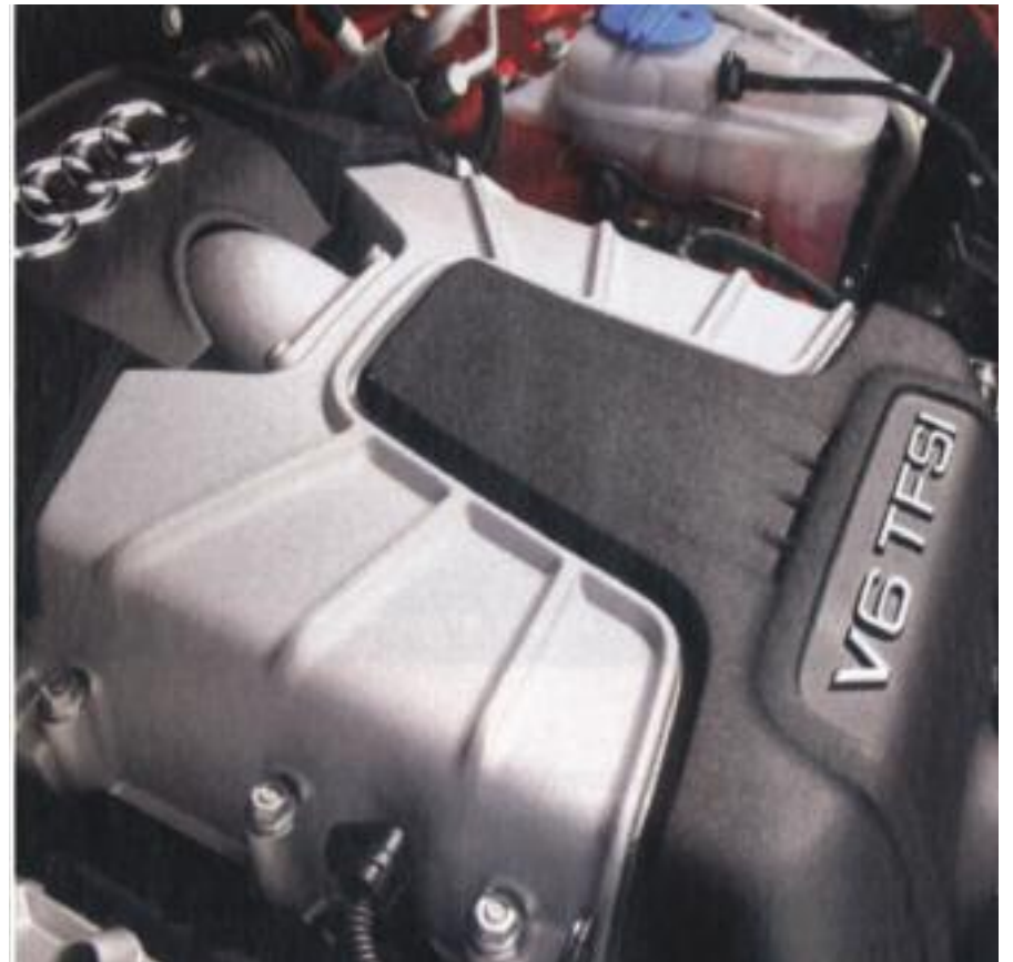
Motor V6, 24 válvulas con compresor, del tipo TFSI de 2.995 cm 3 con 333 CV a 5.500 rpm de máxima potencia – Audi S4.
