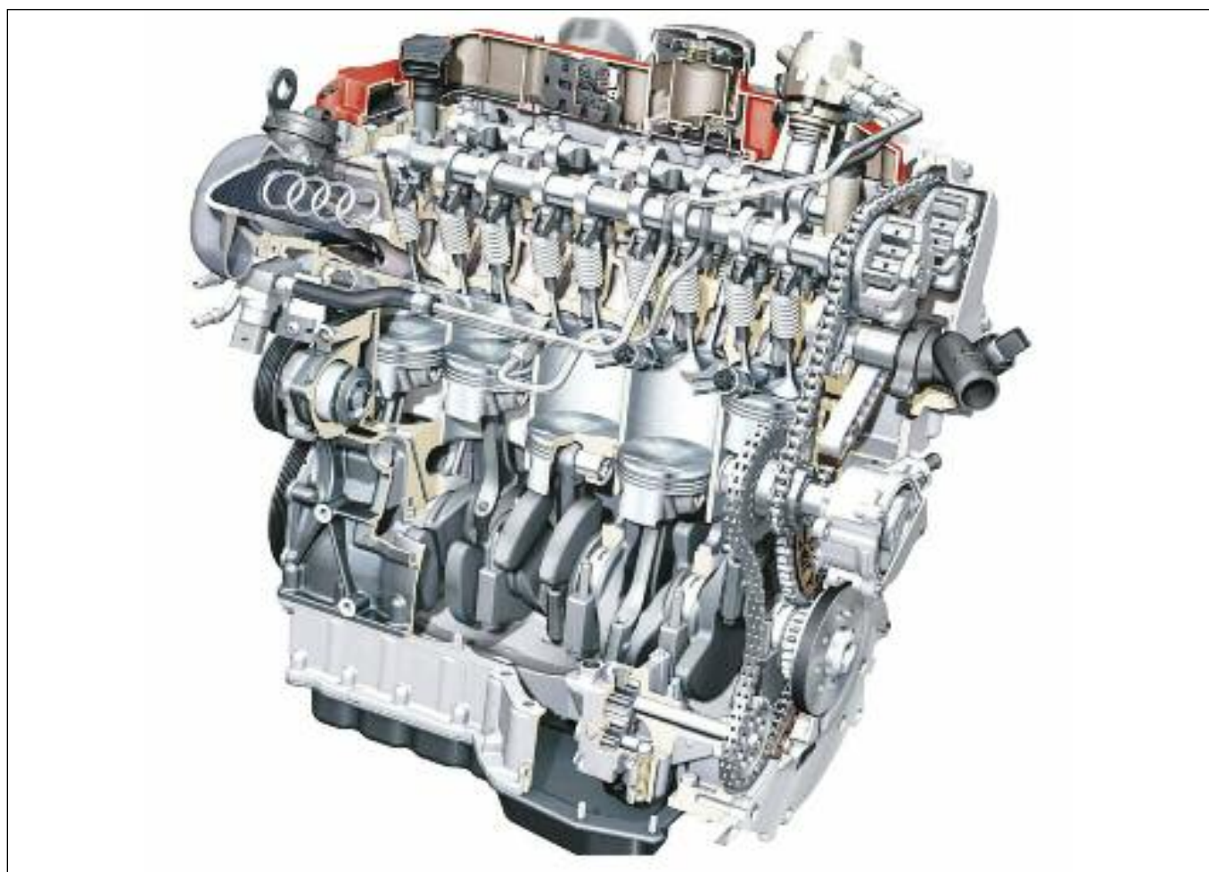
Motor de 5 cilindros en línea, turbo a inyección directa de nafta de alta presión FSI – Audi TT RS.
