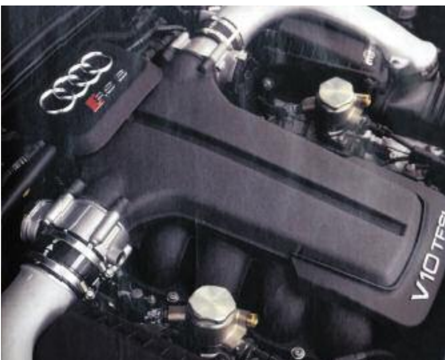
Motor V10 a 90 grados TFSI, inyección directa con 2 turbos e intercooler aire/aire, y potencia máxima de 700 CV a 6.360 rpm – Audi MTM RS6.
