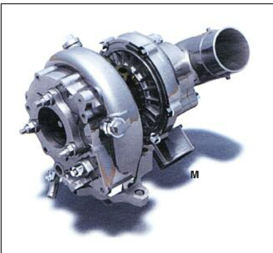
Vista exterior del turbo de tipo TGV (Turbo de Geometría Variable) con activamiento eléctrico de los álabes. Esto permite a la Unidad de Control Electrónico del motor, variar la geometría en la turbina de modo más preciso y progresivo – Toyota. M: Motor eléctrico de corriente continua.
