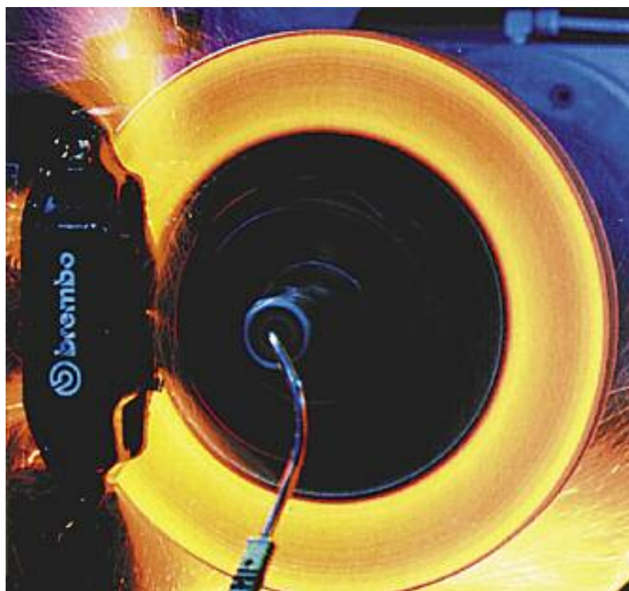
Ensayo de choque térmico en banco dinamométrico – Brembo.
