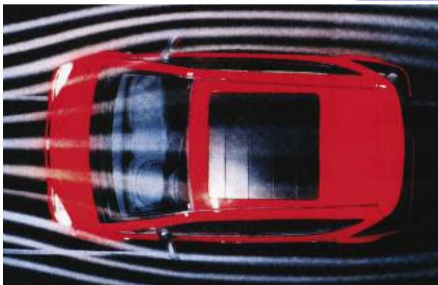
El flujo de aire que se genera alrededor del vehículo es muy importante para la estabilidad, sobre todo para un auto como el Mercedes Benz A, de poco largo total.
