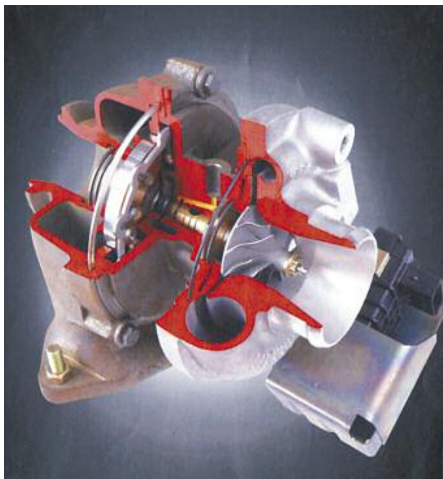
Turbosobrealimentador en corte tipo VNT o TGV, de geometría variable. A pesar de tener un concepto diferente, este tipo de turbo está sustentado en el mismo criterio de mantenimiento preventivo indicado para los turbos convencionales.
