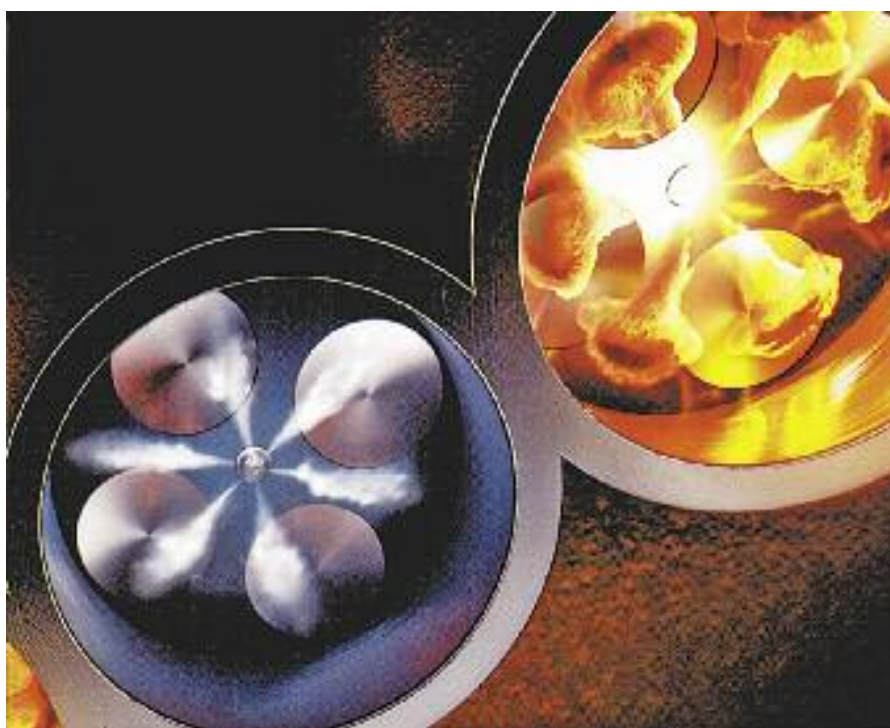
Detalle de los chorros de pulverización de los piezo-inyectores, del sistema de inyección directa "Common rail" con presiones elevadas. Con este sistema se logran excelentes niveles de potencia y par motor, consumo contenido y reducción de las emisiones.
