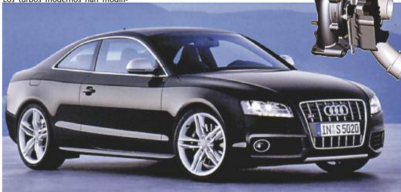
Audi A5 con motor Diesel de inyección directa –inyector/bomba– de 3.0 litros y 240 HP a 4000 rpm de potencia, turbosobrealimentado con un modelo GT22 VNT (variable) de tercera generación, controlado por un actuador electrónico (SREA) – Garrett.
