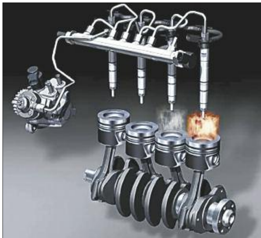
El sistema de inyección "Common rail" aportó en gran medida, al mejoramiento del proceso de combustión completa.
