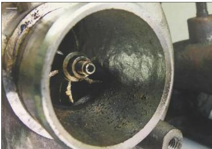
El ingreso de cuerpos extraños del exterior, produce fallas en la sobrealimentación, por rotura de los componentes.
