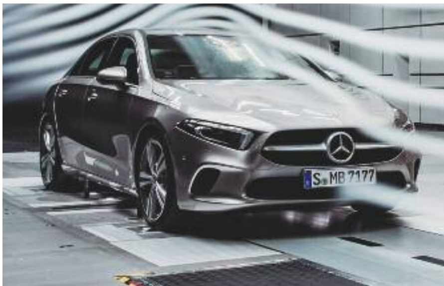
Túnel aerodinámico para escala natural. Mercedes Benz.
