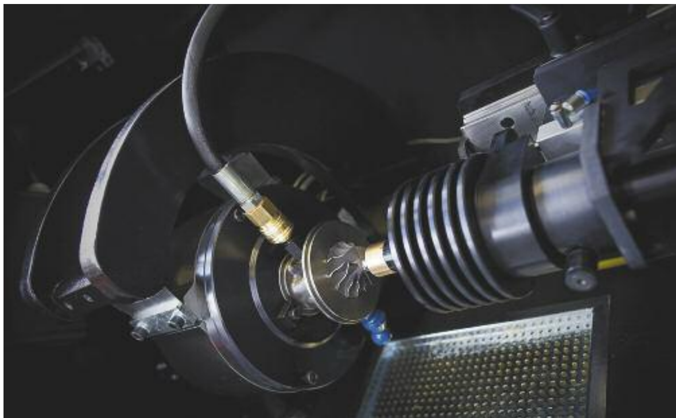
Las equilibradoras son una herramienta fundamental en la reparación del turbo, para lograr calidad y confiabilidad.
