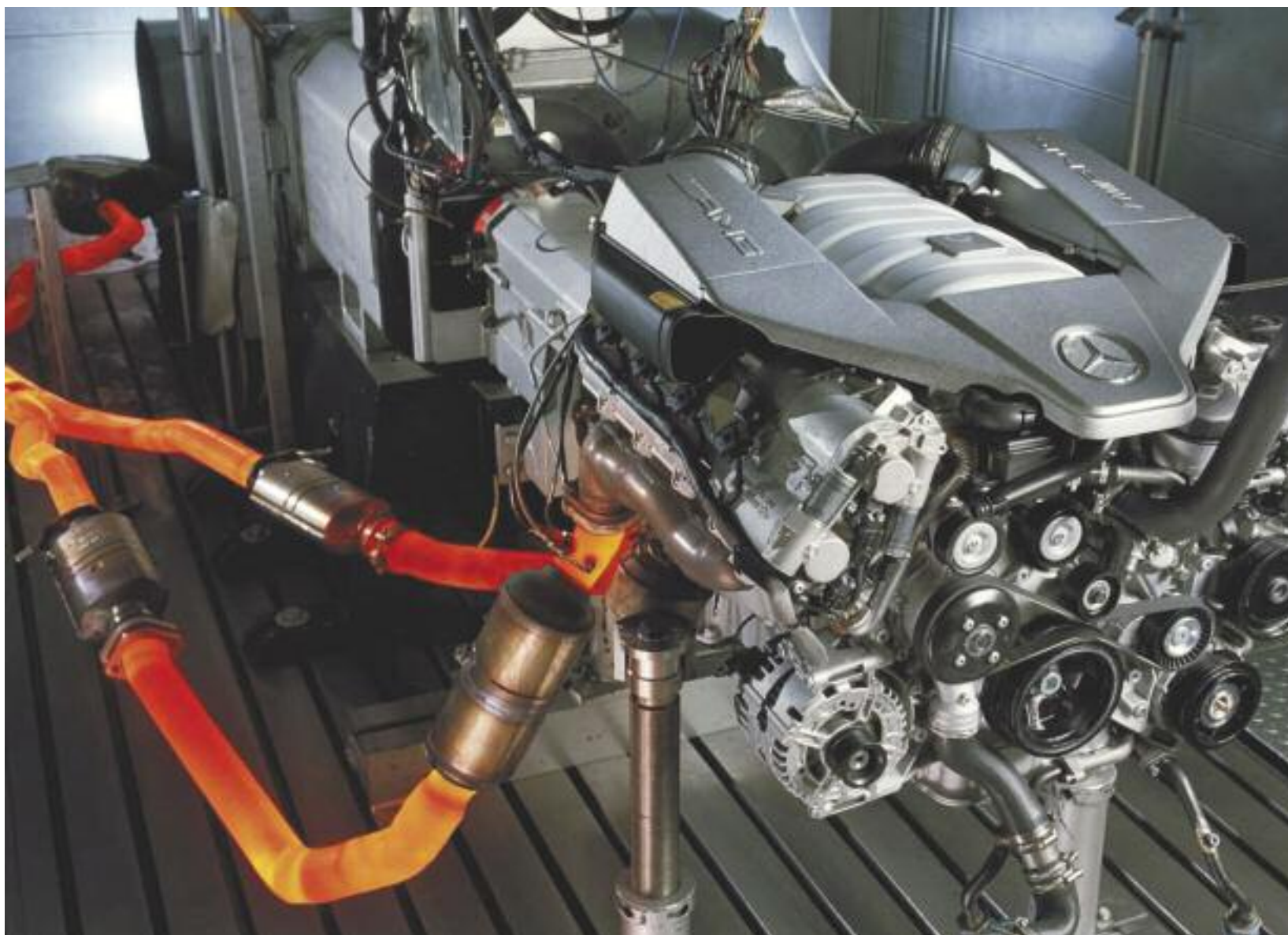
Motor de Alto Rendimiento Mercedes / AMG de 8 cilindros en V y 6.3 litros, en banco dinamométrico
