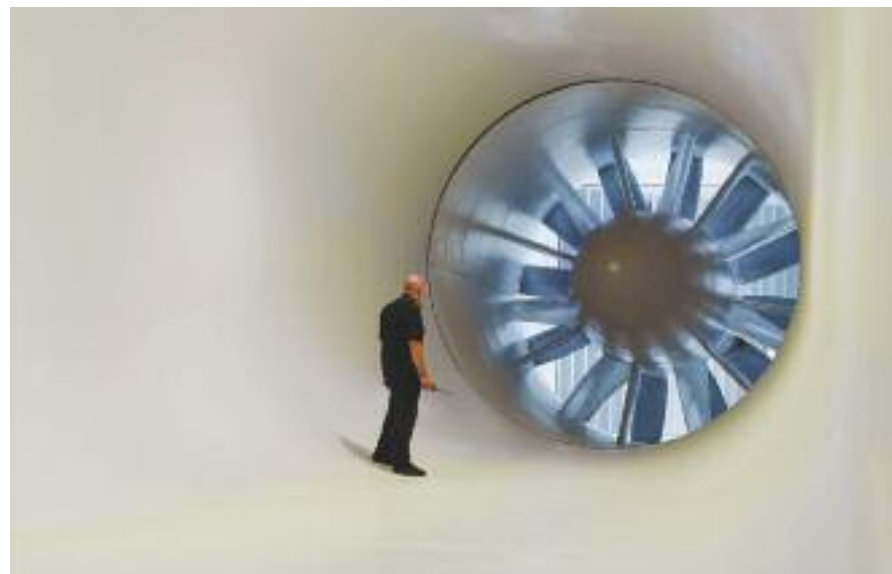
Ventilador tamaño gigante de alta potencia de túnel aerodinámico.
