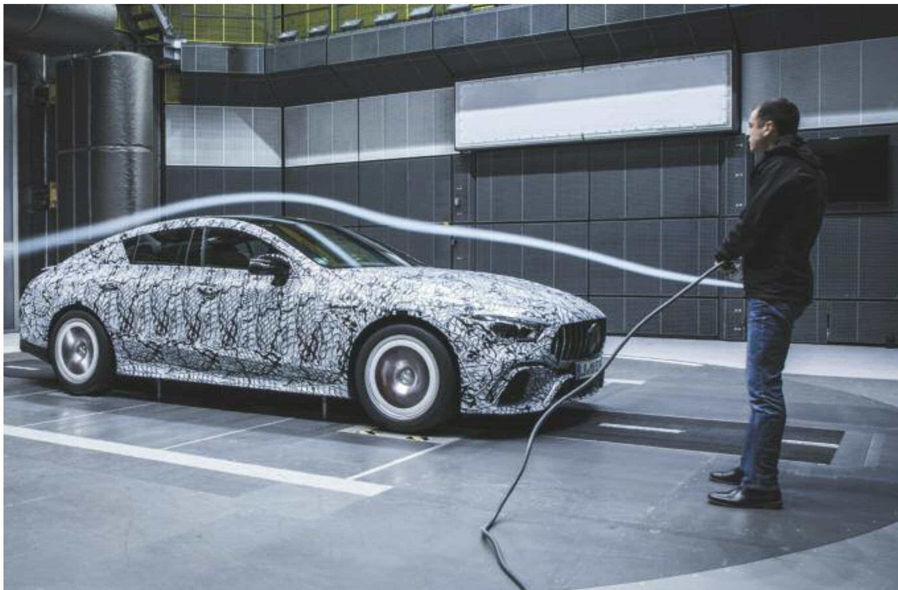
Método de los “filetes de humo” parafínico; en el túnel aerodinámico de Mercedes Benz.
