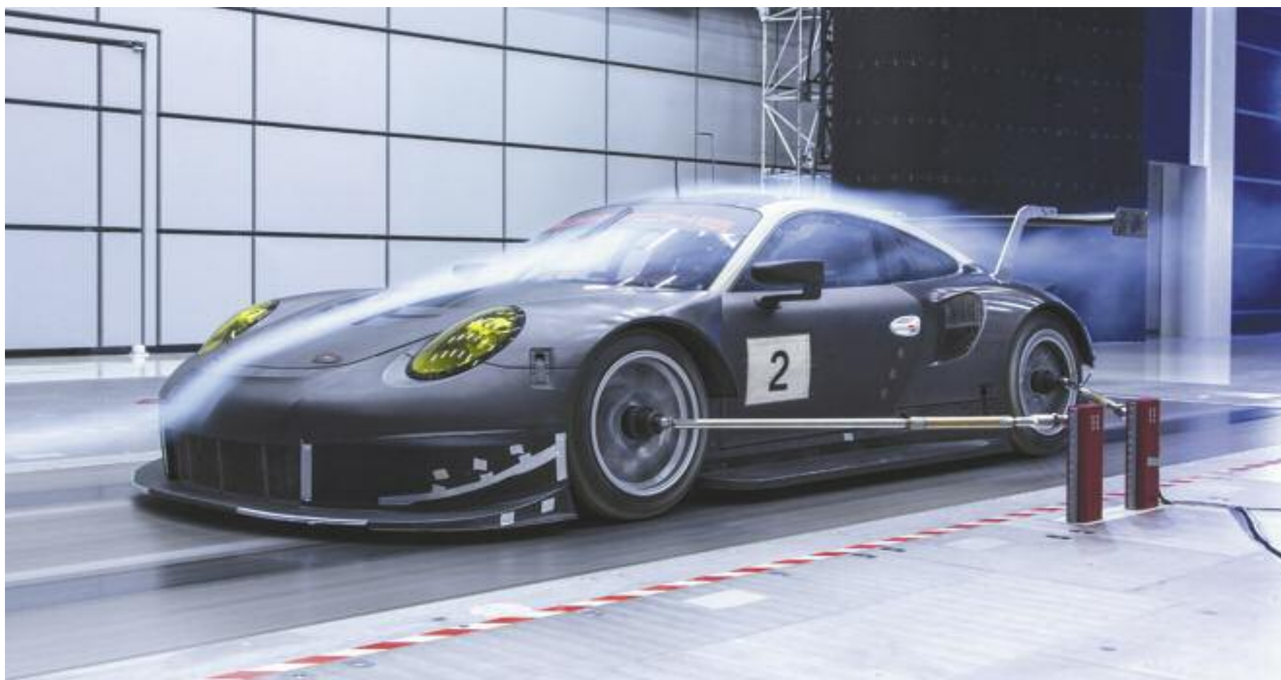
Si la resistencia aerodinámica disminuye, se necesita utilizar menos potencia, y por consecuencia el consumo es reducido.
