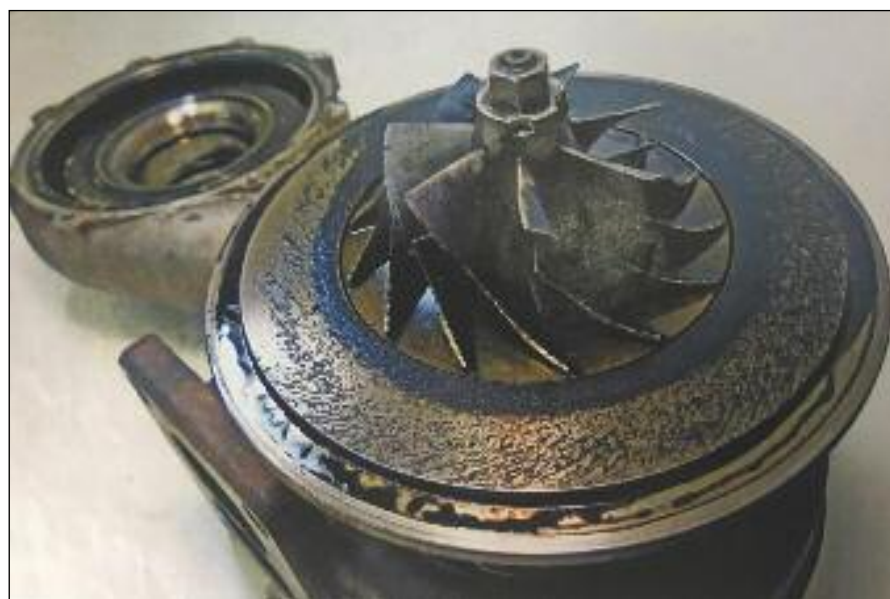
Fuerte deterioro del rotor del compresor, por problemas en el sistema de admisión del motor.
