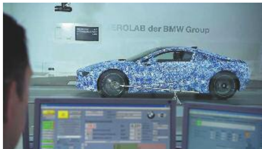
Cabina de control de pruebas de BMW-Aerolab en el túnel de viento.
