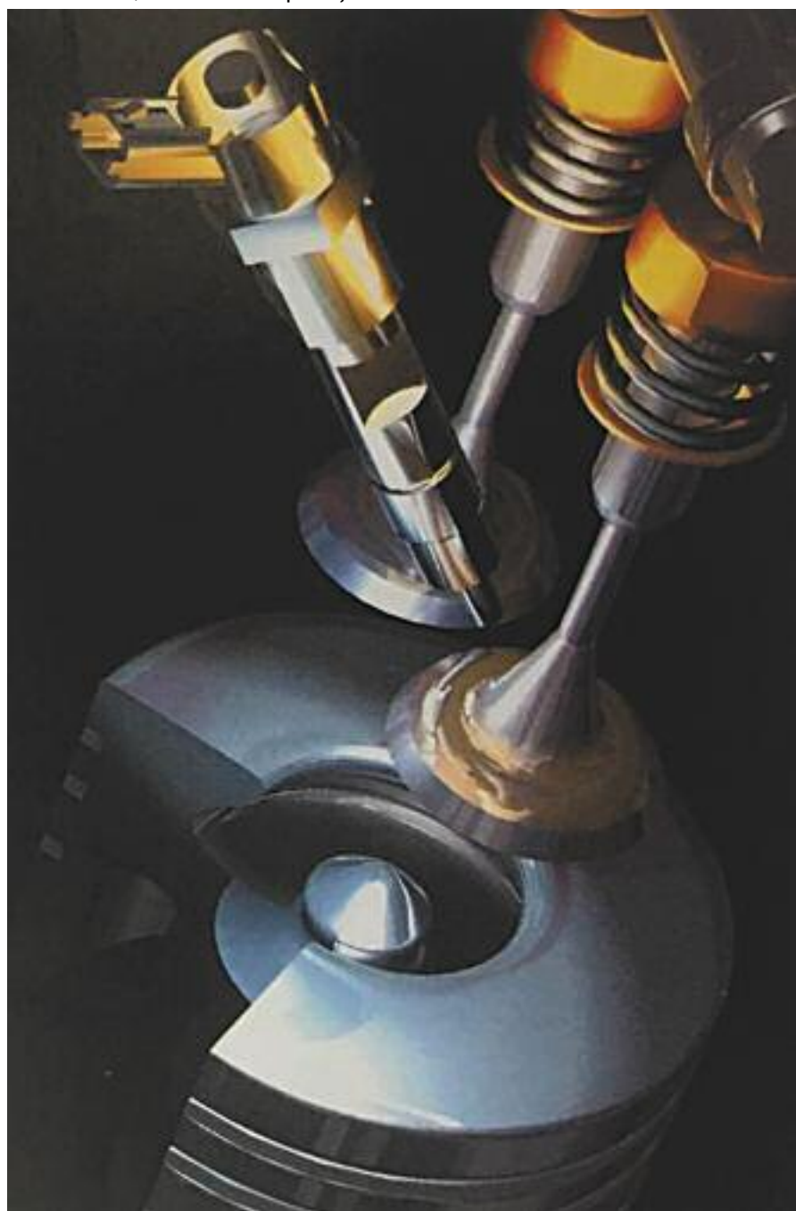
La elevada presión de inyección, genera una finísima pulverización logrando una mezcla más homogénea con el aire. Reducción de consumo y emisiones.
