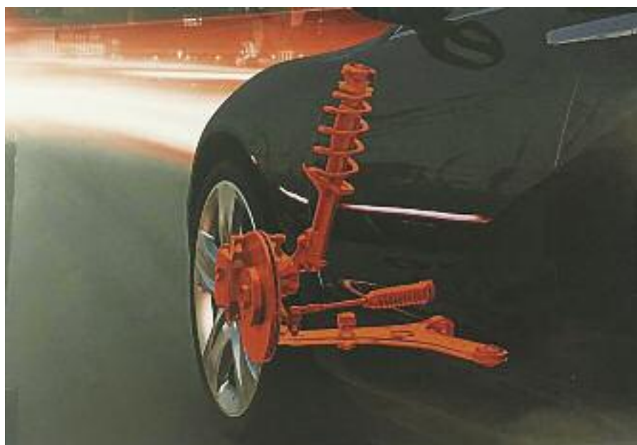
Tecnología TRW. System, compuesto por resorte, amortiguador, y brazos (kit de reparación).
