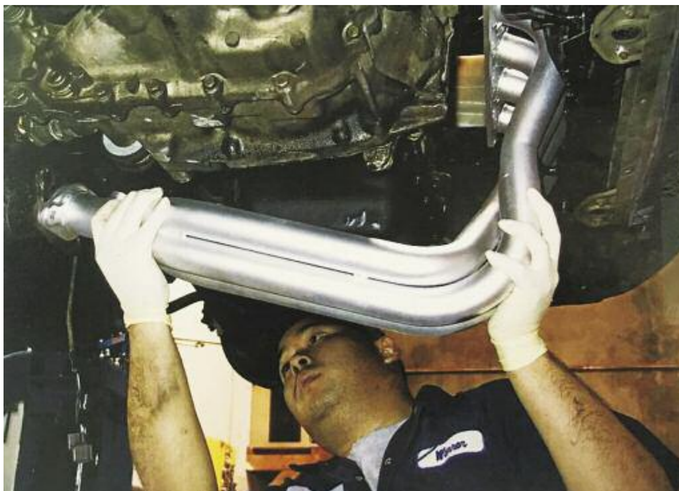
Colocación del escape; montaje especializado de un tramo del sistema –GM./Chevrolet.
