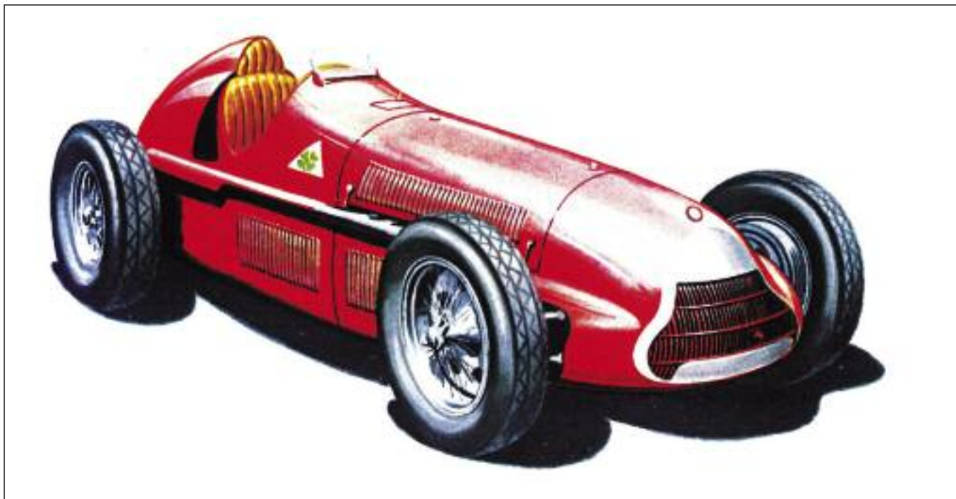
Automóviles de competición de FI: El Alfa Romeo "Alfetta" de 1940 con un motor de 8 cilindros en línea, de 1.5 litros de cilindrada total, sobrealimentado con un compresor volumétrico Roots. Los motores eran aspirados naturalmente o atmosféricos, de baja potencia, después de la Segunda Guerra Mundial, se permite la sobrealimentación, y la potencia aumenta junto con la velocidad.
