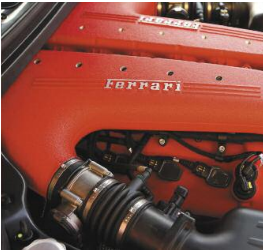
Motor V12 a 65 grados dentro del habitáculo de la GTO.
