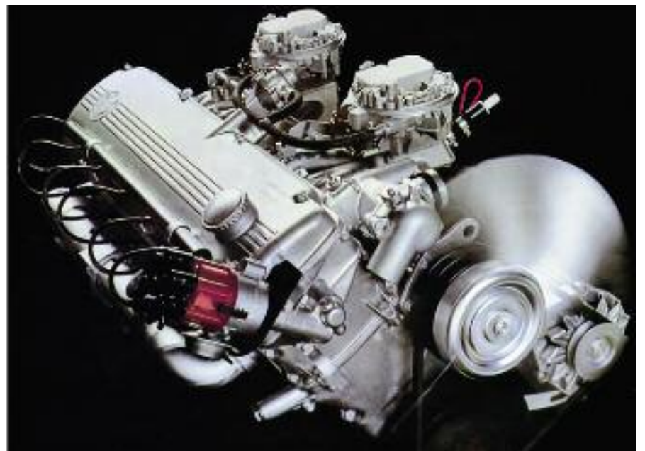
Motor BMW de 2500 cm 3 ., de funcionamiento suave como una turbina, de 6 cilindros en línea, del año 1968.
