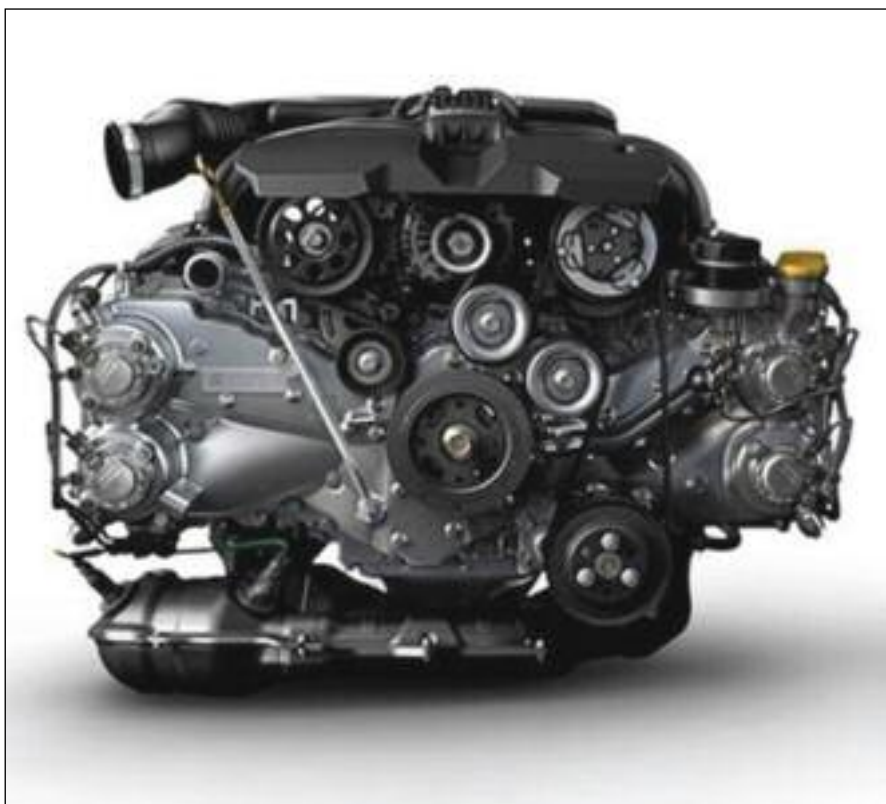
Motor bóxer de 4 cilindros, 4 tiempos, 16 válvulas de 2.0 litros de carrera larga, con una potencia de 110 CV a 6.000 rpm y un par motor de 109 Nm a 4200 rpm- Subaru.
