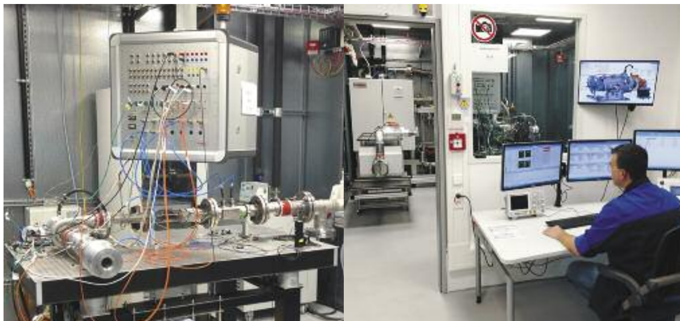
Celdas de prueba, mediciones térmicas de gases, presiones y temperaturas en distintos puntos. Salas de ensayos con bancos dinamométricos para motores de combustión interna, vida útil del turbo. –Borg Warner.
