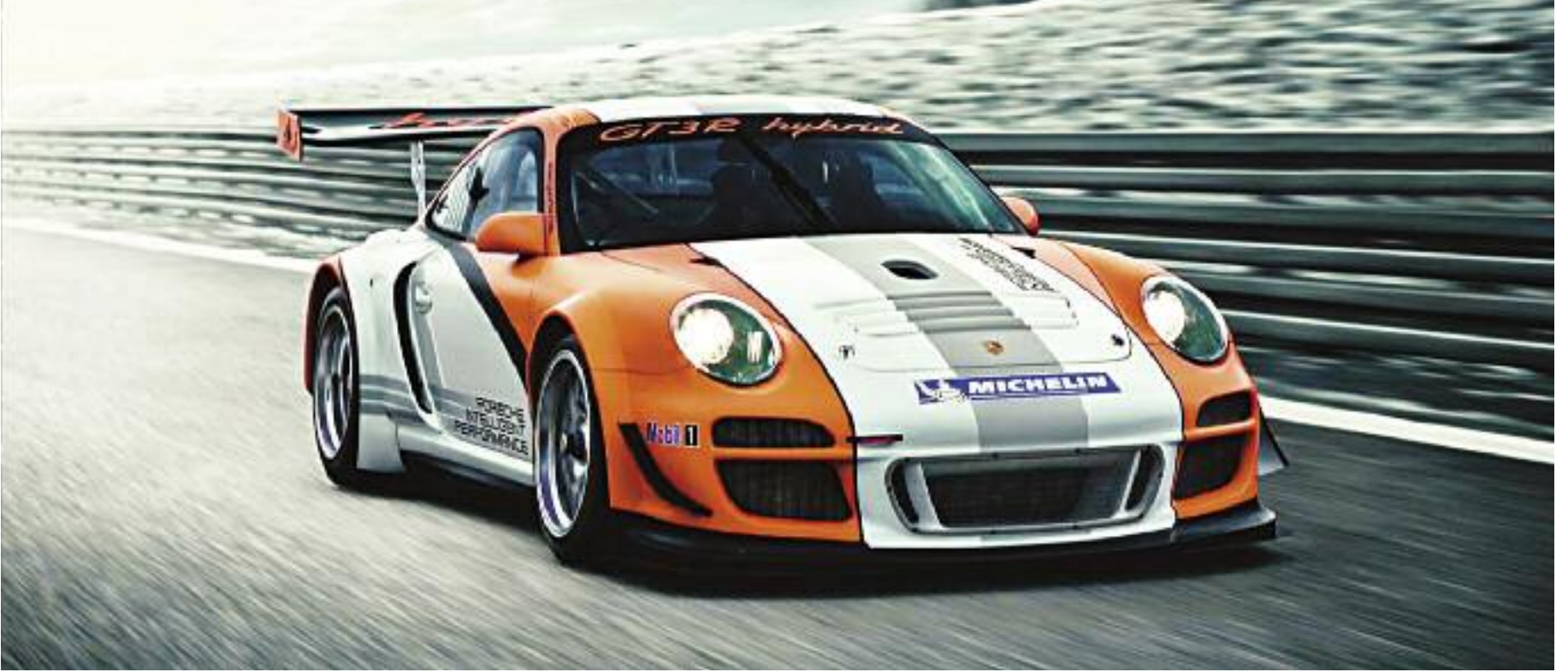
El Porsche 911 R GT3 Híbrido con motor de 480 CV de potencia máxima, cuatro litros y seis cilindros opuestos.
