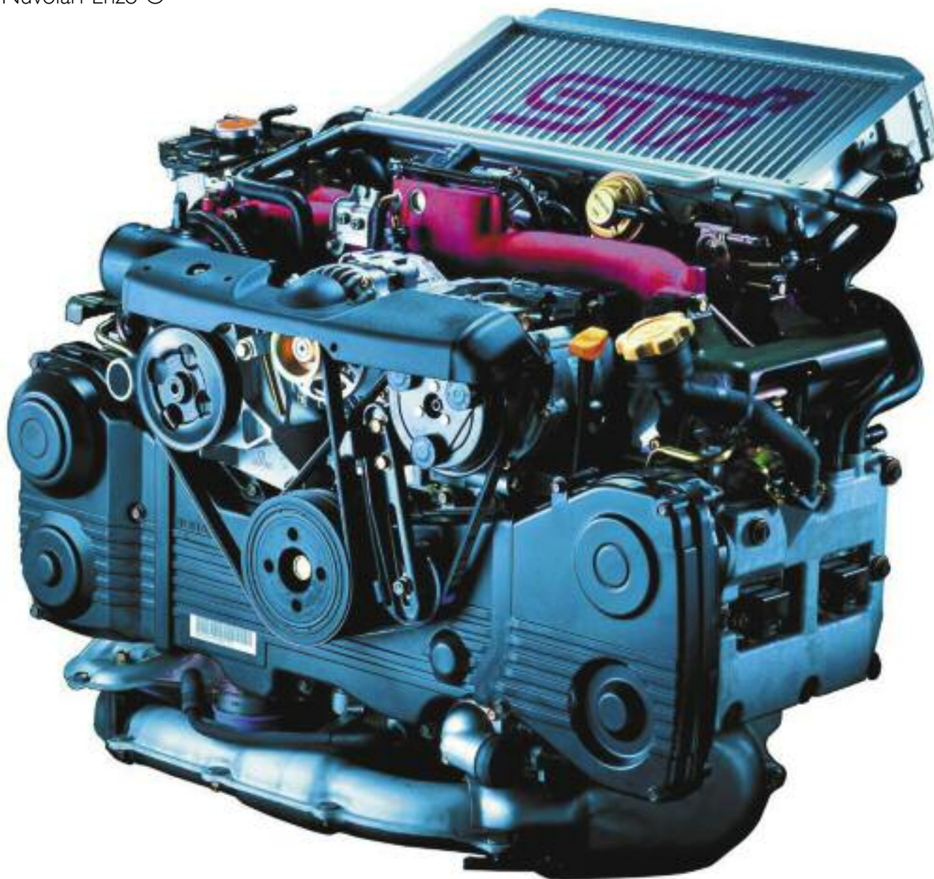
Motor de 4 cilindros opuestos, del modelo Impreza WRX STi Special - Subaru.
