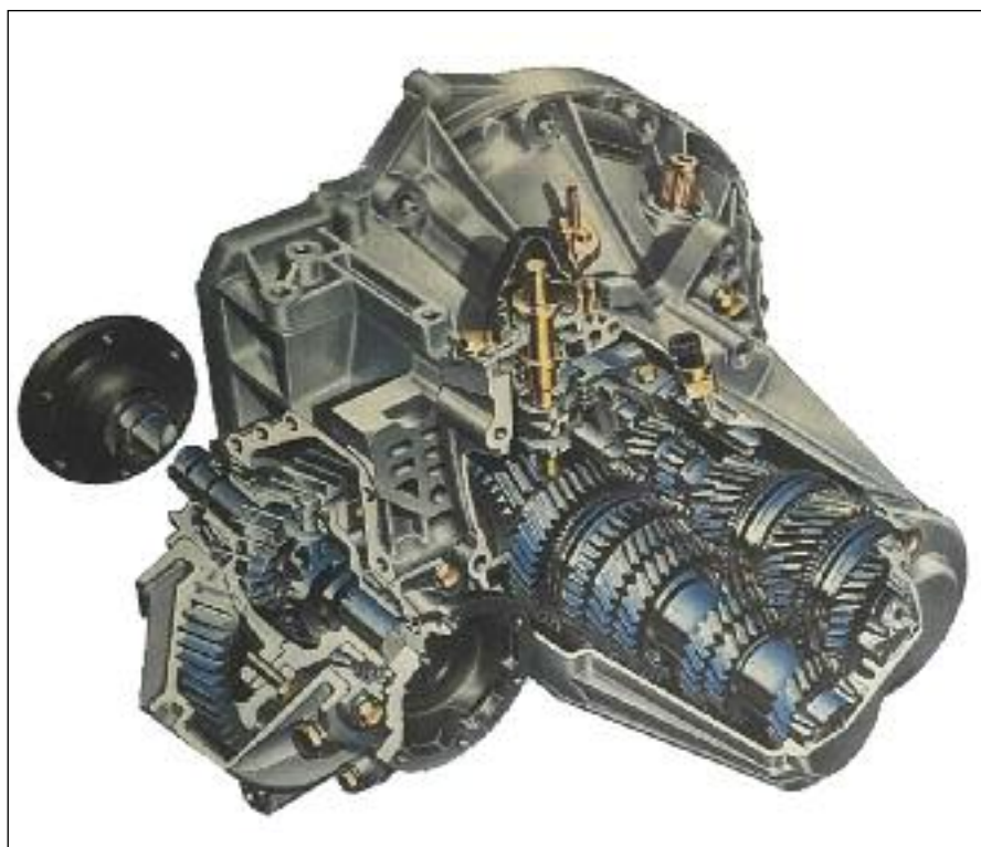
Caja de velocidades mecánica manual –formando parte de un grupo motopropulsor- de moderno diseño. –Fiat.
