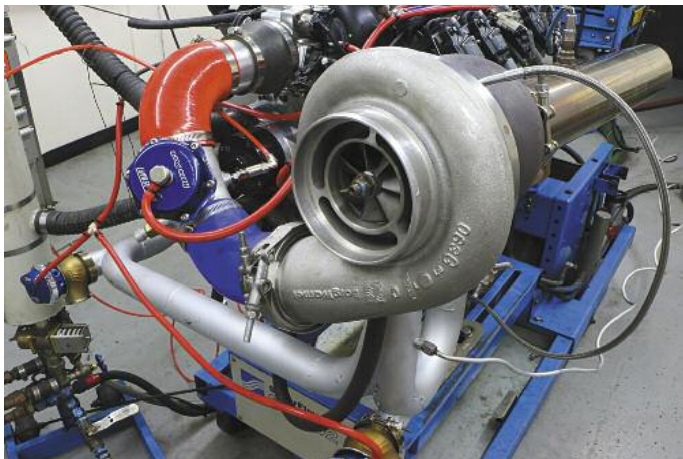
Turbo montado en motor, sobre banco dinamométrico en sala de ensayo.
