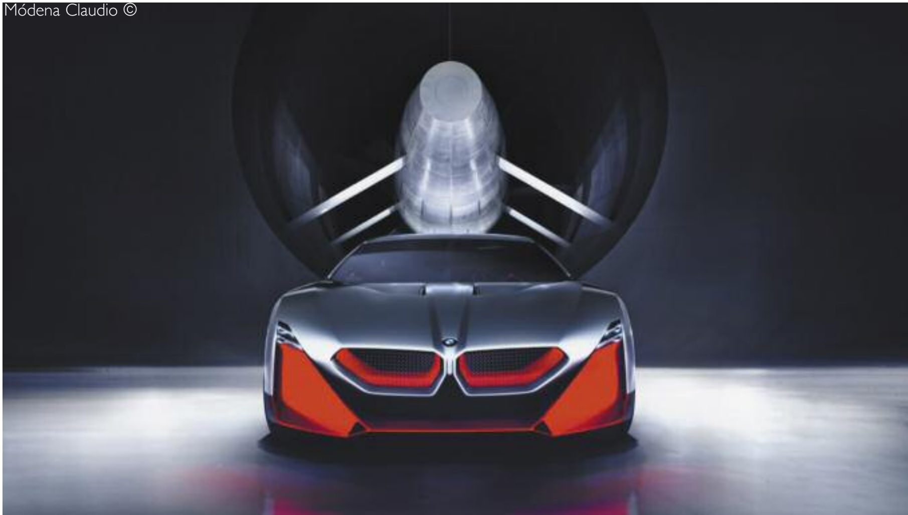
Automóvil de características deportivas, en el túnel aerodinámico, para obtener los coeficientes necesarios. –BMW.Aerolab.
