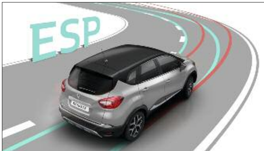
Funcionamiento del ESP en una curva a la derecha: con sobreviraje (sobredirección) actúa sobre la rueda delantera externa, y produce un efecto de rotación del automóvil –sobre su eje–, estableciendo la trayectoria normal. Con subviraje (subdirección) actúa sobre la rueda trasera interna, generando también un efecto de giro, pero en sentido contrario.
