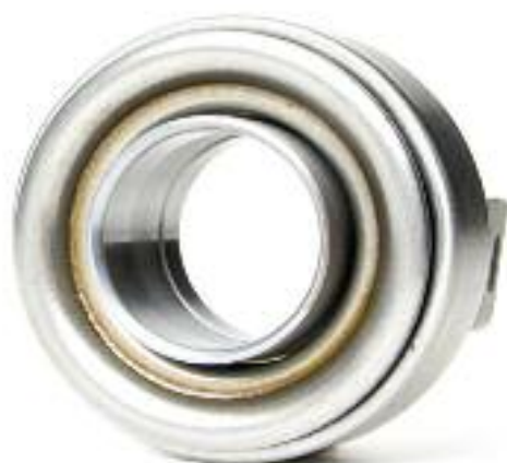
Fig. 1: Los cojinetes de desembrague con casquillo de metal deben engrasarse con lubricante
