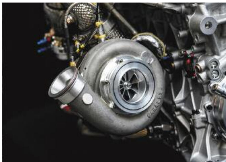
Motor de 4 cilindros y 610 CV.de potencia, detalle de la instalación del turbo.
