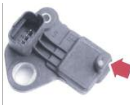
Sensor de régimen y posición del cigüeñal de efecto Hall.
