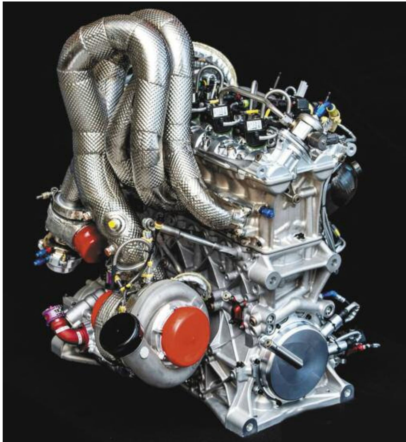
Vista exterior del motor de la Categoría DTM, de 4 cilindros en línea, turbo-intercooler, de 2.000 cm 3 .de cilindrada total.
