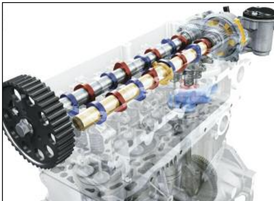
El diagrama de distribución ideal, depende de las condiciones de funcionamiento del motor, y es función del régimen de velocidad. El sistema de "distribución variable", está diseñado en cumplir para cualquier condición de funcionamiento - Volkswagen.
