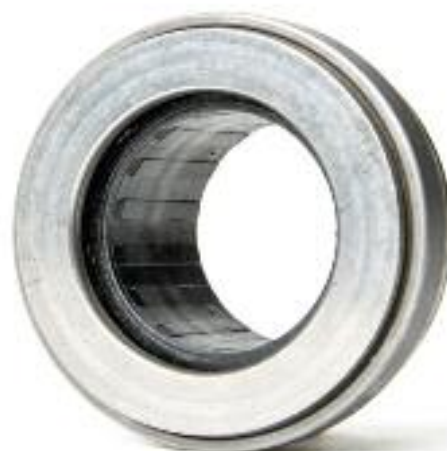
Fig. 2: Los cojinetes de desembrague con casquillo de plástico no deben engrasarse con lubricante
