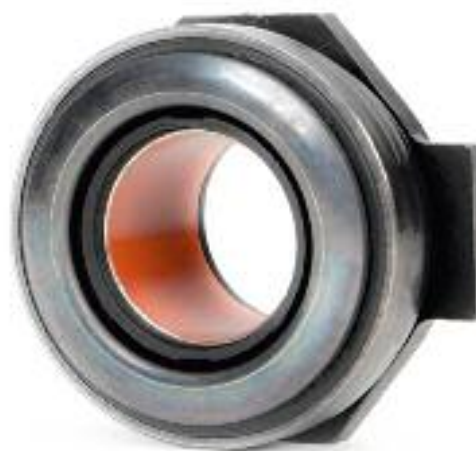
Fig. 3: Los cojinetes de desembrague con casquillo de PTFE no deben engrasarse con lubricante
