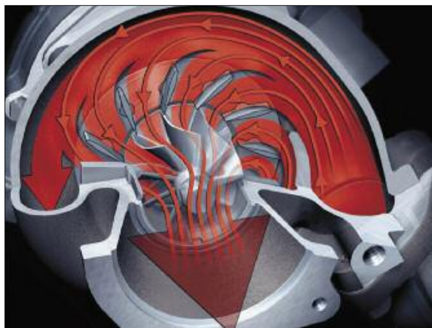
Esquema del rotor de la turbina, con álabes móviles en posición de alta velocidad.
