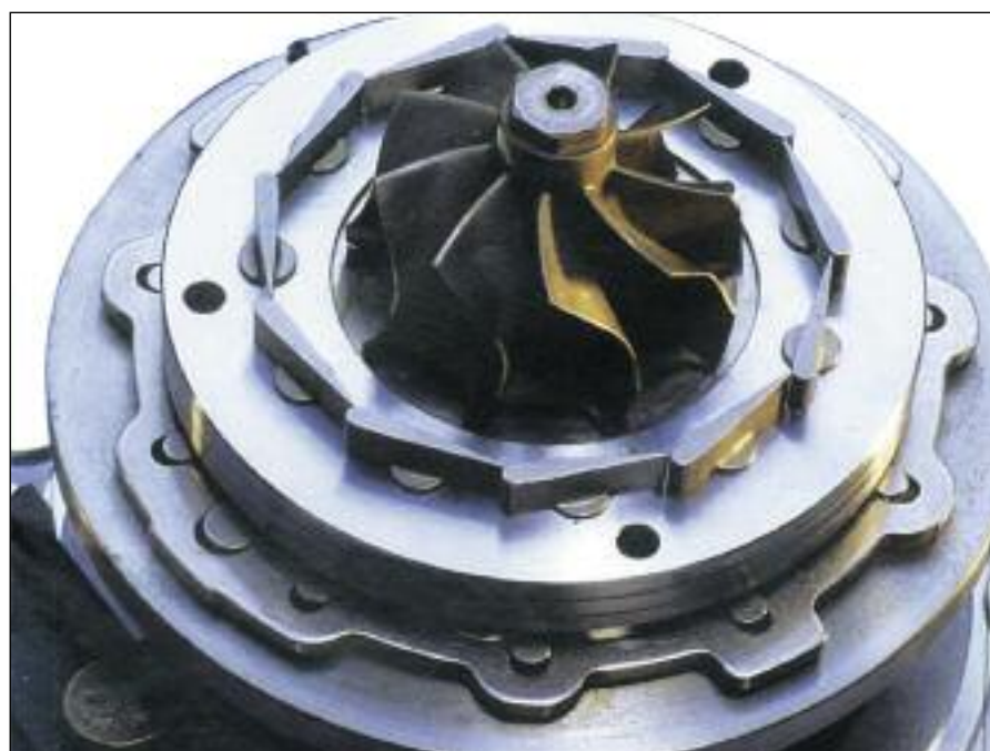
Rotor de la turbina con álabes móviles o regulables (TGV).
