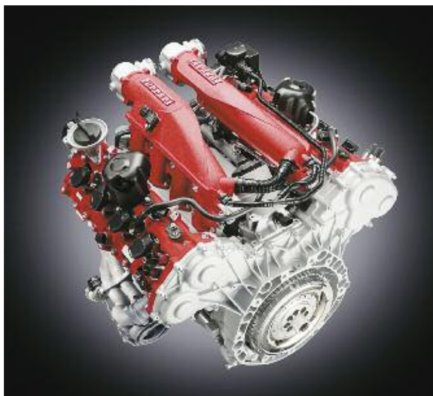
La Ferrari California T configura un motor V8 de 3,9 litros de cilindrada que tiene la peculiaridad que va sobrealimentado por dos turbocompresores de doble entrada (Twin-Scroll). En la actualidad, es la única Ferrari con motor sobrealimentado. Su potencia máxima es 560 CV.
