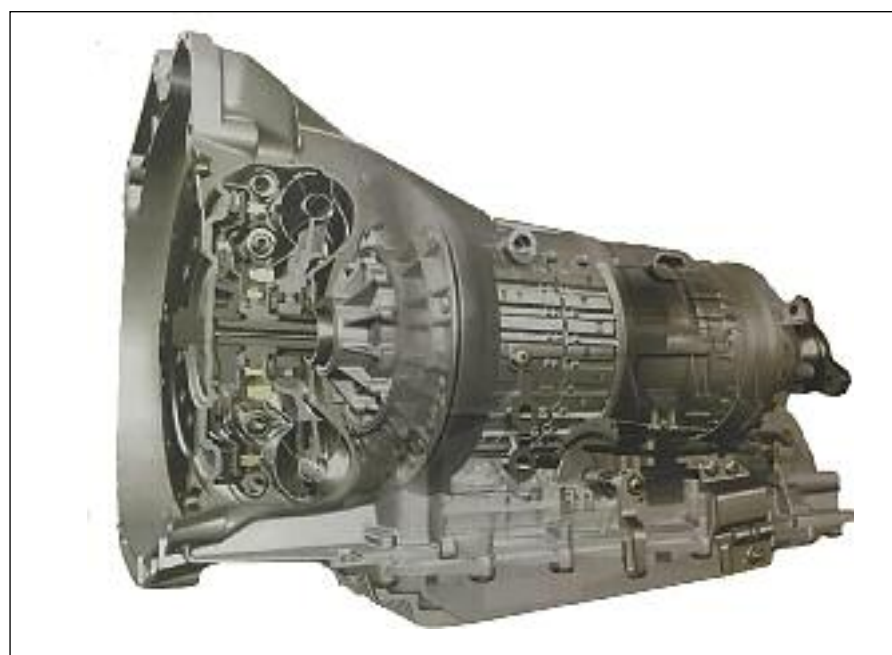
Nueva generación de cajas automáticas ZF 6 velocidades con convertidor de torque (nueva tecnología) y reducción del tiempo de pasaje de marchas (economía de consumo de combustible) manteniendo un alto nivel de confort. ZF.
