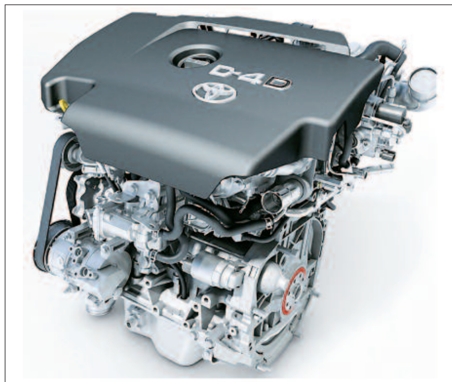
Uno de los motores precursores de la utilización del sistema HCCI de combustión homogénea, es el Toyota D4-D con recirculación de gases de escape EGR.
