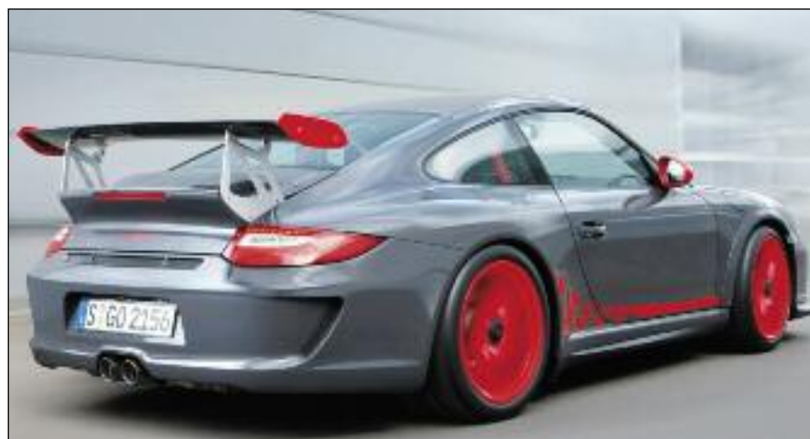
El Porsche 911 GT3 RS posee spoiler delantero y alerón fijo atrás, como resultado de estudios aerodinámicos.
