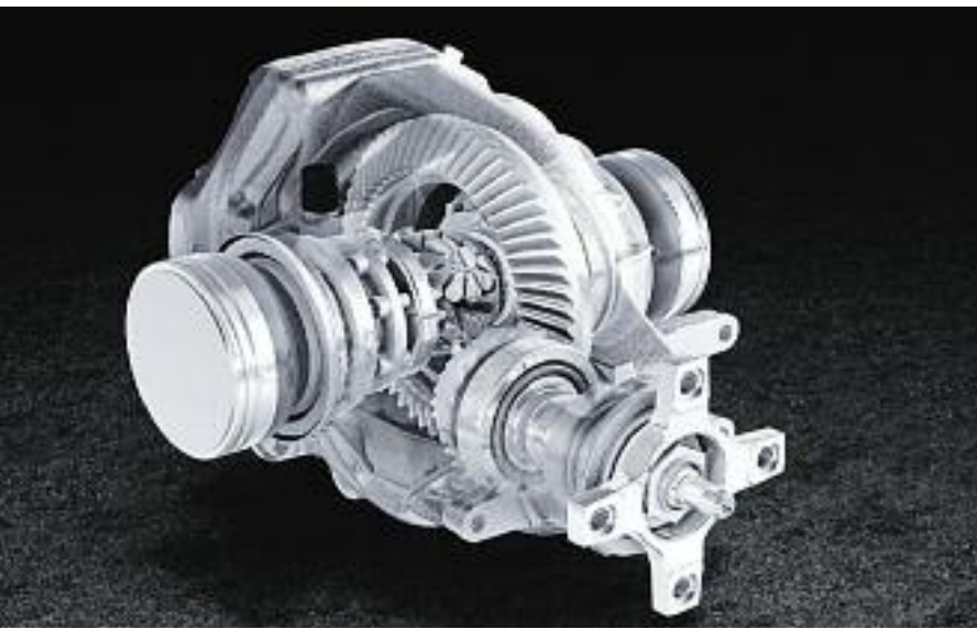
Diferencial autobloqueante cortado parcialmente, desarrollado por Mercedes Benz, para su modelo SL. 63 AMG.
