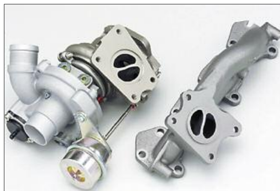
Detalle de los turbocompresores Twin Scroll de Ferrari.
