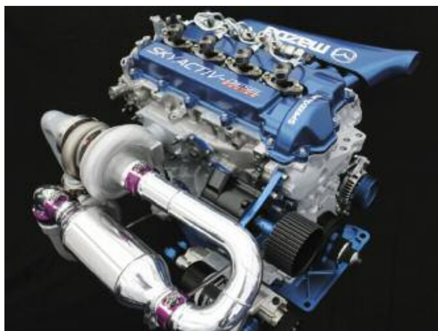
Motor de alto rendimiento de ciclo Diesel turbo -intercooler-. Mazda SkyActiv.
