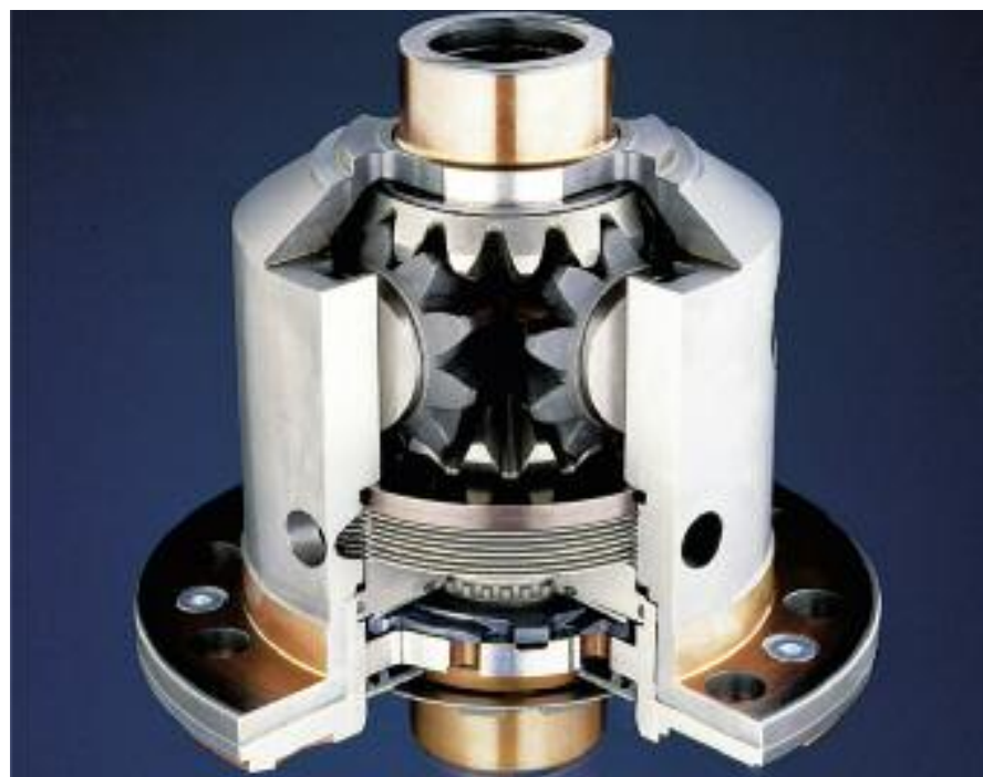
Diferencial autobloqueante o de deslizamiento controlado, en corte parcial - BMW.
