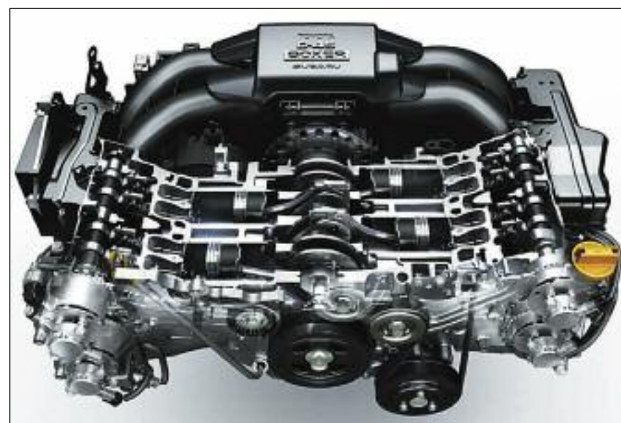
Corte parcial del motor 4 cilindros boxer.
