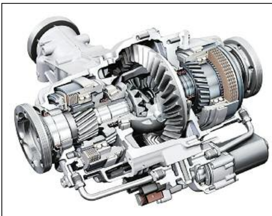
Corte parcial de un diferencial autobloqueante, de uso de tipo deportivo también denominado de "control de deslizamiento", y detalle de las placas de embrague con distribución del 60 y 40 por ciento, adelante y atrás respectivamente- Audi.
