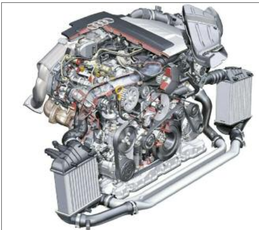
Diseño de motores en V, en este caso de 6 cilindros y 3.0 litros TDI. "Common rail".
