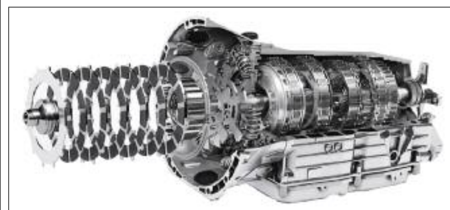
Caja de velocidades automática con embrague de discos múltiples, del tipo MCT (Multi Clutch Technology) - M. Benz.
