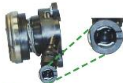
Fig. 11: Actuador con fuga, obstruido por no retirar O ring de la tubería de equipo original
