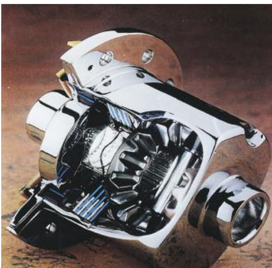
Un diferencial autobloqueante, que asegura un buen funcionamiento con adherencia limitada, y excelente estabilidad, es el conocido Hydra-Lok.
